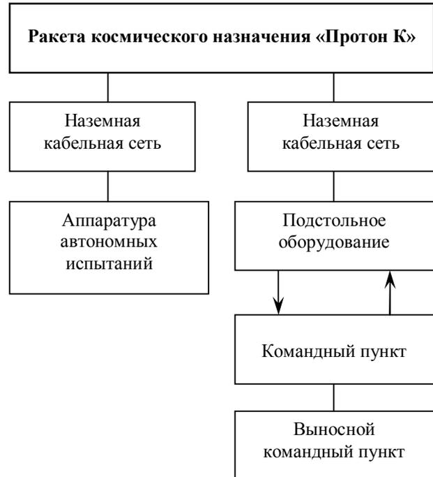
Рис. 2. Структура наземного проверочно-пускового оборудования ракеты «Протон К»
