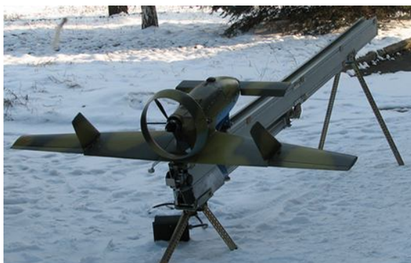
Рис. 1. Серийный образец пневматической катапульты с БЛА «Ремез-ЗУ» на стартовой позиции
