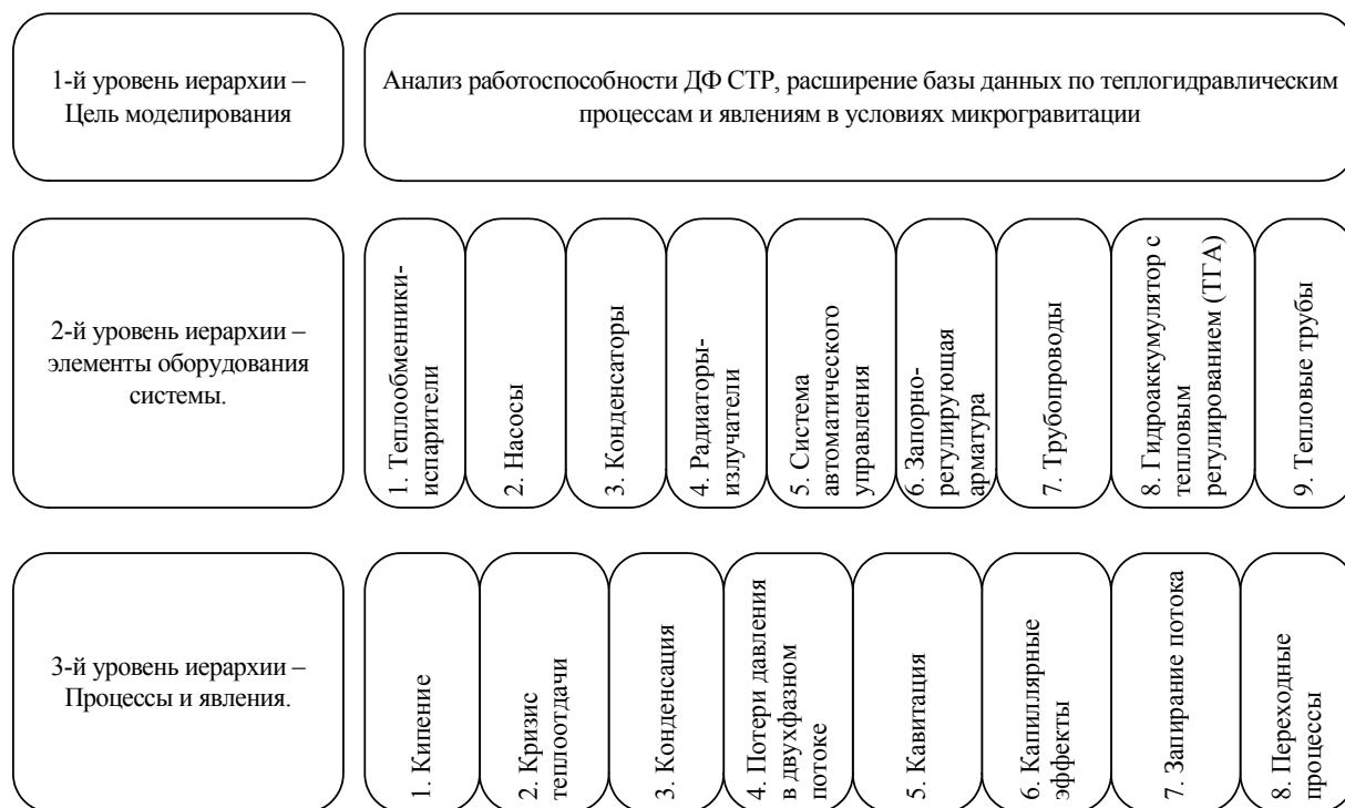
Рис. 1. Иерархическая структура задачи анализа работоспособности ДФ СТР в условиях микрогравитации
