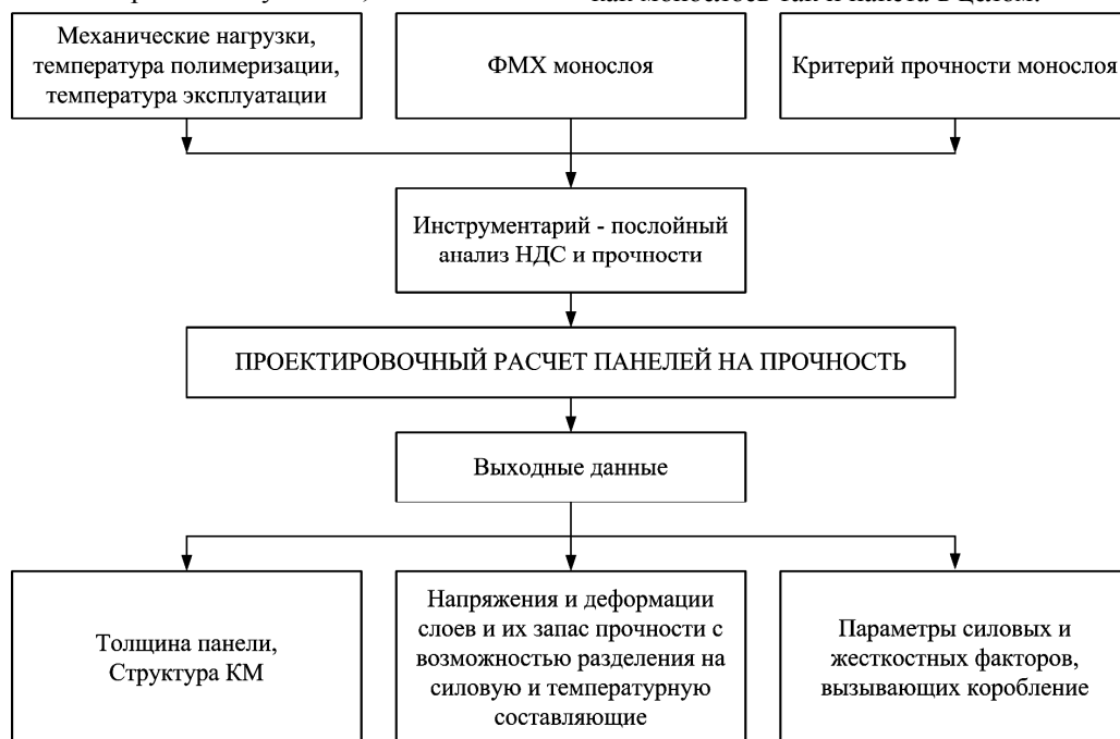
Рис. 5. Структура и содержание проекторочного расчета панели на прочность
