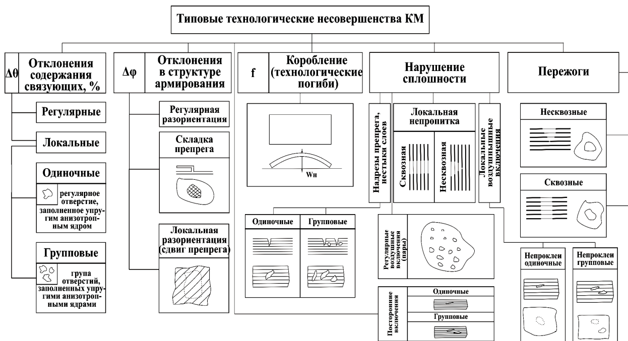
Рис. 1. Схема типовых технологических несовершенств полимерных КМ
