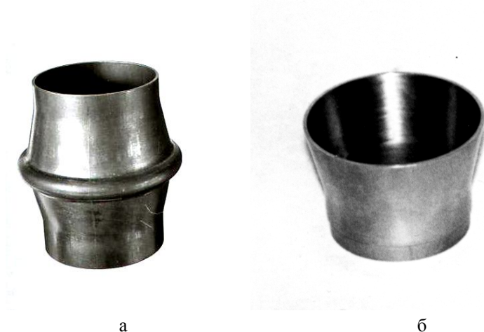
Рис. 2. Отштамповка и готовое изделие: а – отштамповка пары наконечников; б – конусный наконечник
