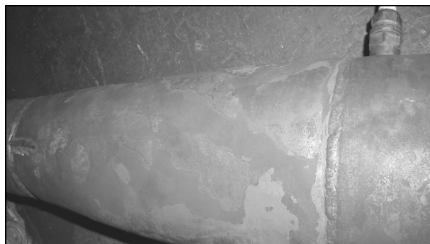
Рис. 12. Окалина на стенках камеры сгорания ПуВРД
