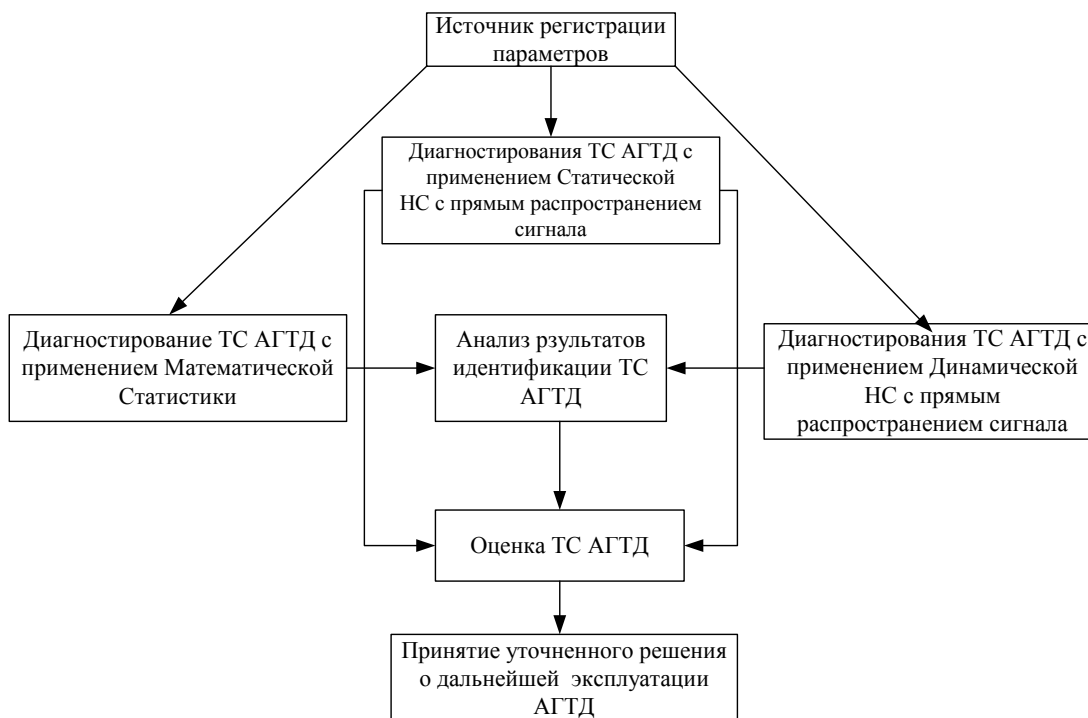
Рис. 2. Нейро-статическая подсистема диагностирования ТС АГТД ( M2 + M5 + КА )
