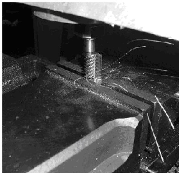
Рис. 4. Процесс обработки руля управления аэродинамической модели
