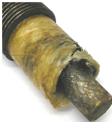
Рис. 3. Разрушение торца изолятора, характерное для вертикального расположения электрода
