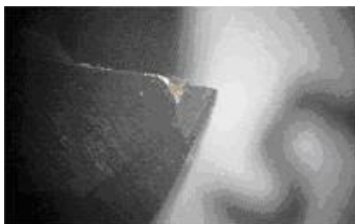
Рис. 6. Следы ударов фрезы по поверхности образца №4
