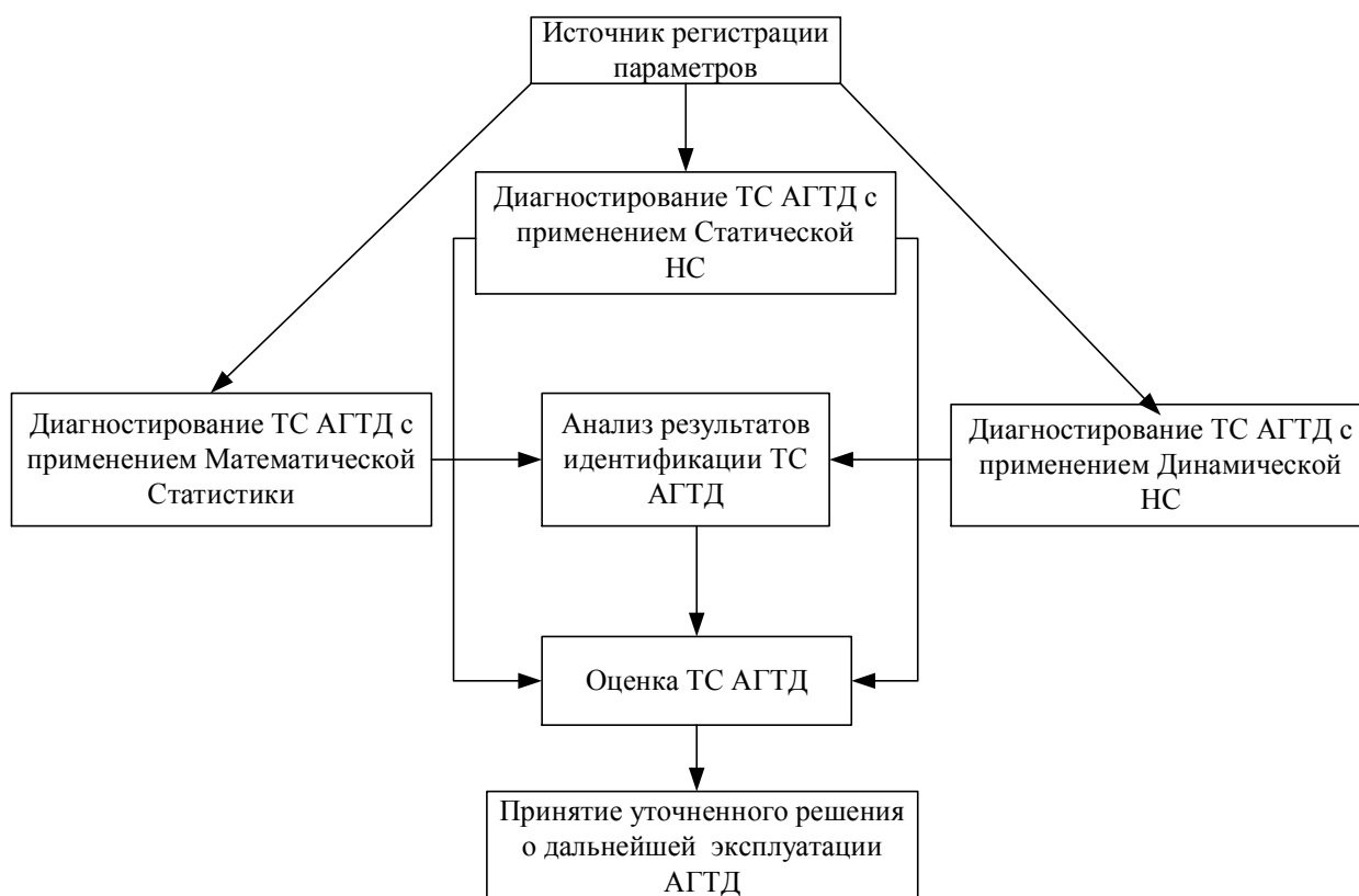
Рис. 1. Обобщенная схема комплексной системы диагностирования ТС АГТД
