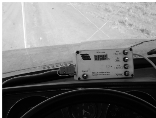
Рис. 9. Электронный блок буксировочной системы устанавливается на автомобиль
