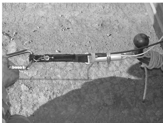
Рис. 8. Тензодатчик буксировочной системы устанавливается на автомобиль
