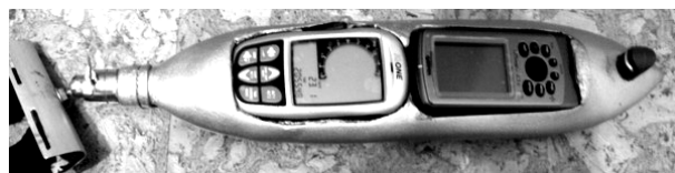
Рис. 6. Комбинация приборов – GPS Garmin 72 и комбинированный вариометр + высотомер + указатель скорости Brauniger IQ One в специальном вариобоксе
