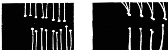
Рис. 1. Поведение подвешенных частиц в акустическом поле
