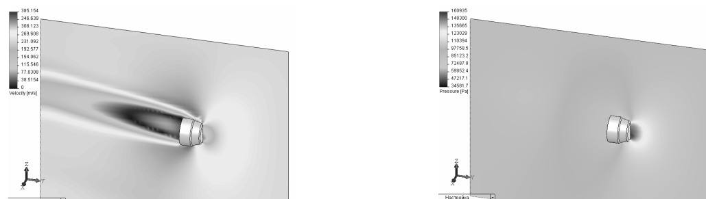
Рис. 5. Поля скоростей (слева) и давлений (справа) ОКС для угла атаки 10^\circ при V = 300 м/с
