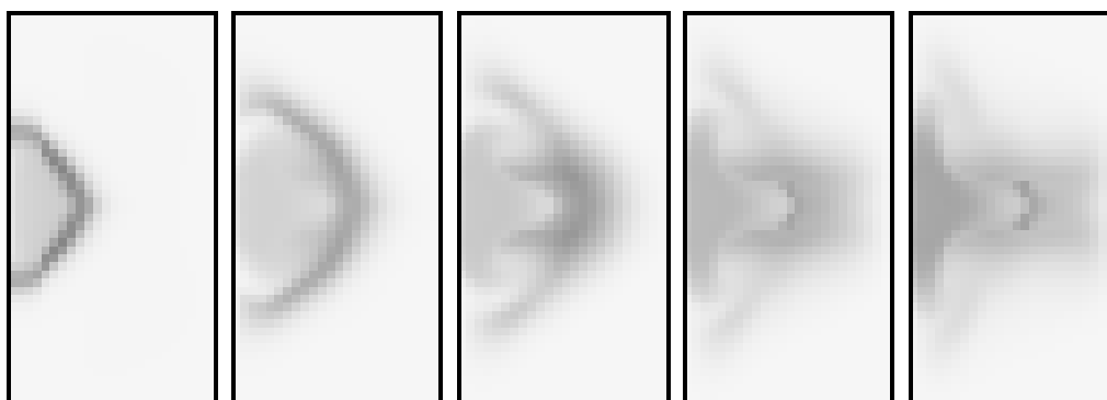
Рис. 7. Эволюция реактивной струи в момент времени от 0 до 0.055 с
