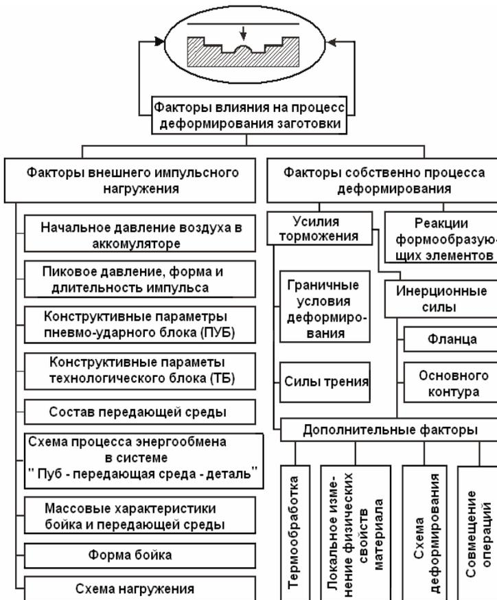
Рис. 2. Основные факторы, определяющие эффективность процесса формообразования ударной штамповки
