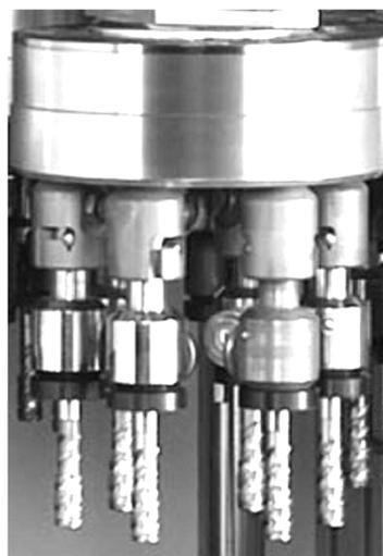
Рис. 2. Многошпиндельная обработка деталей в среде свободного абразива [7]
