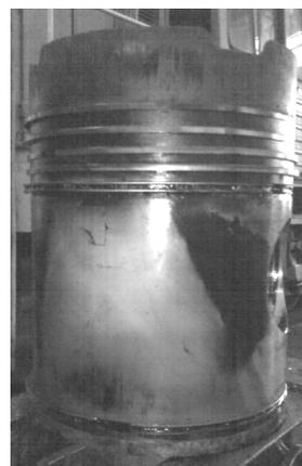
Рис. 1. Поршень с корундовым слоем после наработки 114676 моточасов
