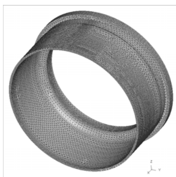
Рис. 4. Объёмная КЭ полноразмерная модель цилиндрической заготовки
