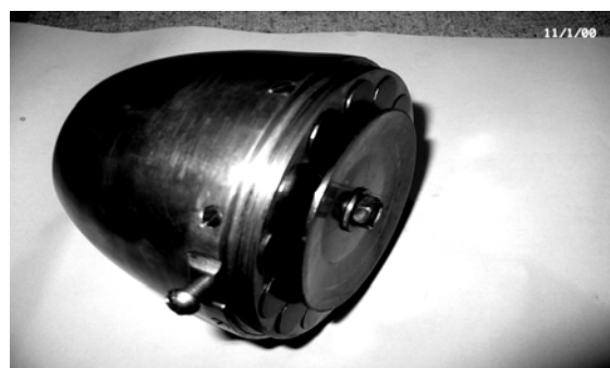
Рис. 1. Узел автоматического клапана ПуВРД
