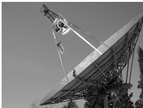
Рис. 1. Ресурсные испытания металлической тепловой защиты на установке СГУ-7
