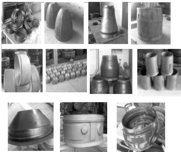
Рис. 2.. Детали, изготовленные методом штамповки взрывом
