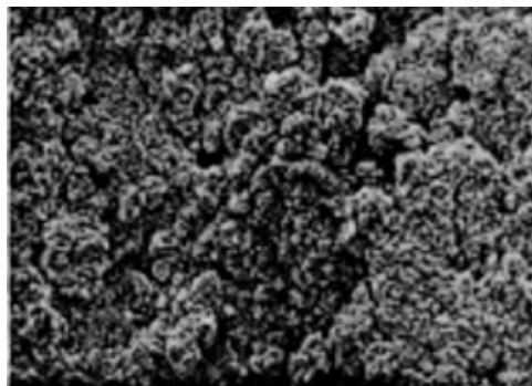
Рис. 1. Поверхность активной массы нового положительного электрода при увеличении 500 раз
