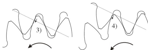
Рис. 7. Движение зубьев при выходе из зацепления:
