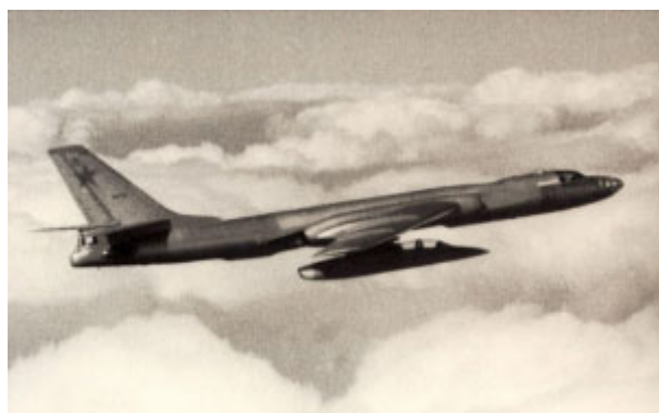
Рис. 4. Летающая лаборатория Ту-16ЛЛ с опытной силовой установкой самолета L-36 с двигателем ДВ-2
