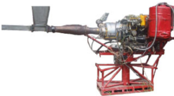
Рис. 10. Экспериментальная установка на базе двигателя ГТД-5
