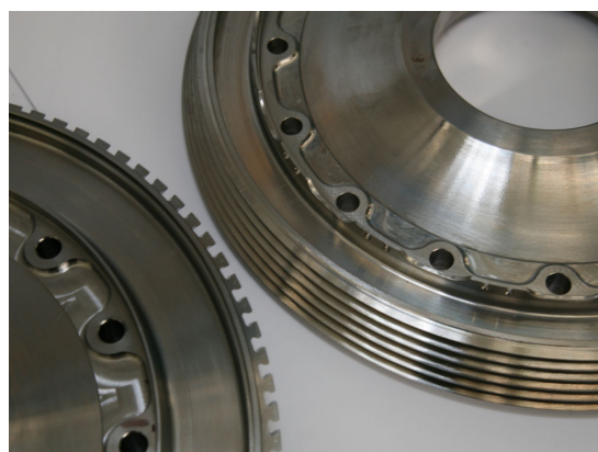
Рис. 8. Диски, обработанные фрезами из сплава AF K44 EF
