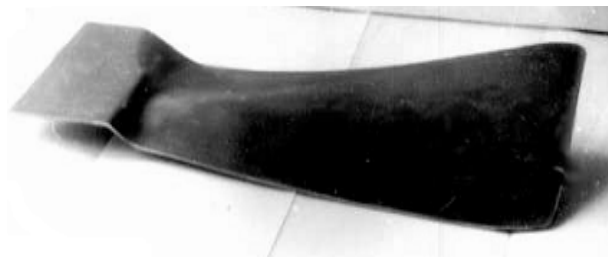
Рис. 4. Лопатка после термофиксации и отделения припуска
