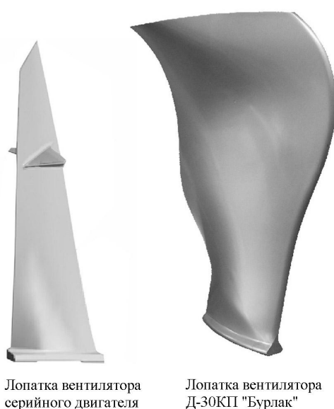
Рис. 3. Лопатки вентилятора серийного двигателя и Д-30КП «Бурлак»
