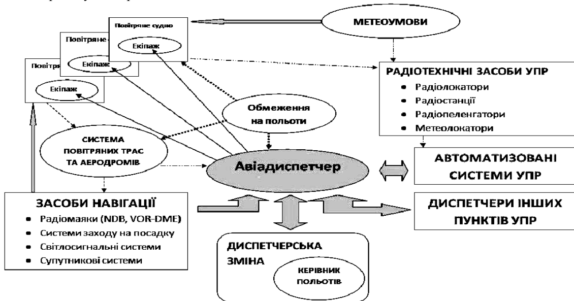
Рис. 1. Загальна схема найпростішого контуру управління повітряним рухом
