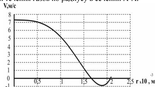
Рис. 4. Распределение осевой компоненты скорости течения газов в плазматроне при диаметре сливного отверстия d = 8 мм
