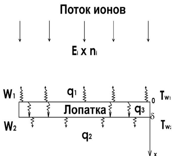
Рис. 3. Схема распространения теплового потока в лопатке: W_1, W_2 – поверхности лопатки; q_1, q_2 – тепловой поток, излучаемый с поверхности W_1 и W_2 соответственно; q_3 – тепловой поток, проходящий через лопатку толщиной \delta ; T_{w1}, T_{w2} – температуры поверхностей W_1 и W_2 соответственно
