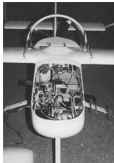
Рис. 3. Компоновка САДУ ДПЛА «Альбатрос»
