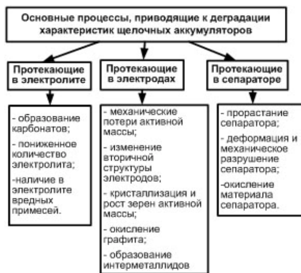
Рис. 1. Деградационные процессы, приводящие к истечению ресурса АК
