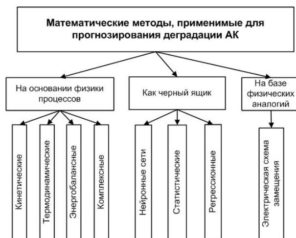
Рис. 3. Методы прогнозирования деградации электрохимических аккумуляторов
