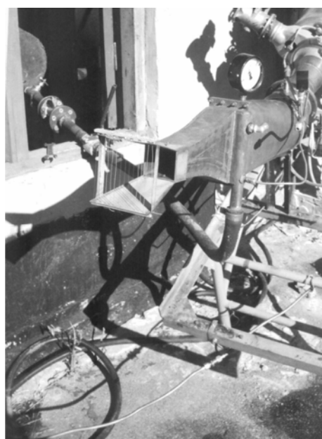
Рис. 4. Двухфазное сопло со струнным диспергатором
