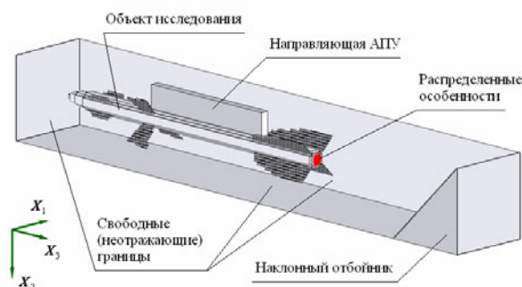
Рис. 1. КО с маской в сеточной области, отображающей наружную поверхность объекта исследования
