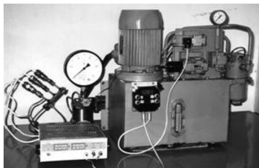
Рис. 1. Стенд циклического нагружения датчиков давления
