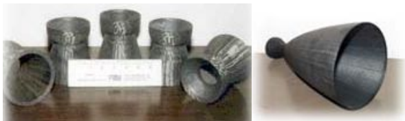
Рис. 1. Сопловые вставки с плетеной структурой АК
