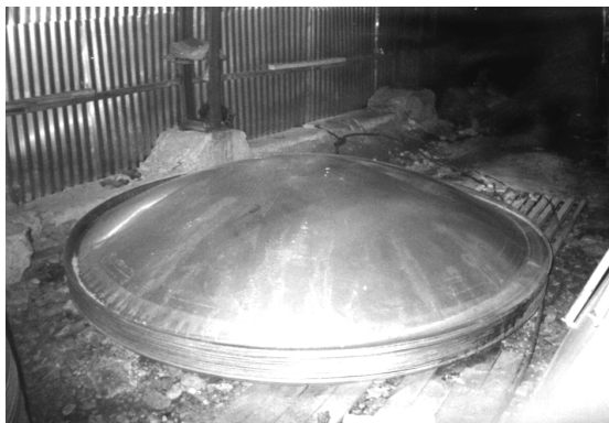
Рис. 2. Изготовленные параболические антенны диаметром 2,5 метра
