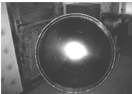
Рис. 3. Деталь, отштампованная из сварной заготовки, сталь 08кп
