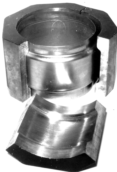
Рис. 5. Готовая деталь в разрезной матрице, состоящей из четырех формующих элементов
