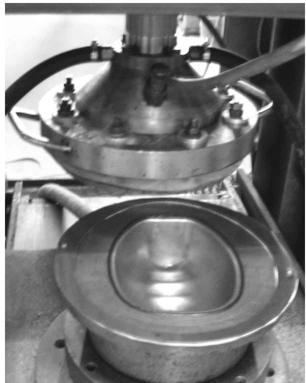
Рис. 1. Коническая разрядная камера и штамповая оснастка, размещенные в технологическом блоке установки УЭГШ-2
