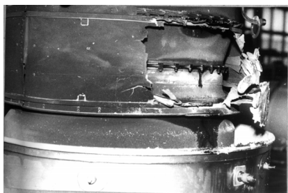
Рис. 5. Прогар и оплавление нижней половины кожуха турбины
