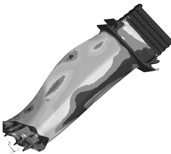
Рис. 6. Форма колебаний с наложенными полями распределений интенсивности напряжений (преимущественно изгибно-крутильные колебания)
