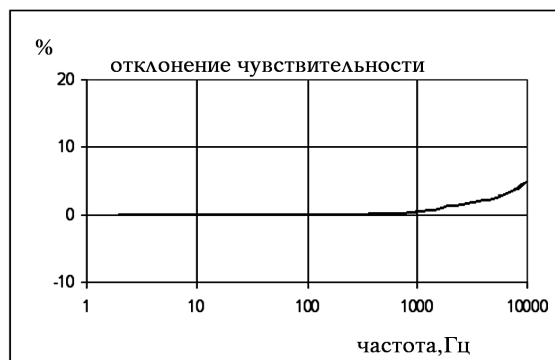
Рис. 2. Температурная и частотная характеристика датчика СР235
