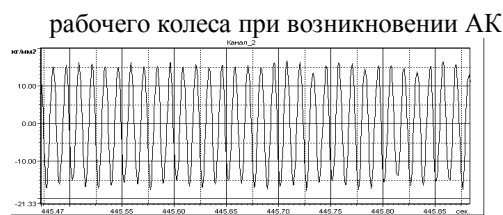
Рис. 2. Тензограмма сигнала на одной из лопаток рабочего колеса в момент возникновения АК
