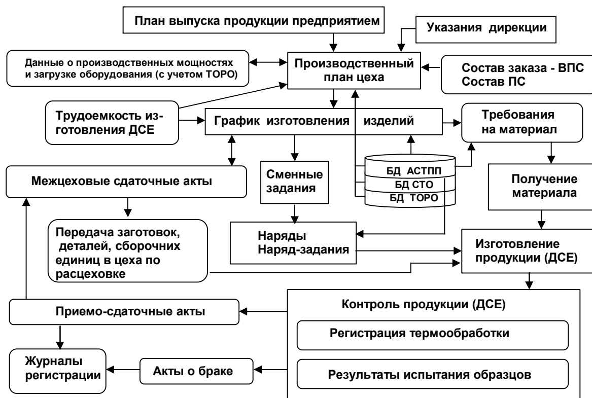
Рис. 1. Функциональная модель управления цехом
