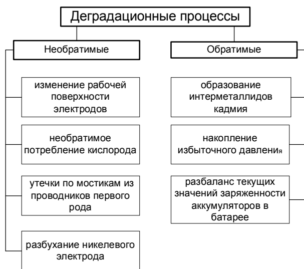
Рис. 4. Деграционные процессы в аккумуляторах
