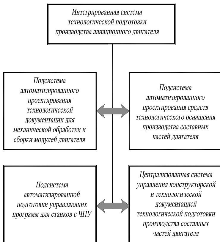
Рис. 1. Структурная схема комплексной интегрированной системы ТПП авиационного двигателя
