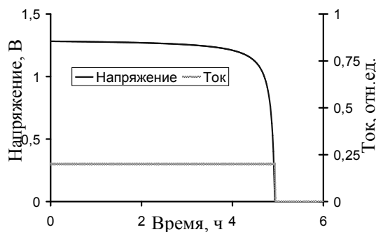
Рис. 2. Разрядная характеристика НКТ АК и зависимость тока от времени при разряде постоянным стабилизированным током
