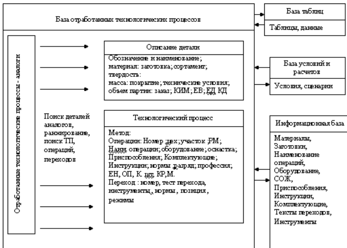
Рис. 1. Схема построения технологического процесса методом адресации
