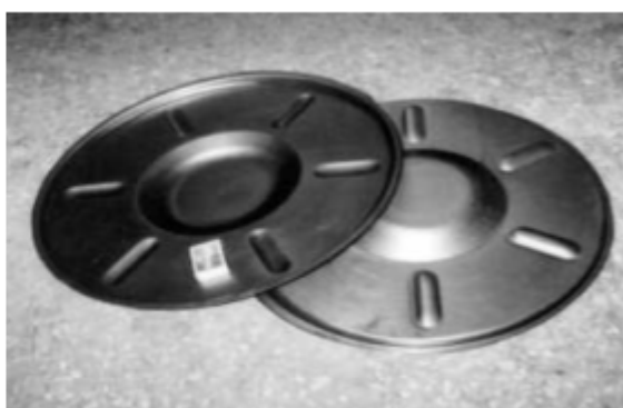
Рис. 4. Опытная оснастка для изготовления и рельефные детали
