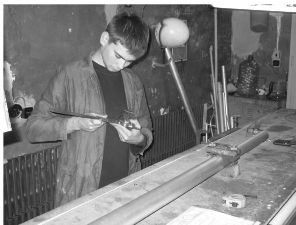
Рис. 9. Дельтапланерист Григоренко Сергей осуществляет замер узлов крепления
