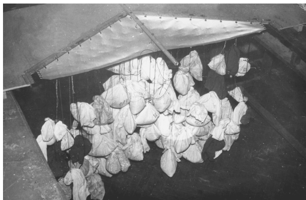
Рис. 5. Первые статические испытания гибкого крыла
