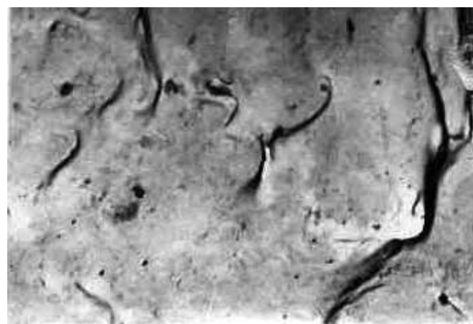
Рис. 1. Микрофрактограмма усталостного излома образца с детонационным напылением – 4000х
