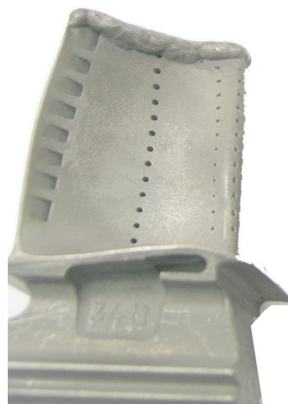
Рис. 4. Наплавленный торец пера рабочей лопатки ТВД изд. Д27
