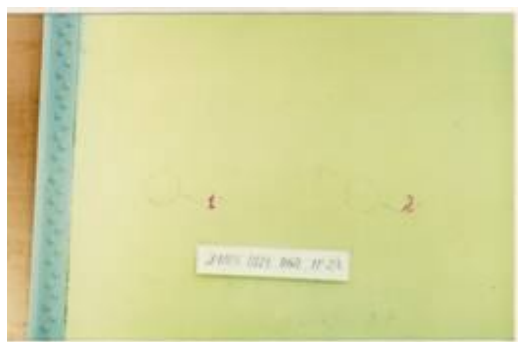
Рис. 1. Панель 2А после испытаний на молниестойкость (наружная сторона слева, внутренняя сторона – справа)
