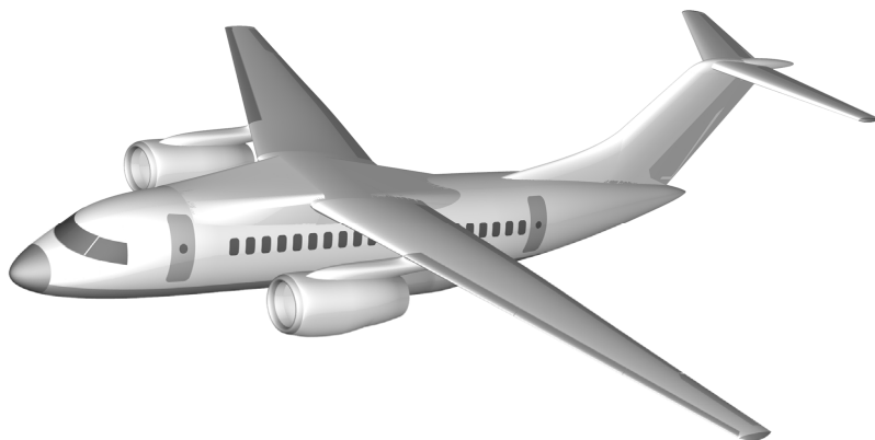
Рис. 2. Мастер-геометрия (модели поверхностей) самолетов, созданных при помощи системы CAD\CAM\CAE UNIGRAPHICS: а – Ан-140; б – Ан-74TK-300; в – Ан-148
