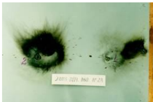
Рис. 1. Панель 2А после испытаний на молниестойкость (наружная сторона слева, внутренняя сторона – справа)
