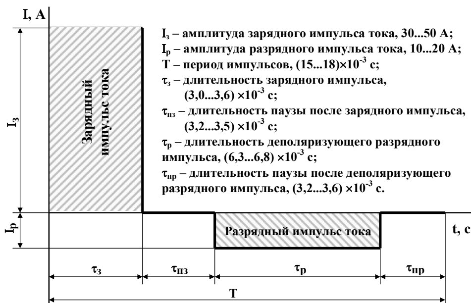
Рис. 5. Форма ассиметричных импульсов при восстановлении емкости аккумуляторов
