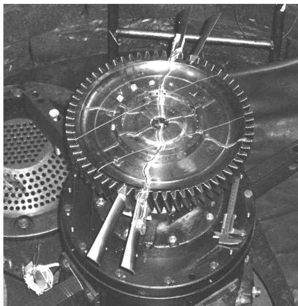
Рис. 2. Рабочее колесо ГТД с двумя ослабленными лопатками и элементами устройства обрыва и двумя штатными лопатками перед испытаниями
