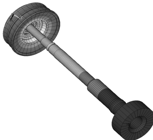
Рис. 7. Преимущественно зонтичные колебания дисковой системы, связанные с преимущественно продольными колебаниями вала, f = 280 Гц
