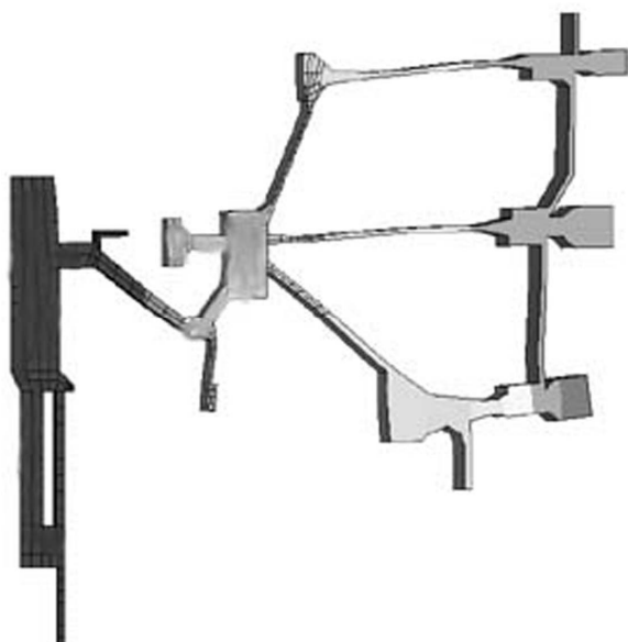
Рис. 3. Преимущественно зонтичные синфазные колебания, f = 346 Гц
