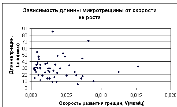
Рис. 1. Зависимость длины микротрещин от скорости их развития
