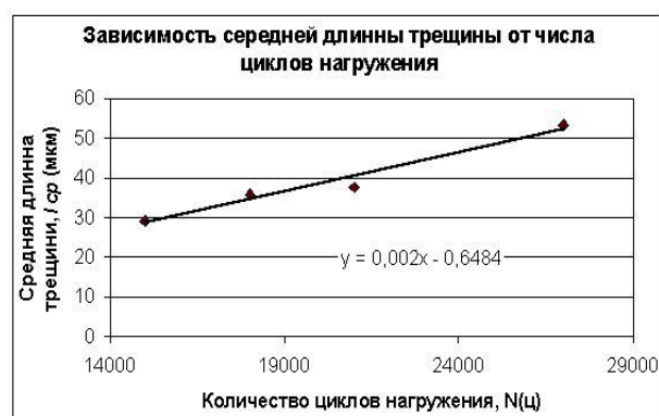
Рис. 3. Зависимость плотности трещин от количества циклов нагружения
