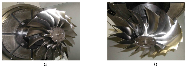
Рис. 11. Осевое моноколесо с широкохордными лопатками после чистового фрезерования: а – вид с торца моноколеса; б – вид на ступицу моноколеса в межлопаточном пространстве со стороны торцов широкохордных лопаток
