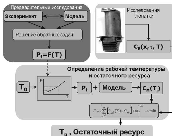
Рис. 2. Схема метода для определения остаточного ресурса и средней рабочей температуры защитных покрытий лопаток газовых турбин
