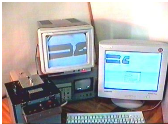
Рис. 2. Внешний вид экспериментальной системы контроля параметров формы торцов и позиционирования оптических волокон при сварке
