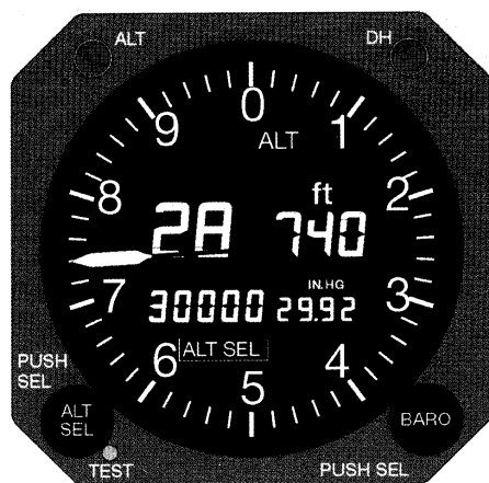
Рис. 3. Лицевая панель барометрического высотомера
