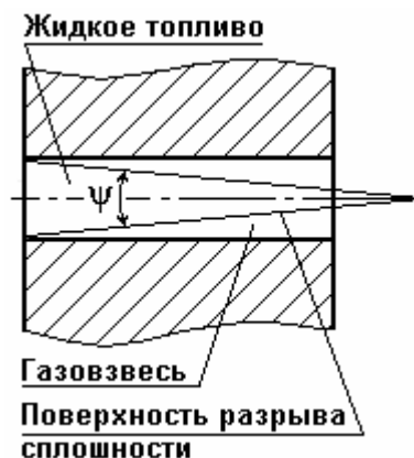
Рис. 3. Схема распада топливной струи в сопловом канале форсунки
