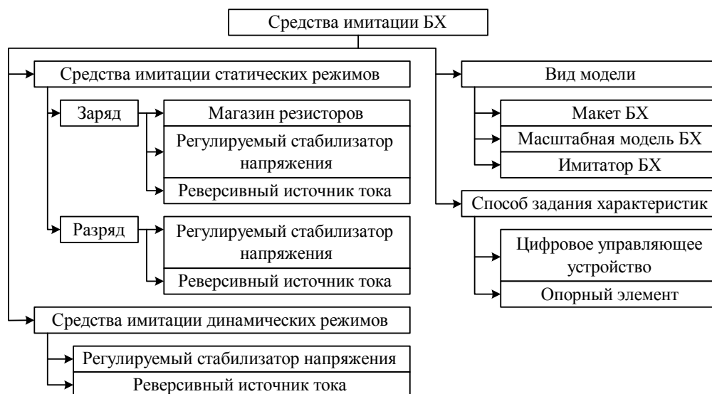
Рис. 1. Классификация средств физического моделирования химических аккумуляторных батарей
