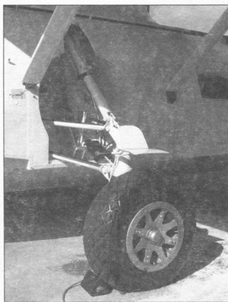
Левая основная опора колёсного шасси амфибии PBY-5A в выпущенном положении
