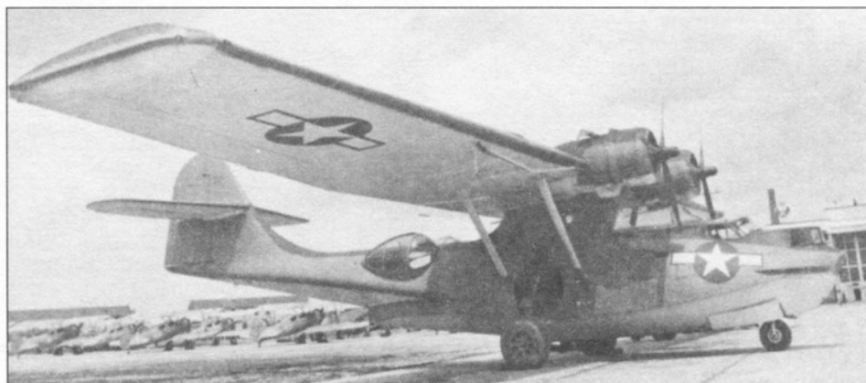
Амфибия РВУ-5А на базе в Нью-Орлеане, 1944 г. Самолёт оснащён РЛС с антеннами на крыле и пламегасителями на выхлопных патрубках моторов
