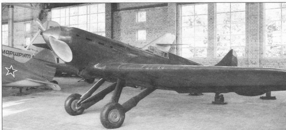
Опытный истребитель И-17, оснащённый двигателем водяного охлаждения
