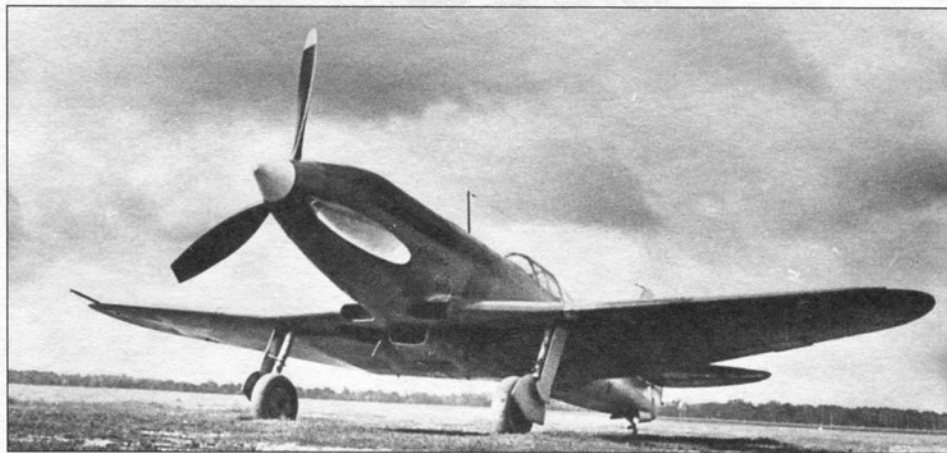
И-230 (он же МиГ-3У или самолёт «Д») с мотором АМ-35А с синхронными пушками ШВАК
