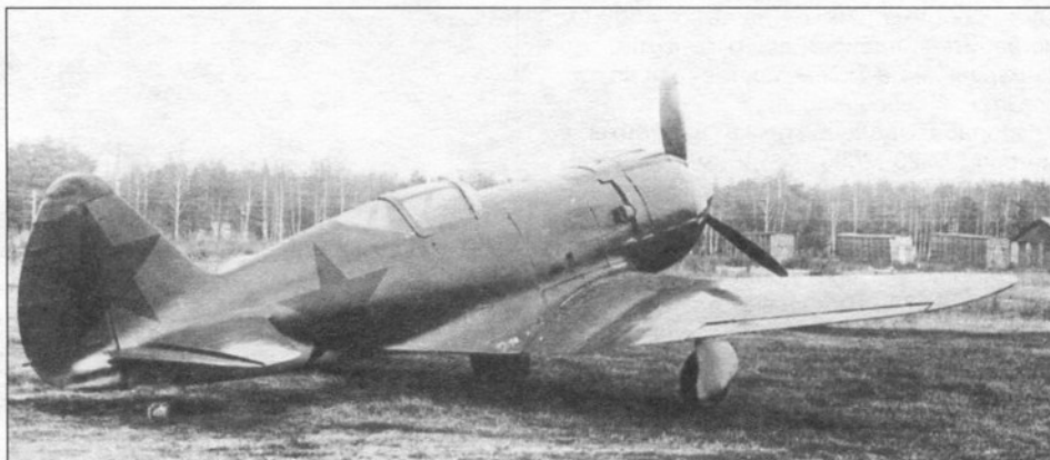
И-210 (МиГ-9) с мотором М-82, осень 1941 г.
