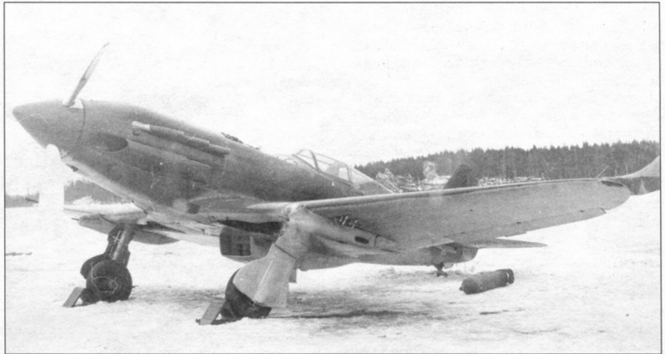
МиГ-3 с пулемётами БК в крыле и ухватами для авиабомб
