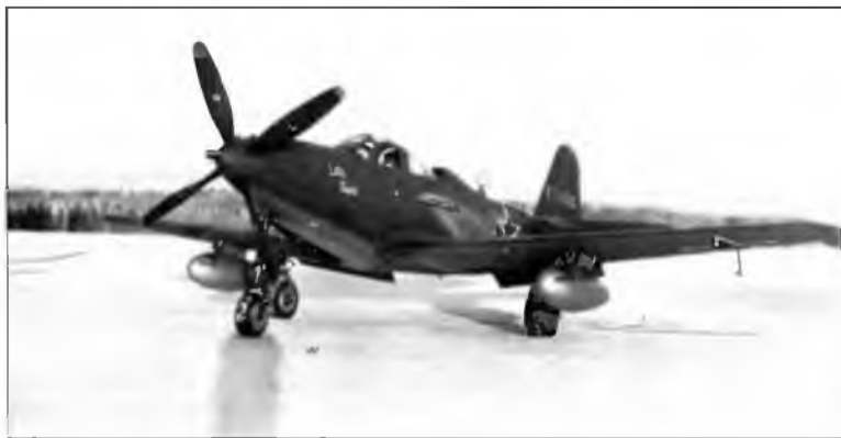
Подготовленная к перегонке в СССР «Кингкобра» с подвесными топливными баками
