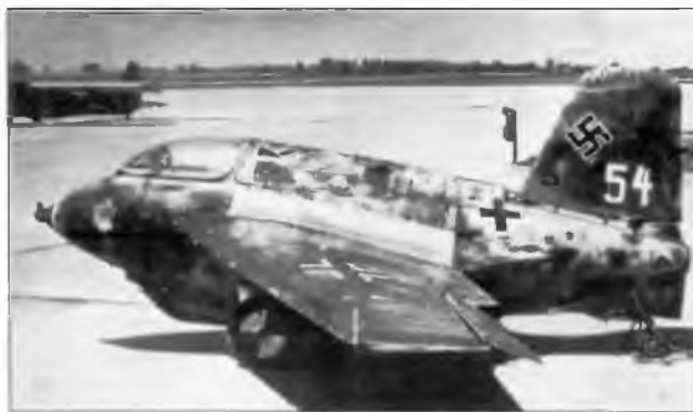
Характерной чертой Me 163 стала аэродинамическая схема «бесхвостка»
