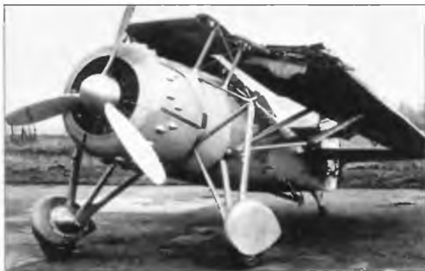
Палубный истребитель Девуатин D.376 со сложенными крыльями
