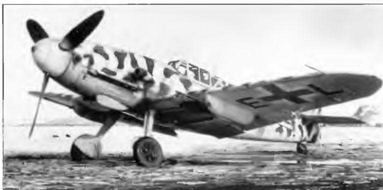
Мессершмитт Bf 109G-2/R6 из эскадры JG5 «Eismeer» на финском аэродроме. Видны характерные для модификации Bf 109G-2/R6 подкрыльевые 20-мм авиапушки MG 151/20
