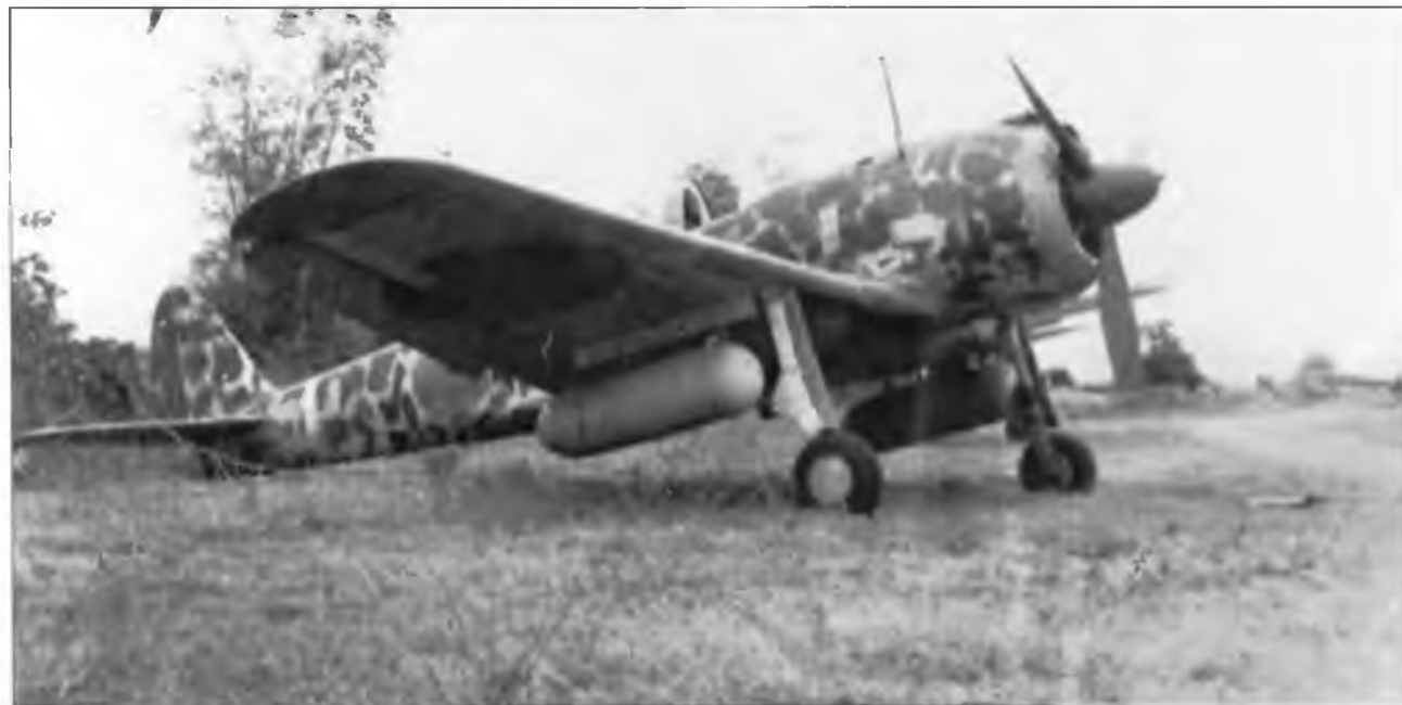
Ки-43 IIB с ПТБ на подкрыльевых держателях
