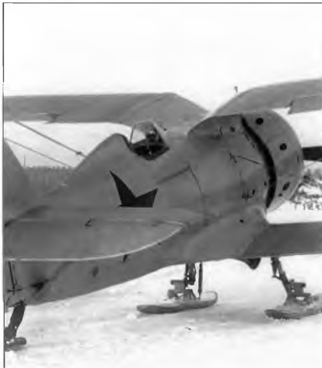
В зимнее время И-153, как и большинство советских самолетов, эксплуатировался на лыжах
