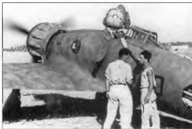
«Макки» MC.200 1-го стормо. Самолет принадлежит к ранним сериям (с полностью закрытой кабиной). Трапани, август 1940 г.
