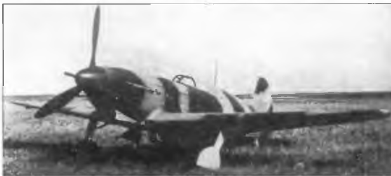
Як-7-37 вооруженный 37-мм пушкой Шпитального
