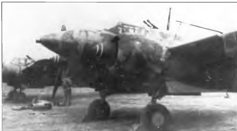
Ки-45 Каи в варианте ночного истребителя с дополнительными 20-мм пушками в фюзеляже
