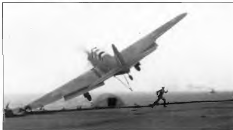
Уход на второй заход - этот «Фулмар» из 807-й эскадрильи проскочил аэрофинишеры и вынужден экстренно уходить на второй круг. Авианосец «Арк Роял»
