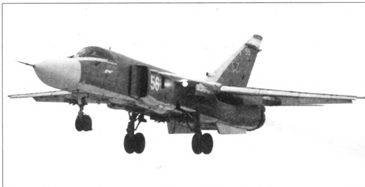
Зажженные на самолете фары служат для отпугивания птиц на взлете и посадке
