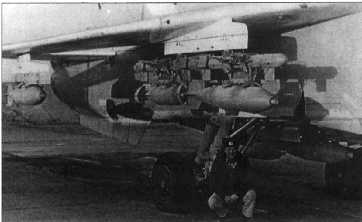
Подвеска бомб ФАБ-250М62 и ОФАБ-250-270 на многозамковых держателях
