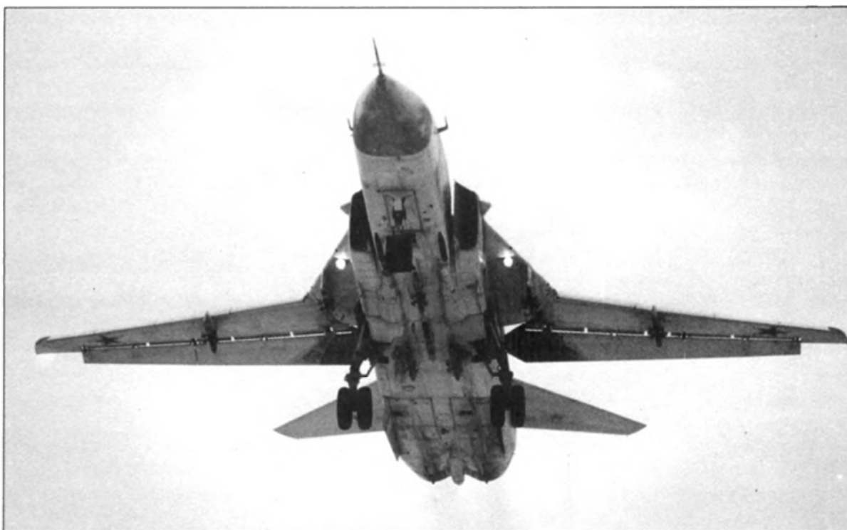
Закрылки и предкрылки бомбардировщика выпущены в посадочное положение
