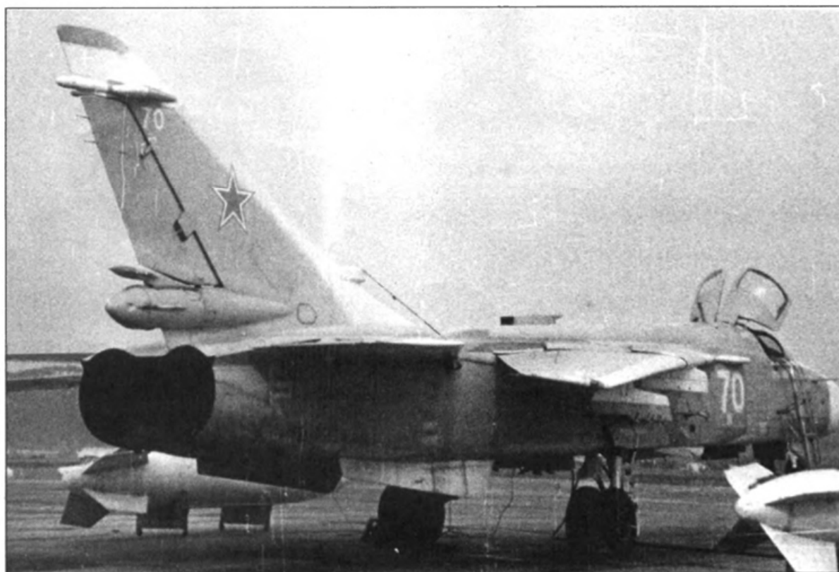
На земле крыло складывали в положении 72°, чтобы не повредить его о препятствия при рулении
