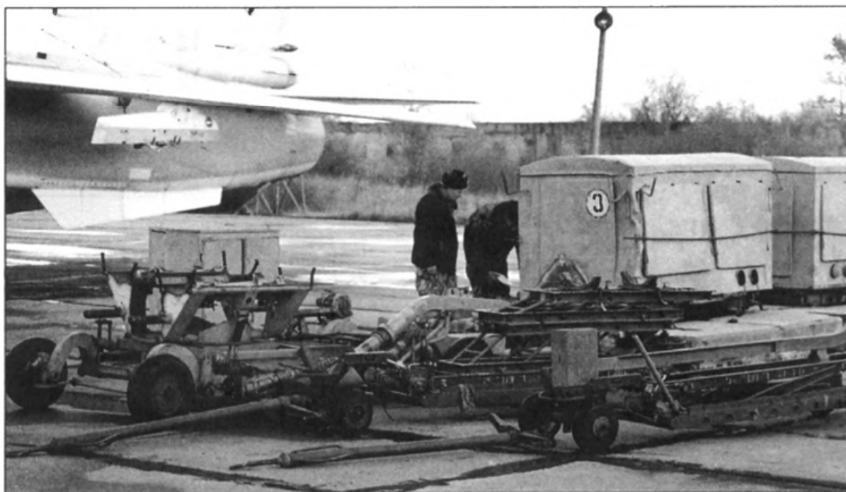
Тележки и подъемники для подвеса боеприпасов на самолет
