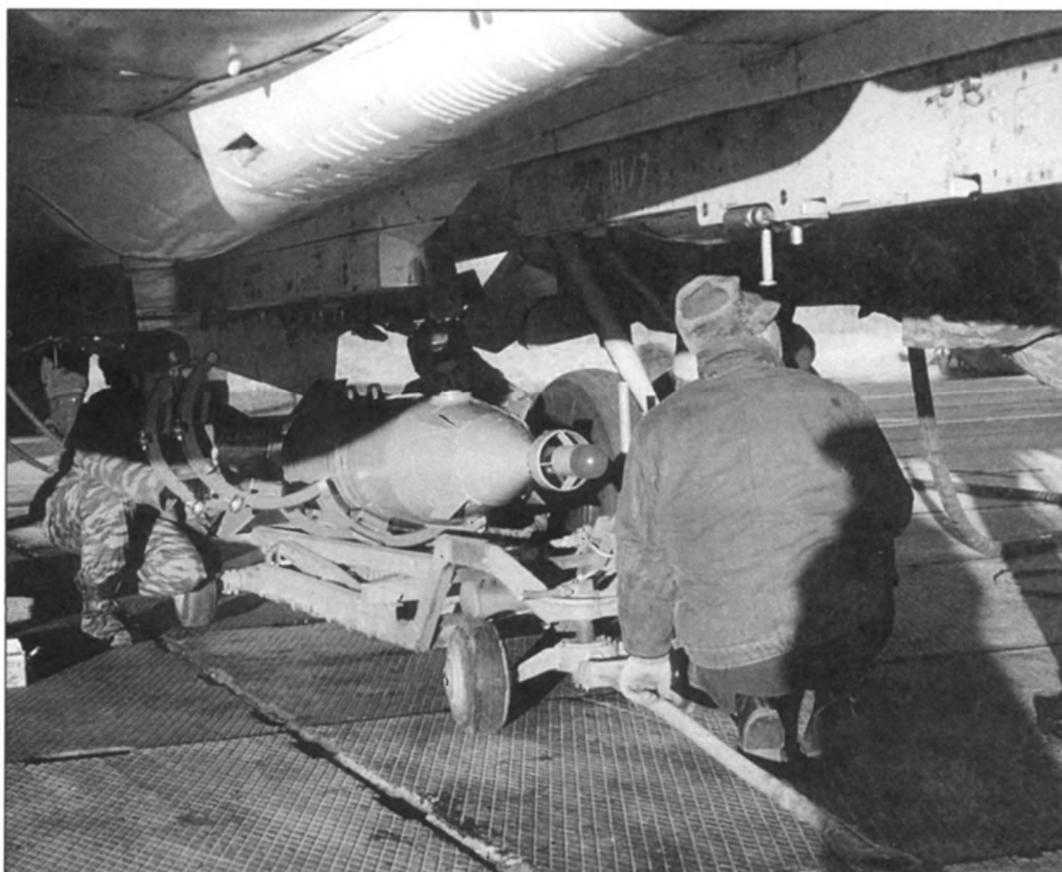
Подвеска под самолет бомбы КАБ-500 с лазерным наведением
