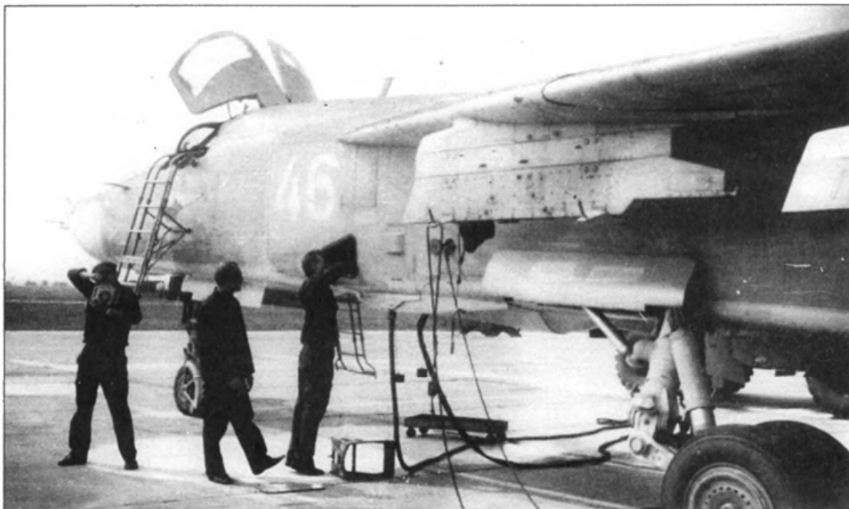
Группа объективного контроля снимает с самолета фотоаппарат АФА-39
