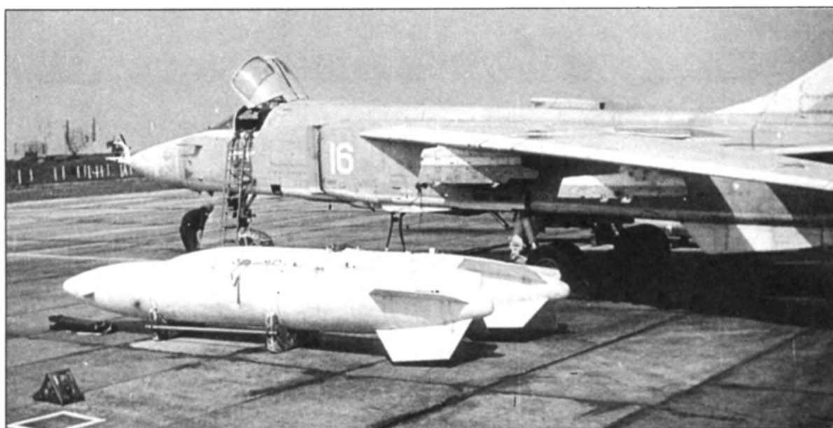
Подготовленные к подвеске баки ПТБ-3000
