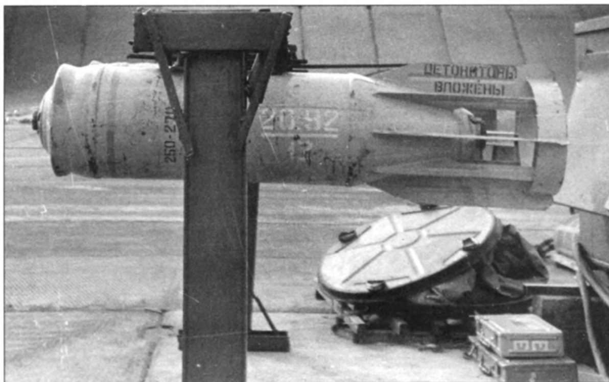
ОФАБ-250-270 на подготовительном мостике, использовавшемся для быстрой погрузки на тележки
