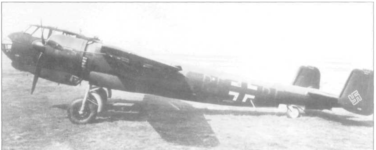
Do 217E-4 (W.Nr 4381). Щитки, закрывающие хвостовое колесо в полете, сняты. Обозначение RF+RE - заводское
