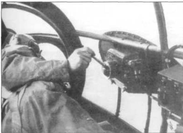
Штурман-бомбардир внутри кабины бомбардировщика He 111 наводит радиоуправляемую бомбу на цель при помощи рукоятки на передатчике. На самолетах Do 217 устанавливалось такое же оборудование
