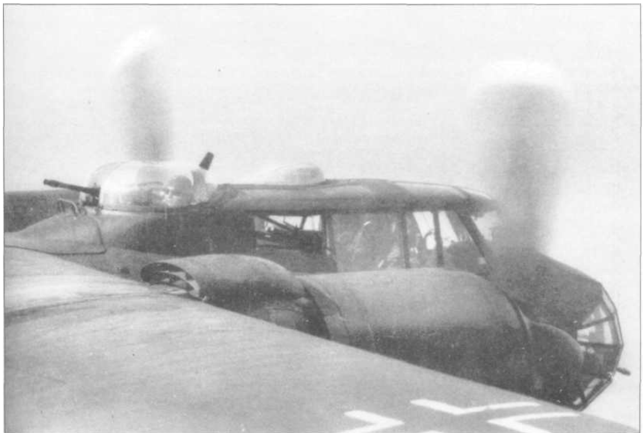
Ночной бомбардировщик Do 217E-2/4 в полете. Хорошо виден пламегаситель сверху мотогондолы
