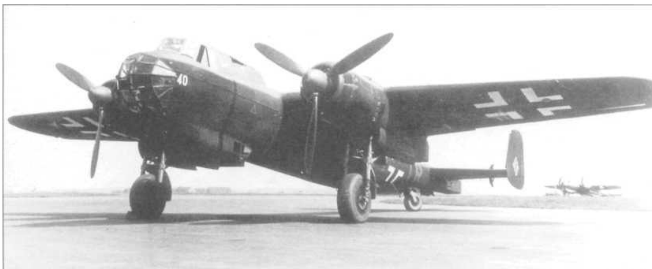
Do 217E-2 с хвостовым воздушным тормозом в «ночной» окраске (черный низ). Бортовые обозначения больше похожи заводские, чем на коды боевой части.
