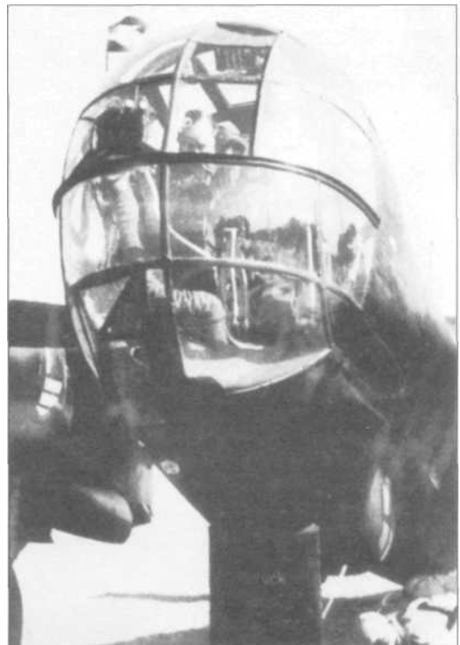
Носовая часть Do 217K имела обширное остекление
