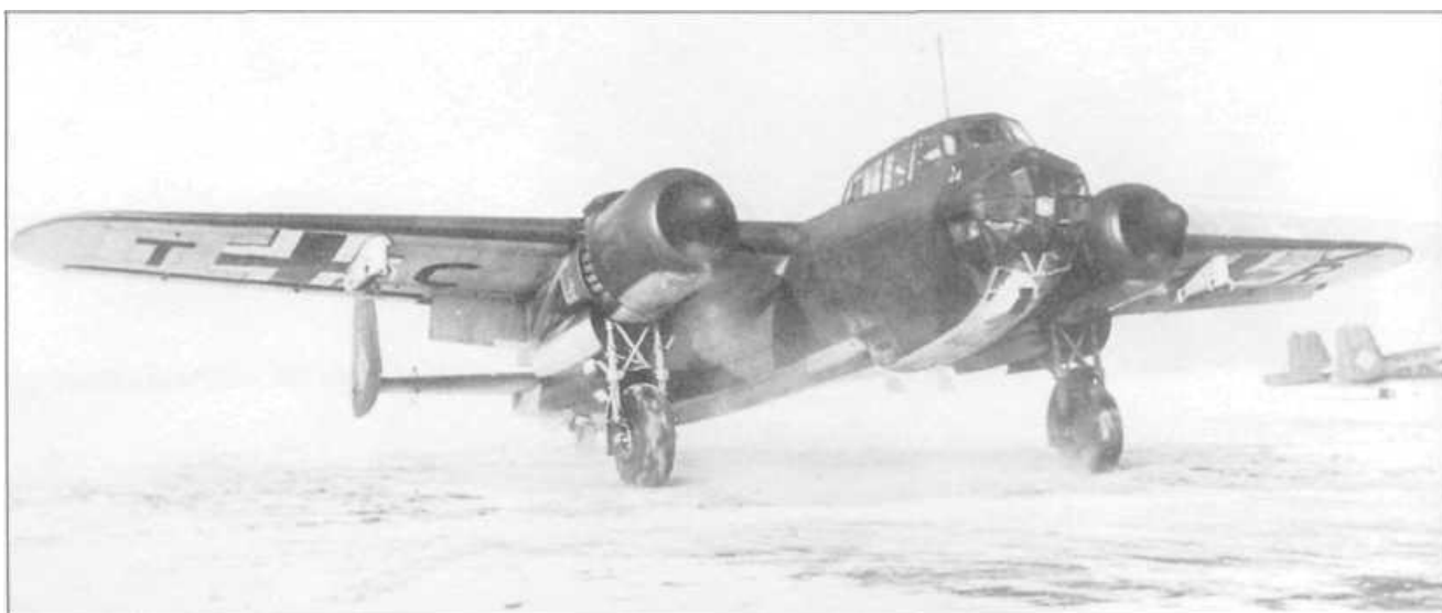
На этом Do 217E-3/R2 (W.Nr. 1044) с бортовым обозначением TC+KR установлены подкрыльевые держатели для 250-кг бомб SC 250.
