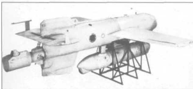
Радиоуправляемая планирующая бомба - Hs 293A
