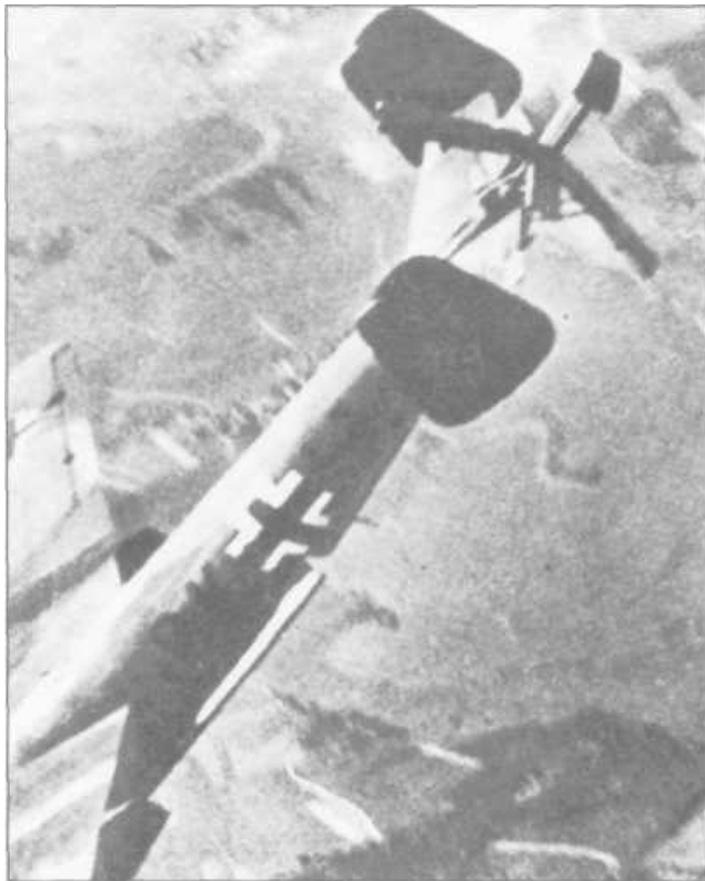
Раскрытый хвостовой воздушный тормоз во время пикирования Оо 217
