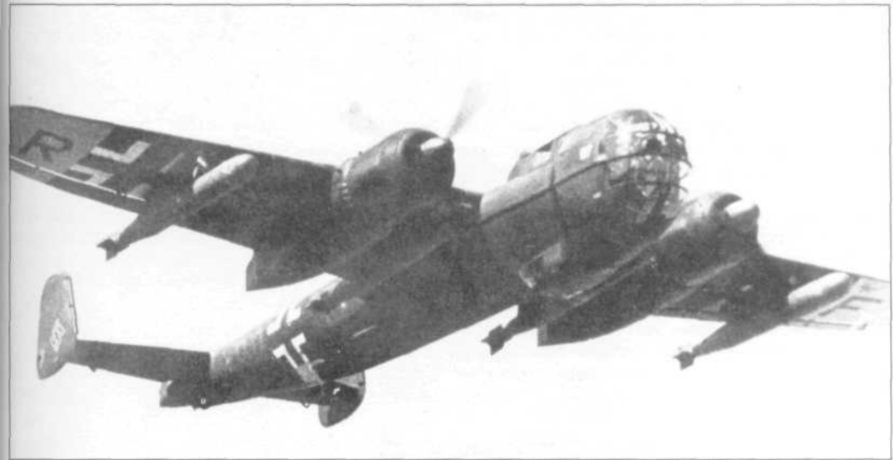
Do 217K с четырьмя торпедами F5 под крылом. Но в боевых условиях такая подвеска практически не применялась.
