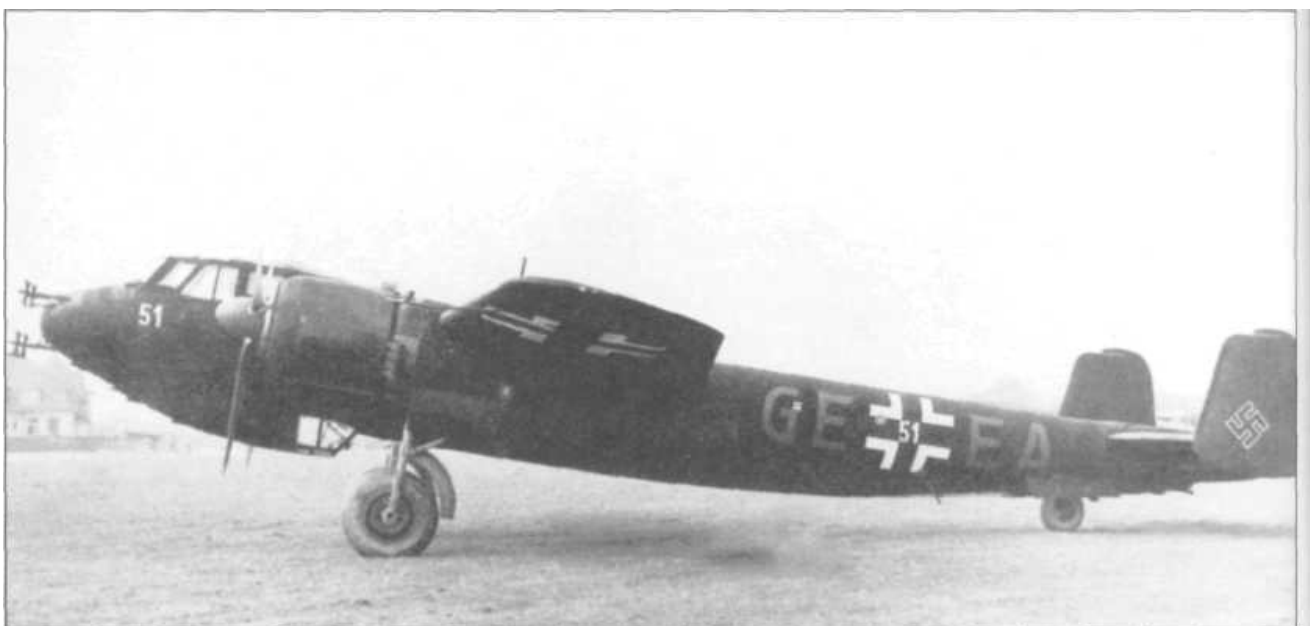
Ночной истребитель Do 217J-2 (W.Nr. 1351) с радиолокатором FuG 202. Самолет полностью окрашен в черный цвет. Германия, 1942 год.
