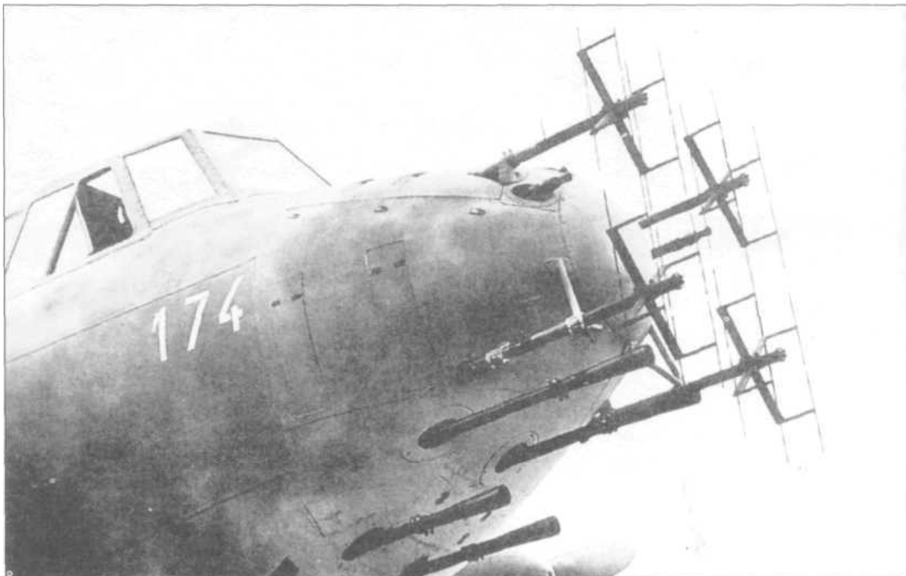
Носовой обтекатель ночного истребителя Do 217 J-2 с «усами» антенн радара FuG 202 «Lichtenstein» В/С
