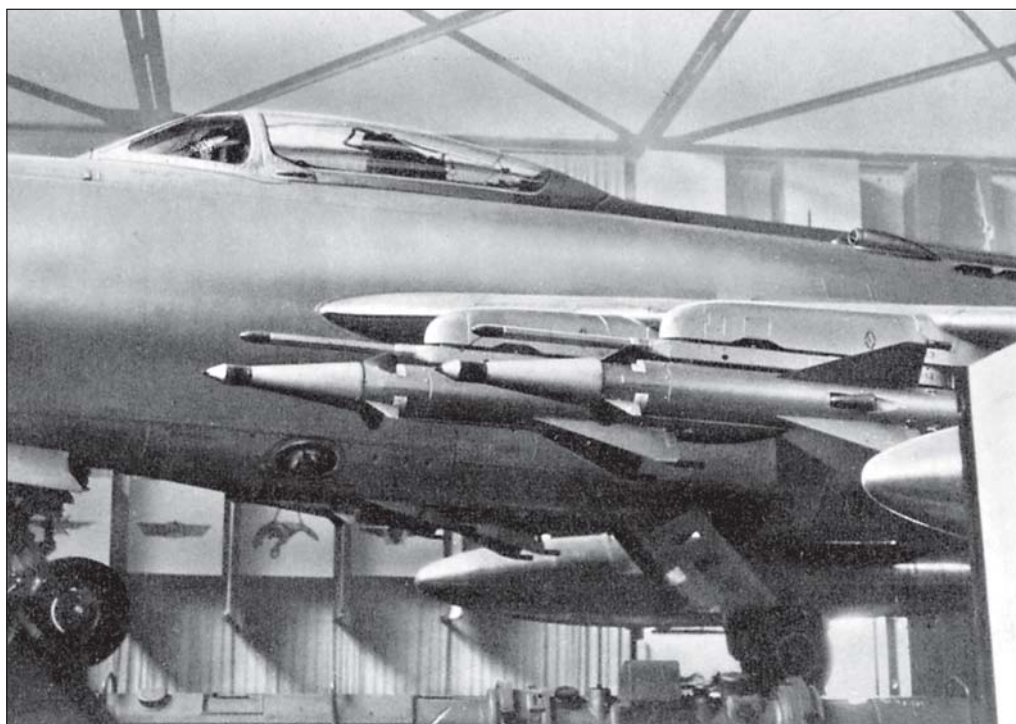
Ракеты класса «воздух — воздух», установленные на истребителе-перехватчике МиГ-19ПМ
