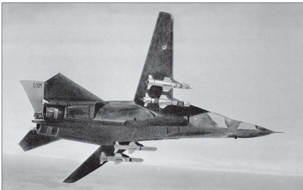
Тактический истребитель F-111C. 1969 г. Вооружен четырьмя противокорабельными крылатыми ракетами «Гарпун»
