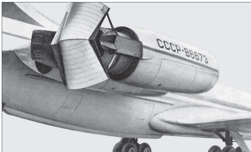
Устройство для реверсирования тяги при посадке на самолете Ил-62М
