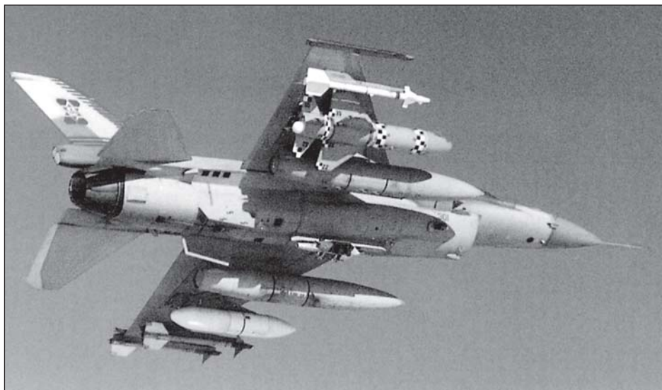
Расположение вооружения на узлах подвески истребителя
