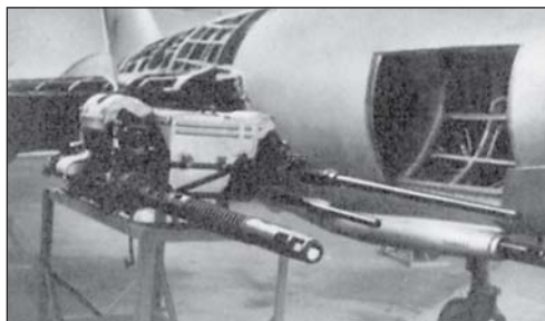
Лафет самолета МиГ-17 с установленными на нем пушками: Н-37 и НР-23
