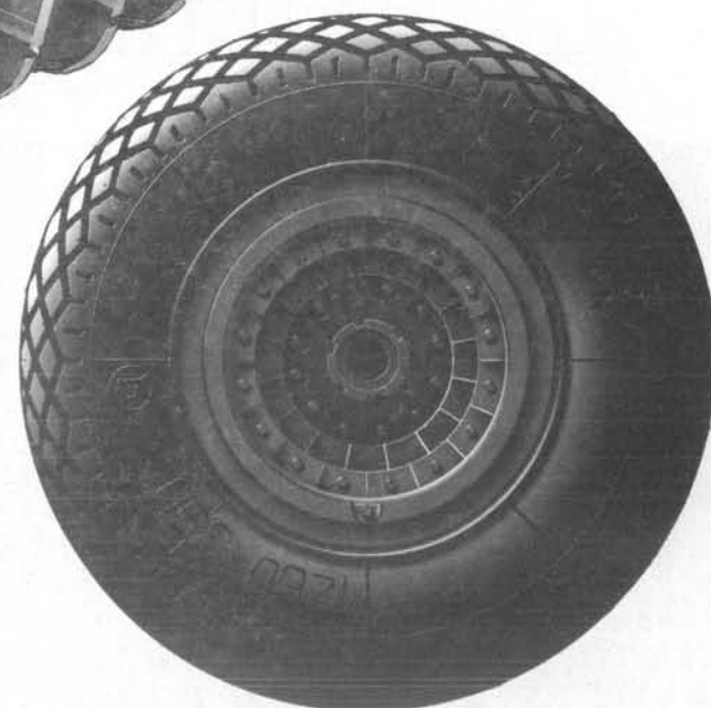
Рис. 60. Колесо основной стойки шасси 1260х390
