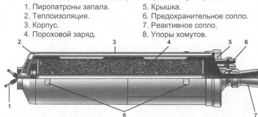
Рис. 33. Продольный разрез стартового ускорителя
