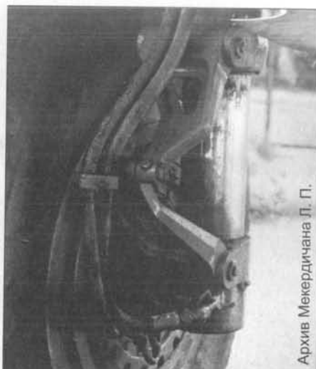
Вид на двухзвенник и трубопровода системы торможения
