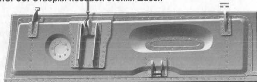
Рис. 33. Створки носовой стойки шасси
