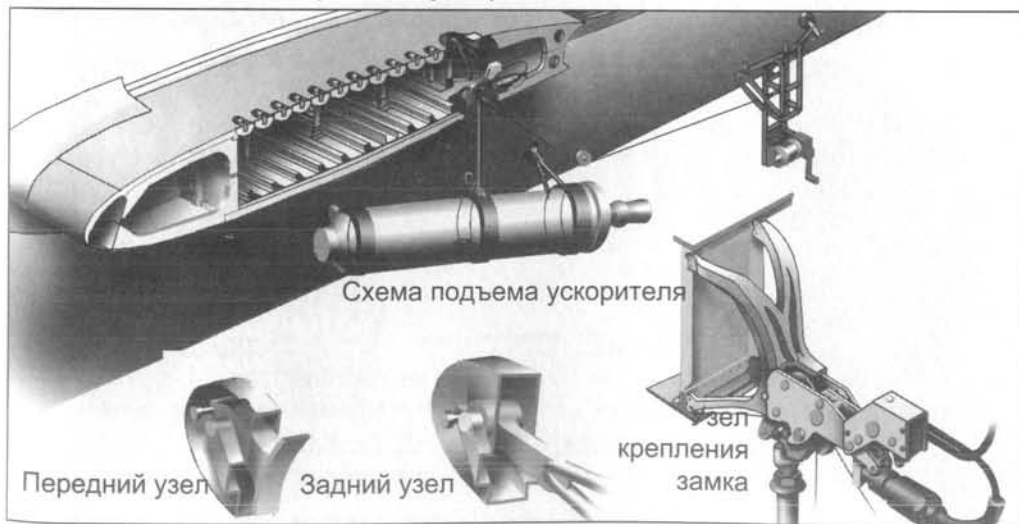
Рис. 32. Подвеска стартового ускорителя
