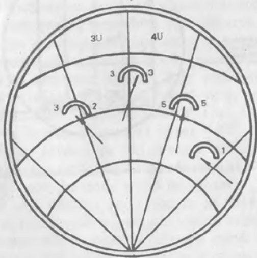
Рис. 4.6. Экран индикатора тактической обстановки (ИТО)
