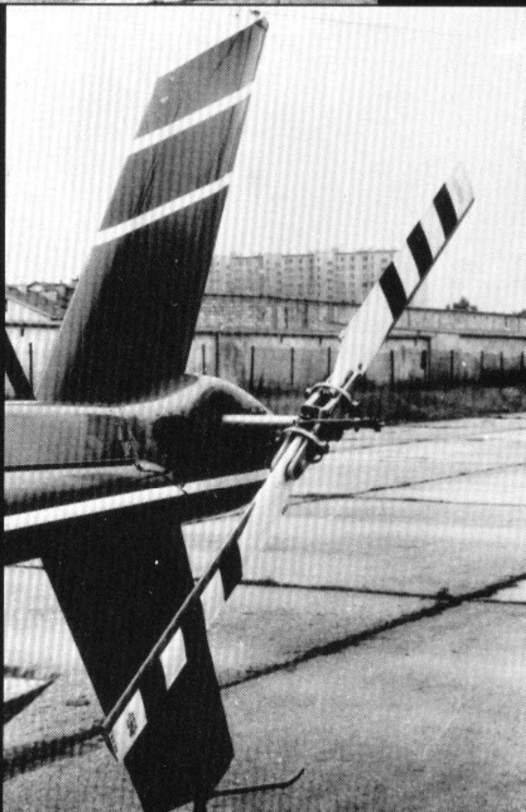
► ► Elementy mocujące i sterujące zmianą kąta nastawienia łopatek śmigła ogonowego
