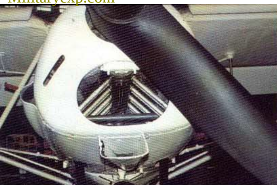
▲ Prząd kadłuba – widoczny silnik Argus As 10
