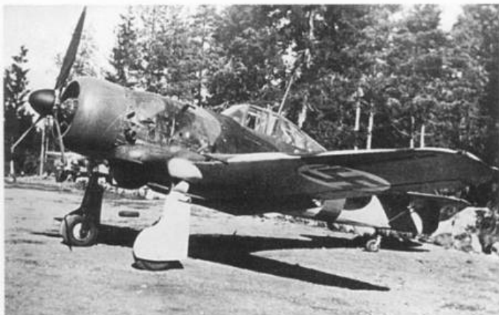
Fiński Fokker (FR-167), na którym było testowane składane podwozie firmy Messier.
