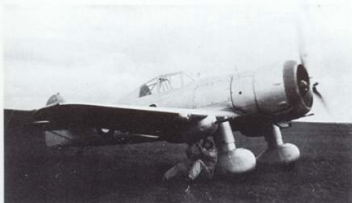
Fokker D.21 z oznaczeniem J-42 miał zabudowany silnik Mercury VI-S i trójłopatowe śmigło Ratier. / Fokker D.21 with J-42 marking had Mercury VI engine and three-blade Ratier propeller.
