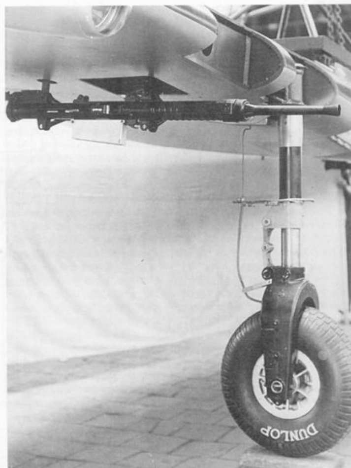
Działko Oerlikon 20 mm eksperymentalnie zamontowane pod skrzydłem fińskiego Fokkera FR-76 (osłona działka zdjęta).
