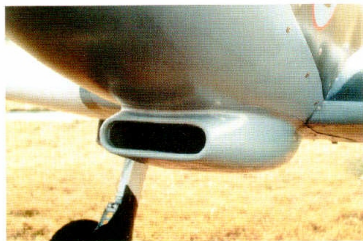
Wlot powietrza do gaźnika z filtrem Vokes Aero-Vee.
