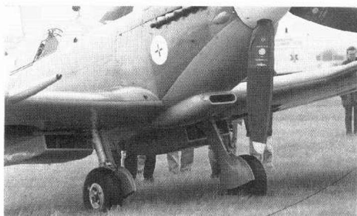
Spitfire Mk.VIII – podwozie główne oraz wlot powietrza do gaźnika.
