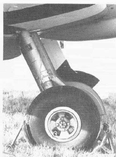
Podwozie główne Spitfire Mk.IX –widoczne różne rodzaje opon oraz felg.
