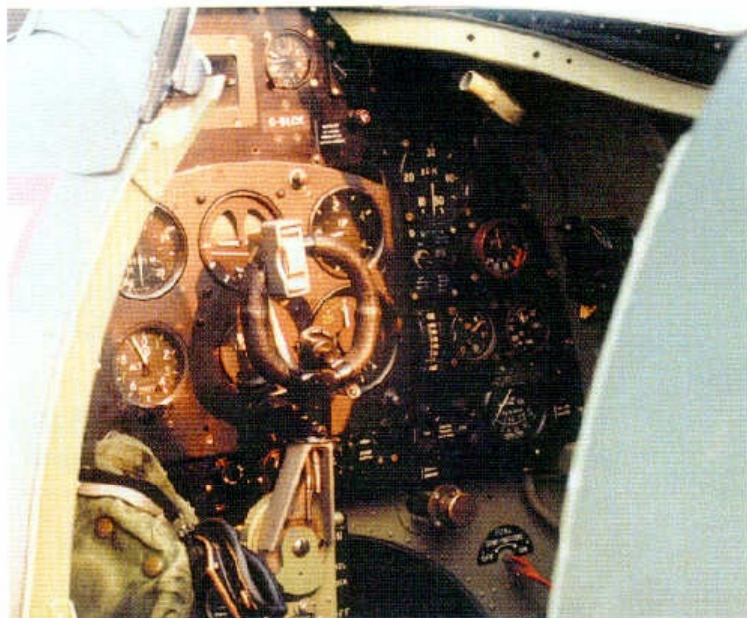
Spitfire Mk.IX – tablica przyrządów oraz drążek sterowy.
