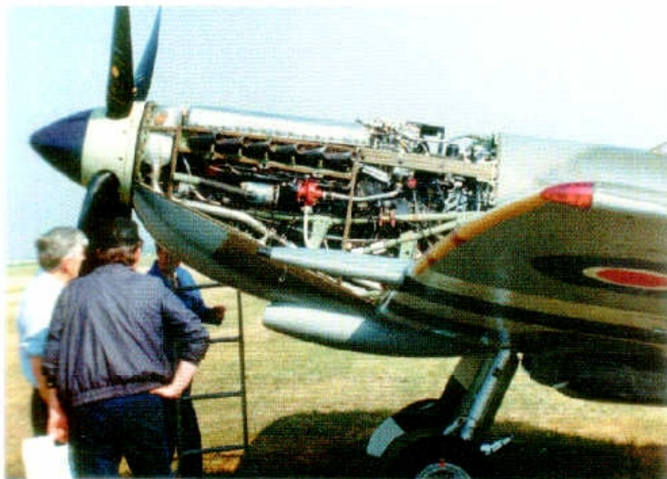
Silnik Merlin 66 zabudowany na Spitfire LF Mk.IXE.
