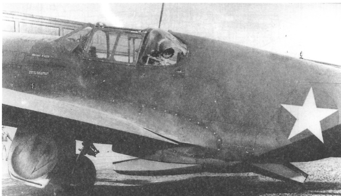
P-51A – widoczne "okno" z kamerą K-24.
