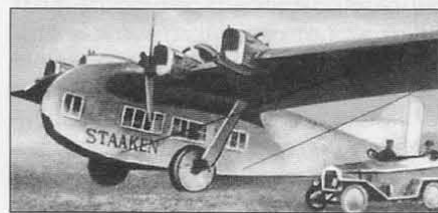
E-4.20 В полёте и на земле. Стойки, идущие от шасси, крепятся на амортизаторах и не разгружают крыло в полёте. Поэтому схема самолёта – не подкосный моноплан, как кажется на первый взгляд, а свободнонесущий высокоплан
