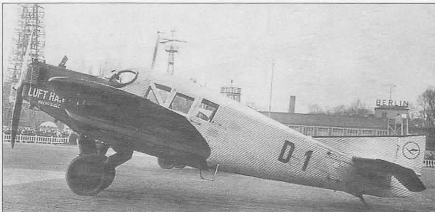
Первый в мире дюралевый пассажирский самолёт J13 оказался феноменально успешным. На снимке J.13a с мотором BMW IIIa
