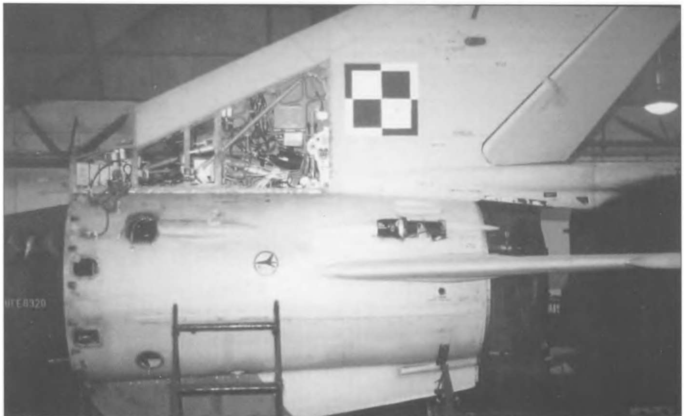
Во время ремонта часто снималась большая треугольная панель на киле истребителя, как например на этом польском МиГ-21МФ. Хорошо видно, что внутренняя поверхность окрашена антикоррозийной зеленой краской Chromate Green. Оранжевая коробка - САРПР (более известный как «черный ящик»). Сразу за ним черный гидравлический насос НН-27Т.
