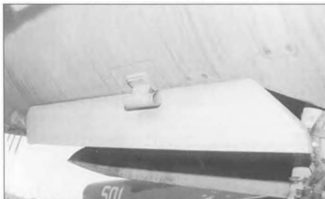
Сразу за левой створкой основного шасси находился температурный датчик РИС РП-22С «Сапфир» 21. Такие датчики стали стандартными начиная с МиГ-21ПФМ.
