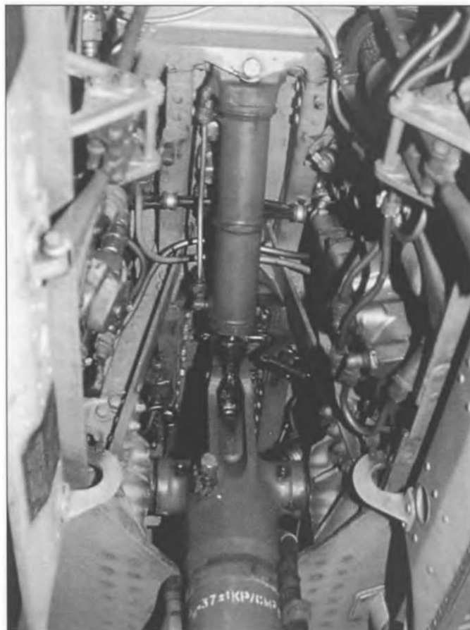
Гидравлическая система уборки/выпуска основной стойки шасси. В центре - основной цилиндр. Видны также различные шланги пневматической, гидравлической системы и электропроводка.
