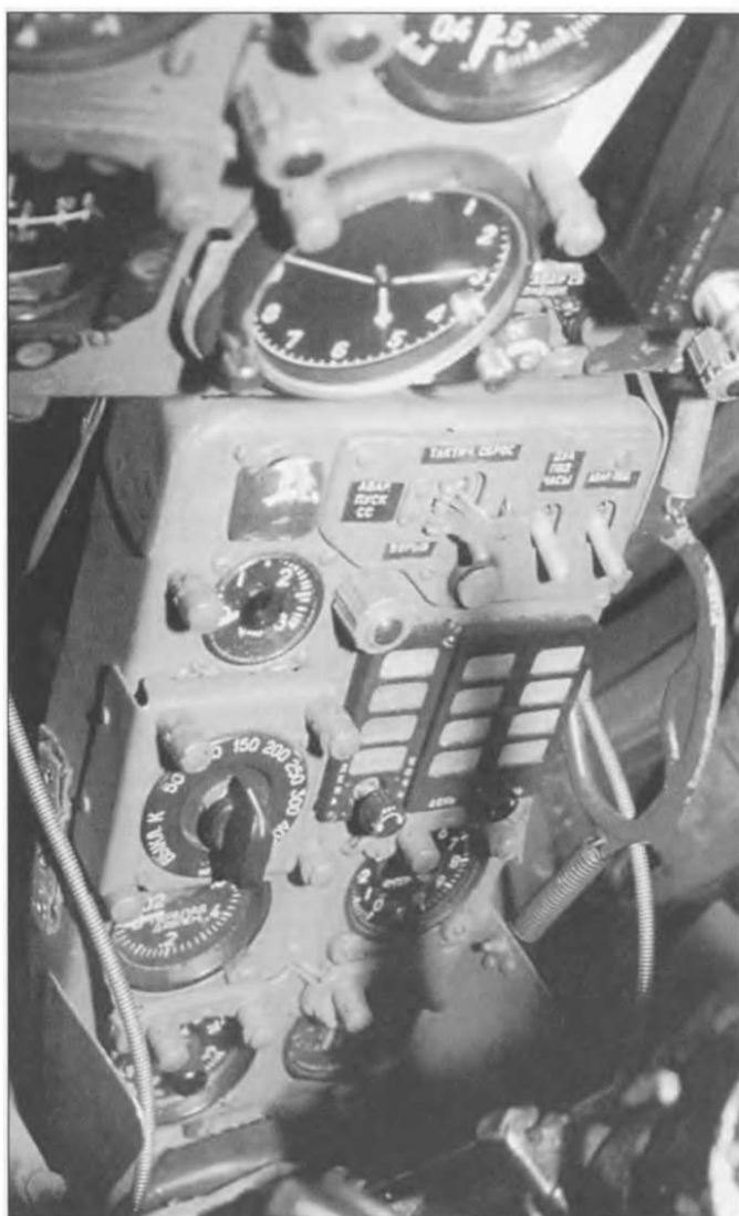
На самом верху приборной панели находился оптический прицел АСП-ПФД-21А. Справа находится фотокинопулемет СШ-45-1000С. Он использовался для контроля результатов стрельбы. Большинство таких фотокинопулеметов были покрашены черным, однако были и исключения - серебристый. Сразу над ФКП был смонтирован индикатор угла атаки ДВА-3А.
