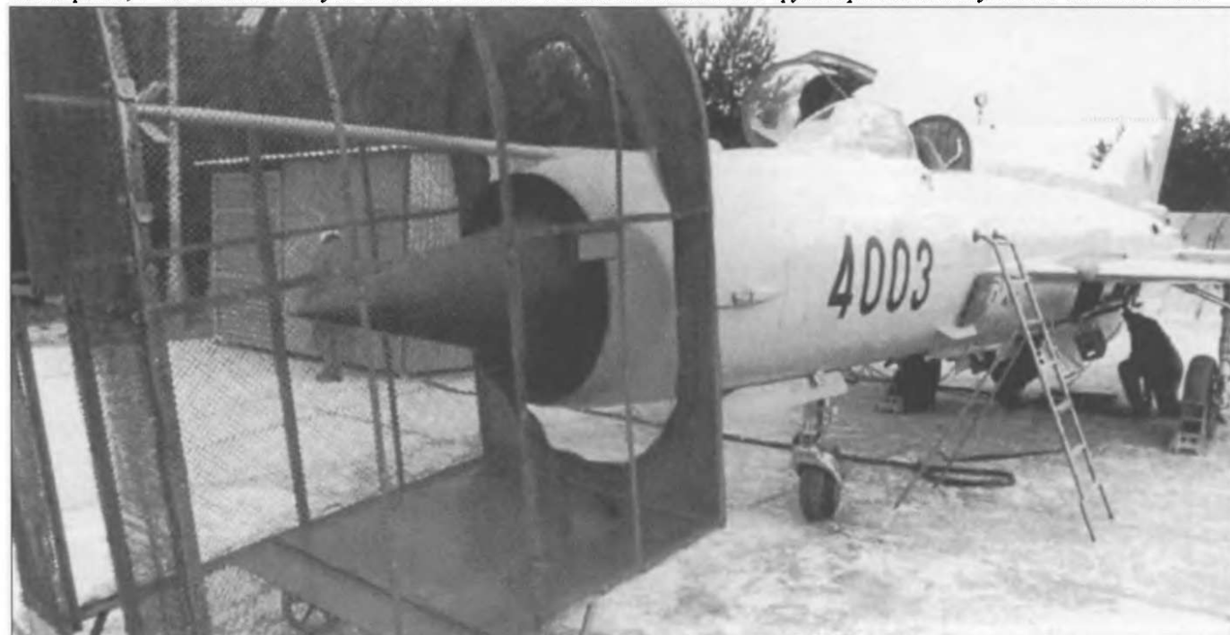
Устройство для проверки двигателя. В данном случае этой процедуре подвергается МиГ-21МФ («черный 4003») ВВС ЧССР. Два металлических кабеля за воздухозаборником удерживают самолет на месте.
