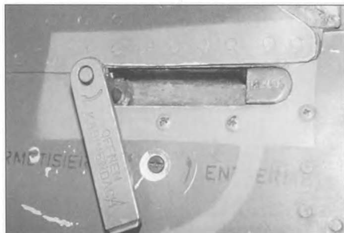
Для открытия фонаря МиГ-21МФ использовался ручной механизм открывания. Этот механизм находился слева.
