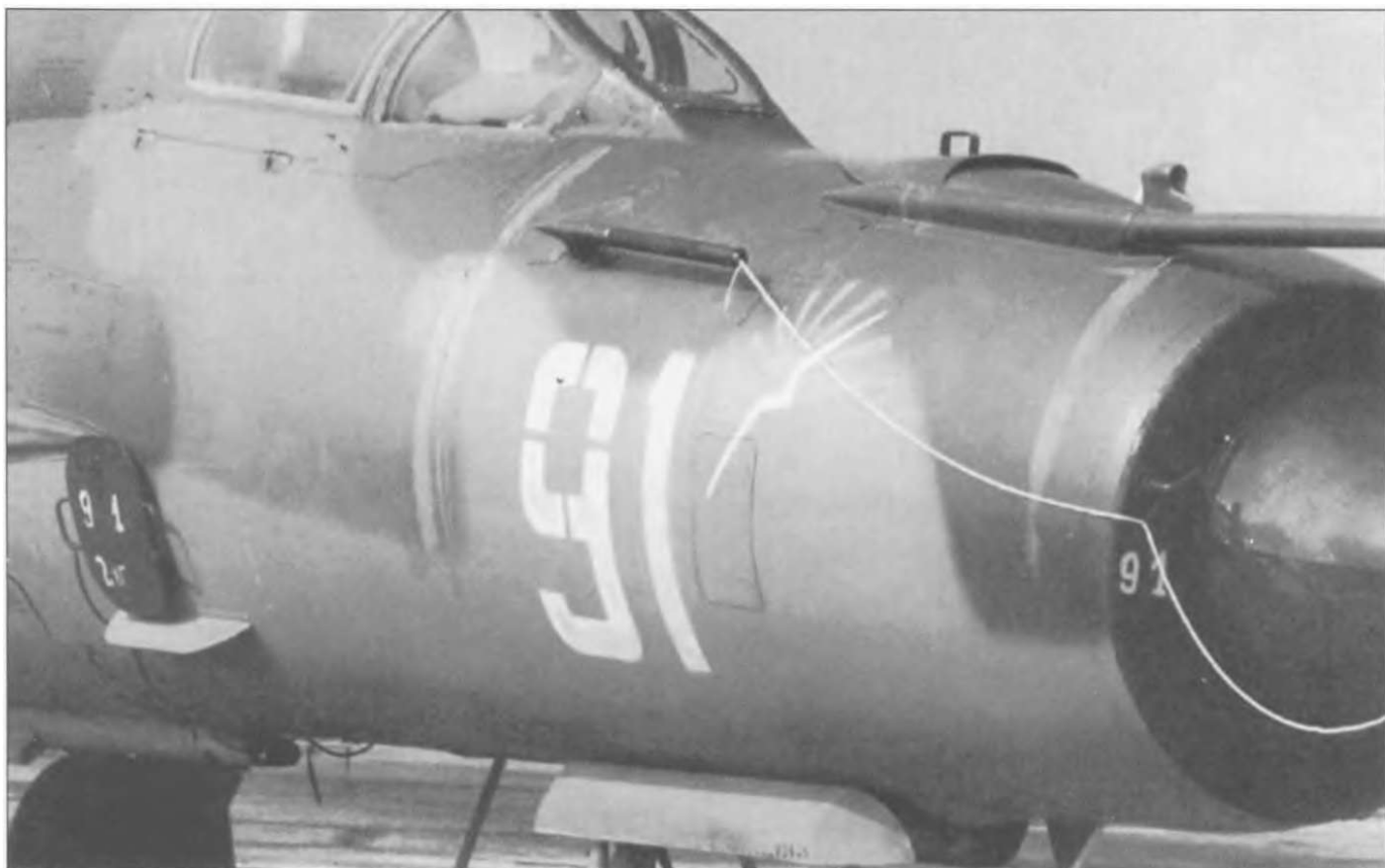
МиГ-21бис («белый 91» \ серийный 75080645) из состава 6-го ИАП ВВС Болгарии, авиабаза Бальчик. Датчик температуры располагался сразу за ПВД-7. Он уникален для болгарских и хорватских МиГ-21бис.
