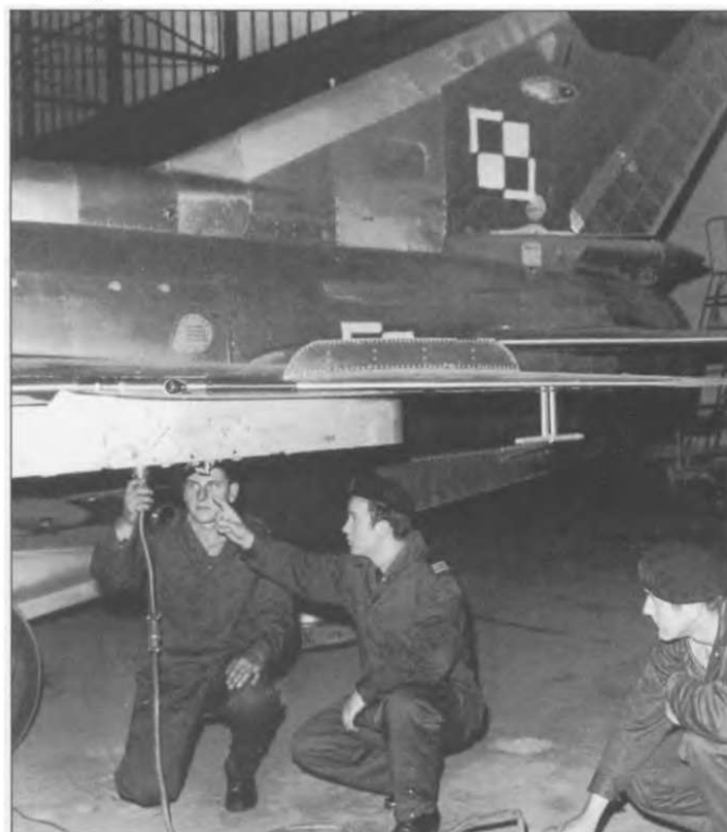
Польские механики обслуживают МиГ-21МФ («красный 9114» \ серийный 969114), октябрь 1974 года. На киле сразу над «шаховницами» находится индукционный сенсор ИД-2 компаса КСИ-2.
