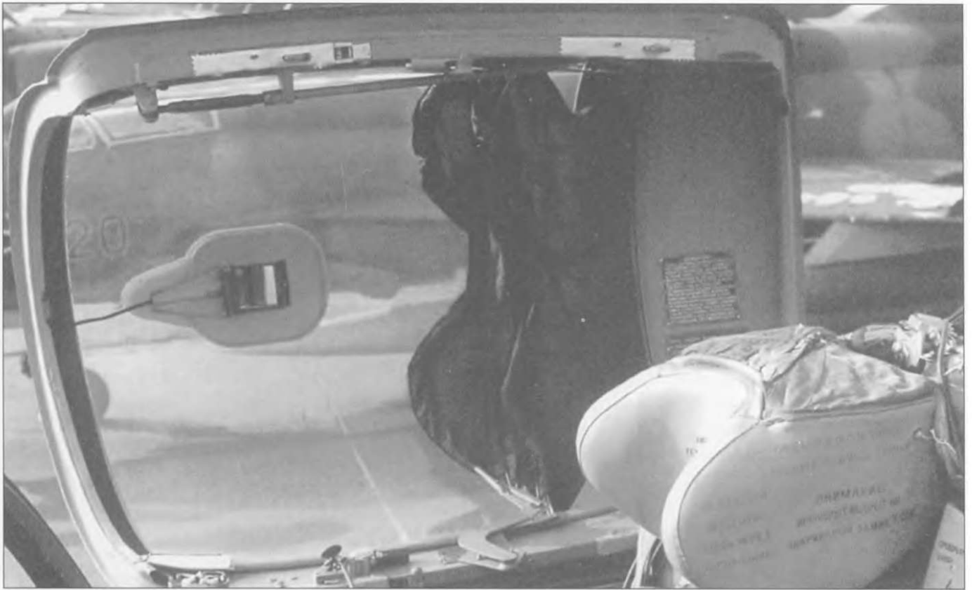
Открытый фонарь МиГ-21МФ («красный 513»/серийный 8613) ВВС ГДР. Внутренняя часть кабины покрашена темно-синей краской. Видны провода электрической системы.
