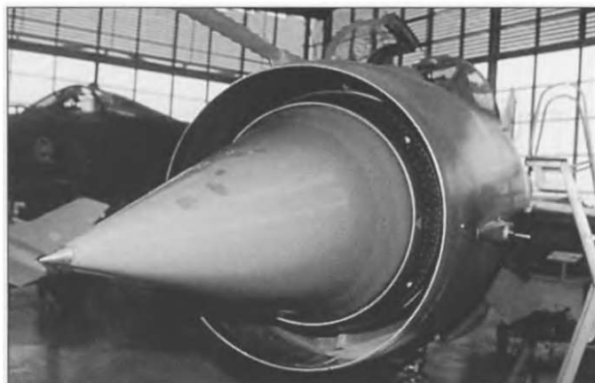
На МиГ-21МФ стоял диэлектрический конический нос. На большинстве МиГ-21 третьего и четвертого поколений он был покрашен зеленым Radome Green (FS24108), причем оттенок мог сильно отличаться в зависимости от производителя и частоты капитального и полевого ремонтов. Этот МиГ-21МФ из экспозиции Немецкого Музея - Werft Schlessheim.
