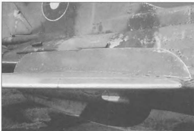
Рёбра жесткости на крыле МиГ-21МФ. На всех МиГах разных модификаций оно было одинаковой конструкции.
