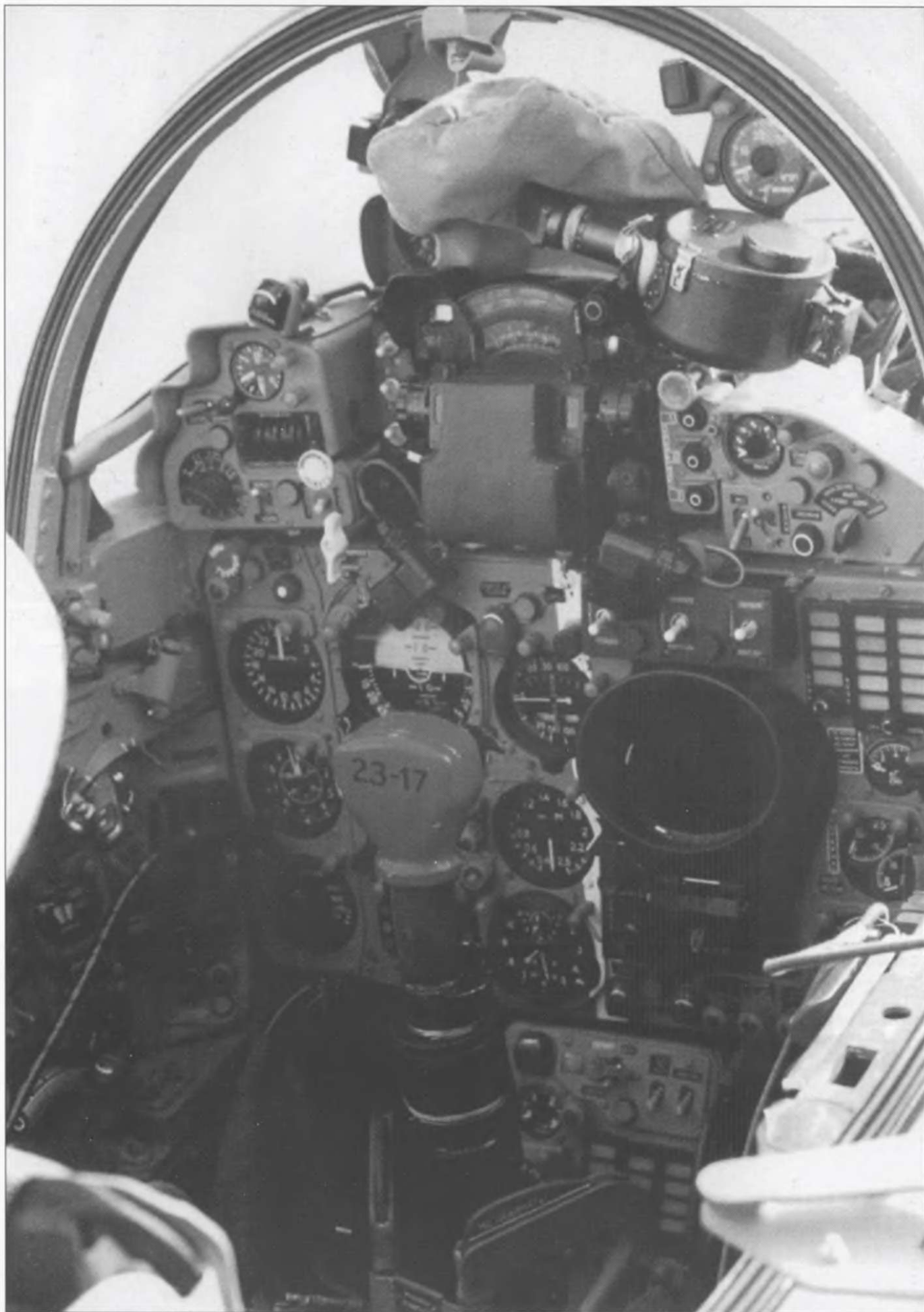
На этом германском МиГ-21МФ («красный 513») серийный 8613) приборы располагаются в несколько другом порядке чем на польской машине. Внутренняя часть кабины покрашена светло зеленым. После объединения Германии в 1990 году этот самолет получил обозначение 23+17. Номер написан черным на красном набалдашнике ручки управления.
