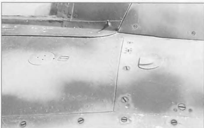
Небольшие воздухозаборники располагались только с левой стороны МиГ-21СММ. Хорошо видны винты доступа к панелям.
