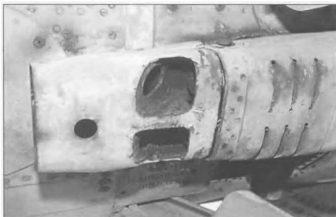
Вид снизу сзади на 23-мм пушку на МиГ-21М. Отверстия предназначены для отвода пороховых газов. Хорошо видны тормозные щитки.
