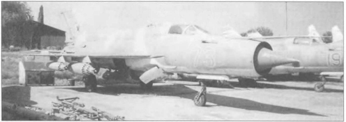
МиГ-21бис ВВС СССР с блоками НАР УБ-32 на внутренних пилонах и УБ-16-57 - на внешних. Все они предназначены для пуска 57-мм НАР С-5. Окраска нижних поверхностей в серый цвет крайне нехарактерна для советских МиГ-21 (норма - светло-голубой). Верхние поверхности - зелено-коричневые, тактический номер - окантовка на фоне камуфляжа.
