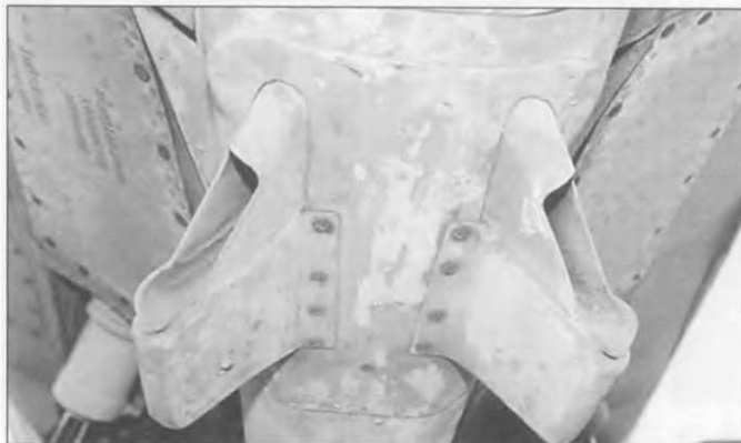
Механизм отвода стрелянных гильз. Двухствольная ГШ-23Л обладала скорострельностью 3000-3400 выстрелов в минуту. Такая пушка стояла на МиГ-23, а также в турелях Ту-22М-3 и Ту-95МС.
