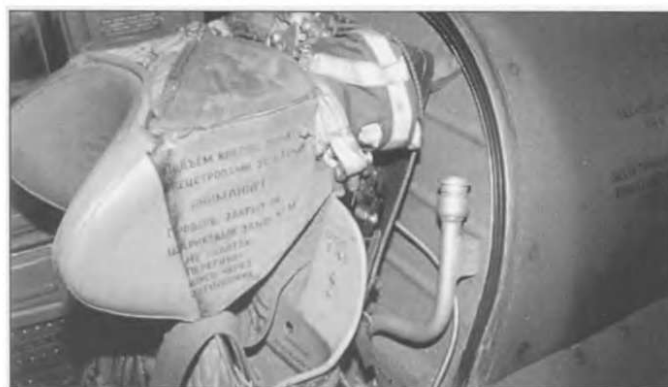
На катапультном кресле КМ-1М сложная система пристяжных ремней, которые обычно были серыми. С их помощью летчик надежно закреплялся во время катапультирования.
