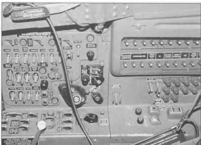
Несколько десятков кнопочек на правой стороне кабины. Предназначены для включения большинства приборов, в том числе РП-22С «Сапфир» 21 и радиоконпаса АРК-10.
