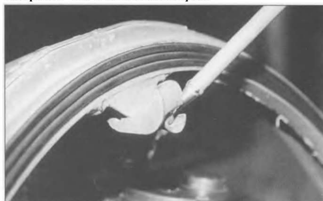
Крепление фонаря в открытом состоянии. Обычно оно красилось в тот же цвет, что и внутренняя часть кабины.
