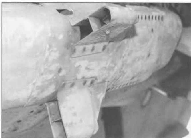
Компенсаторы отдачи в нижней части пушки. Пушка массой 52 кг. Нижнее расположение пушки способствовало минимизации негативного воздействия на конструкцию фюзеляжа.
