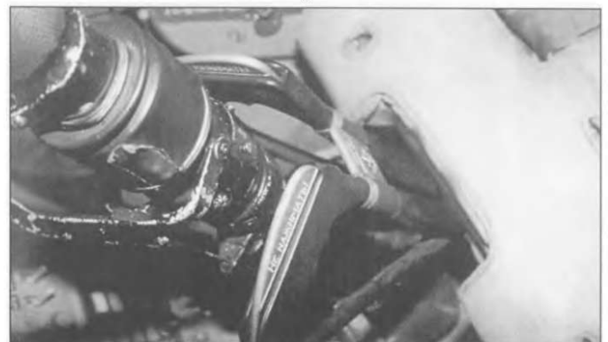
Рукоятки запуска катапультного кресла располагались под углом примерно в 45° градусов.
