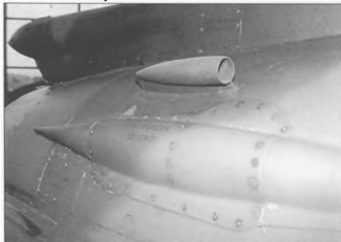
Детальное фото вспомогательного воздухозаборника форсажной камеры. На стоянке он закрывался специальной заглушкой.
