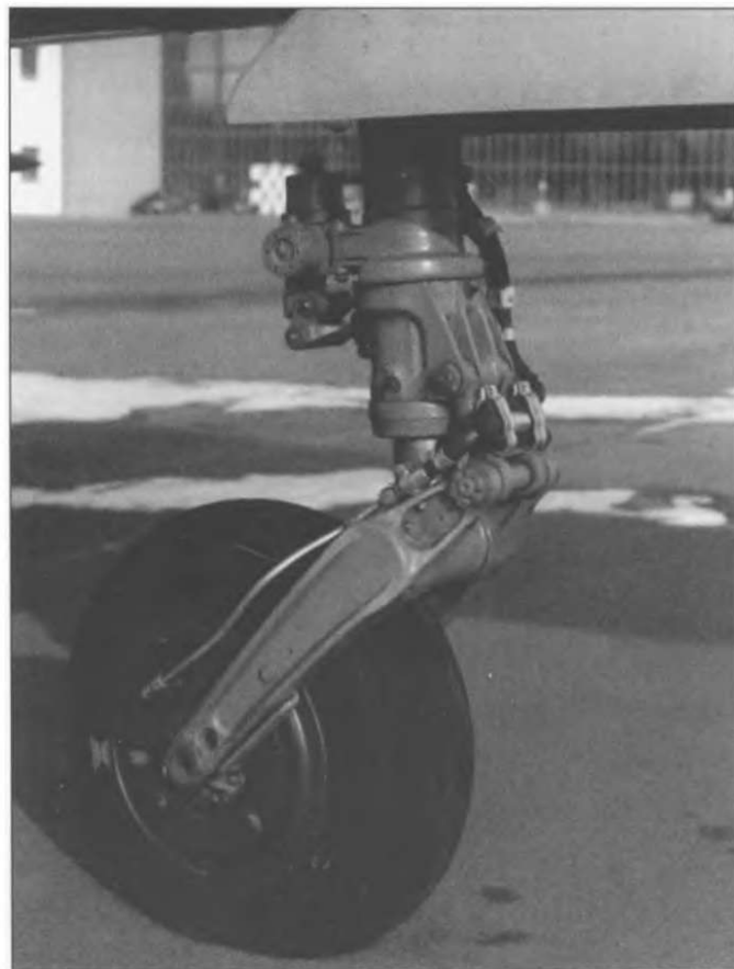
На носовой стойке МиГ-21МФ стояло колесо КТ-102 с размером шины - диаметр 180 мм, ширина - 500 мм. Шланги системы гидравлических тормозов подводились справа. Обычно диск колеса красился сине-зеленым Blue-Green (приблизительно FS25193).
