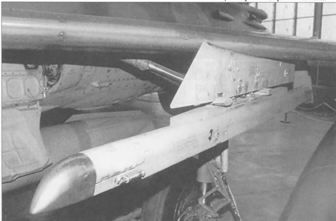
Пусковая установка АПУ-13МТ, которая монтировалась на пилоне БДЗ-60-21Д. С ее помощью запускались УР Р-3С. Такие АПУ могли монтироваться на всех четырех пилонх МиГ-21МФ.
