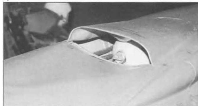
Четырехлитровый бачок чистого спирта располагался перед кабиной МиГ-21МФ. Спирт предназначался для антиобледенительной системы. Частично кабина обогревалась теплом от двигателя. ПВД-7 располагается справа.
