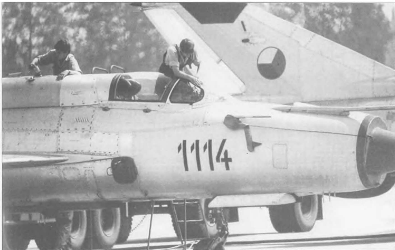
МиГ-21М («черный 1114») ВВС ЧССР готовится к очередному вылету. На самолете стоят защитные красные колпаки. Обратите внимание на отсутствие зеркала заднего вида и гильзоотражателя.
