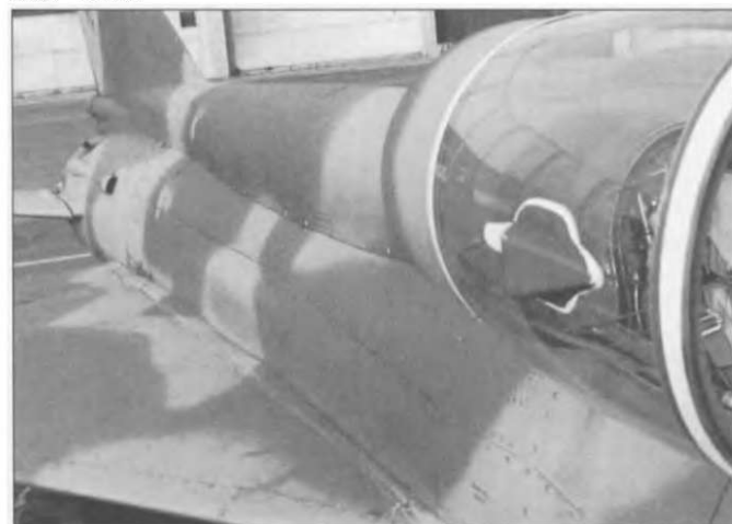
Более широкий гаргрот был визитной карточкой МиГ-21бис. Благодаря ему емкость внутренних топливных баков самолета увеличилась до 2880 литров (на 280 литров по сравнению с МиГ-21МФ).
