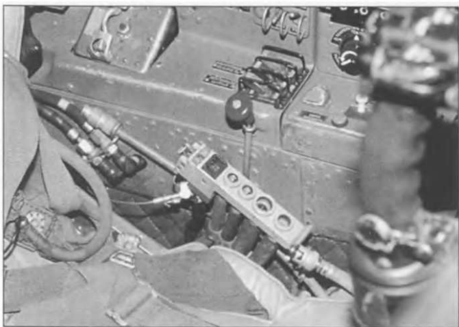
Серебристая коробка - панель кислородной системы, монтировалась слева. Система была очень важна для жизнедеятельности летчика на большой высоте. Именно сюда подключались шланги шлема пилота.
