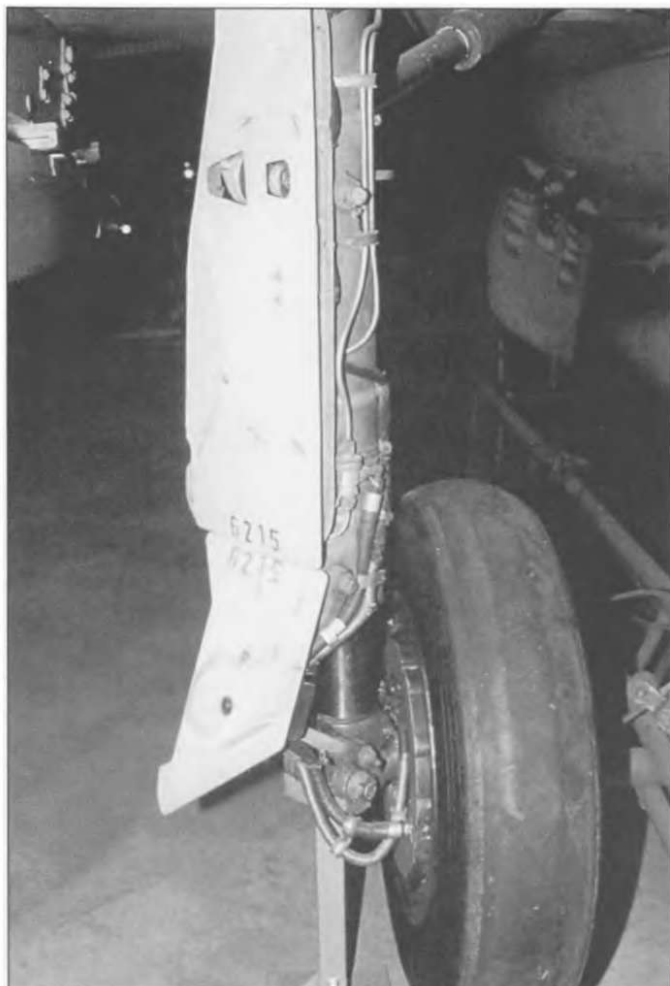
На основной стойке шасси МиГ-21МФ стояло колесо КТ-92Б. Оно разворачивалось на 87° при уборке \ выпуске стойки. Делалось это с помощью гидравлики. Стойка основного шасси прикрывалась двухстворчатой створкой. Само шасси было диаметром 800 мм и шириной в 200 мм. Они были больше чем на ранних модификациях МиГ-21.
