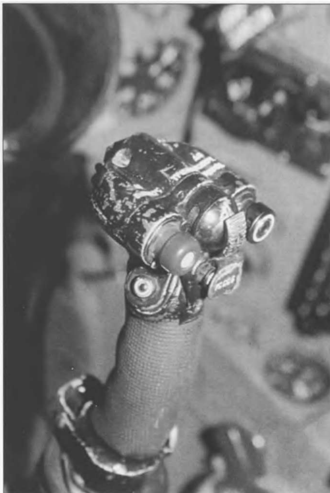
Ручка управления тягой двигателя - на левой консоли. Положение вниз - максимальная тяга. На ручке находилась кнопка управления радиостанции Р-802 (РСИУ-5В). Хорошо видны шланги кислородной системы в наземном положении.
