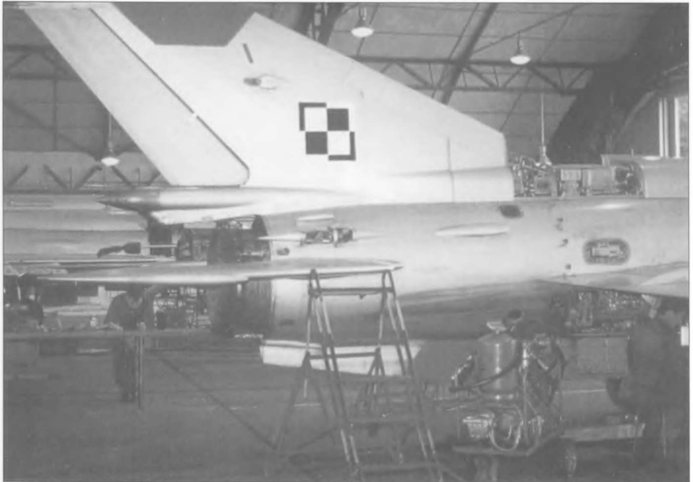
Ремонтные работы на польском МиГ-21МФ. Двигатель Р-13-300 частично демонтирован. Советская доктрина, принятая и в других странах Варшавского договора, предполагала небольшой ремонт в полевых условиях прямо на аэродроме базирования, а капитальный - на АРЗ.
