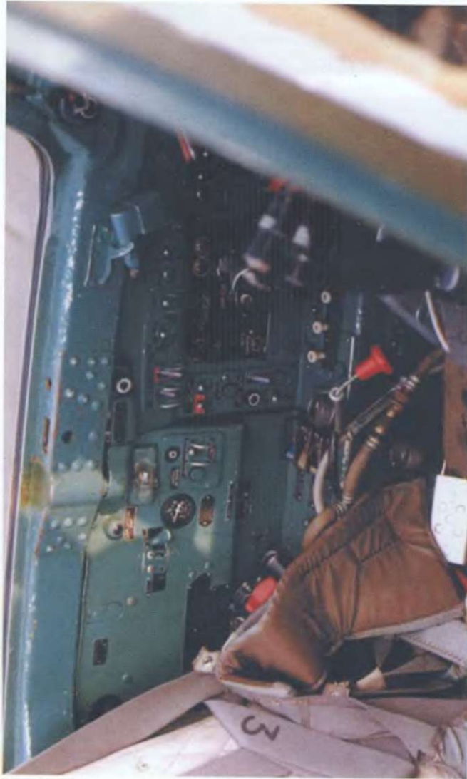
Левая панель МиГ-21 бис САУ в принципе идентична МиГ-21МФ, но заметны некоторые изменения. Так отсутствует целый блок переключателей.
