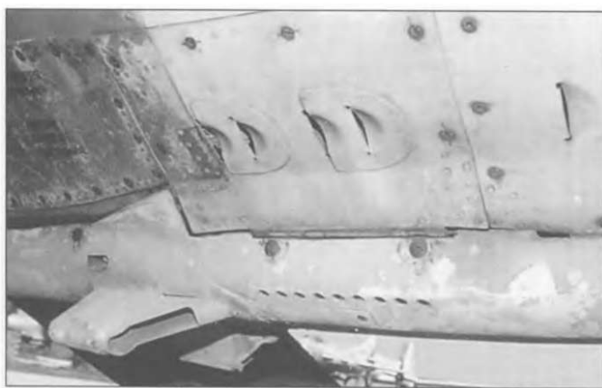
Панель доступа к боекомплекту пушки. Хорошо видны следы от нагара после стрельбы.
