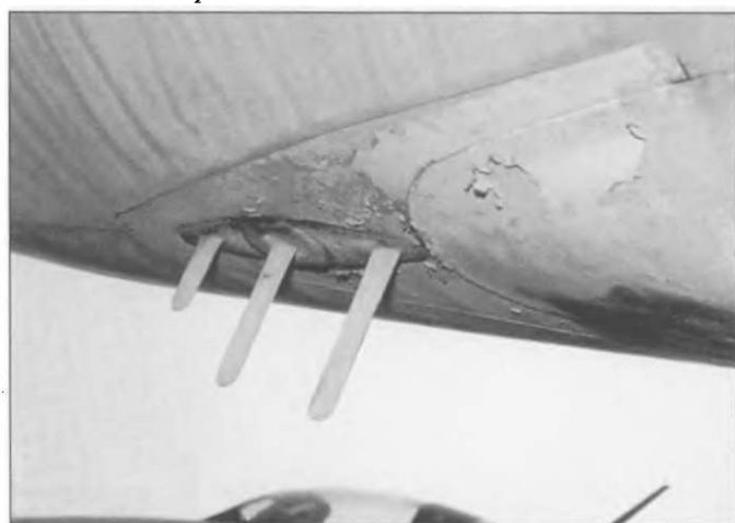
Трехсоставная антенна системы опознавания СРО-2 «Хром». Такая система использовалась на всех МиГ-21 и нескольких типах советских самолетов, включая Ту-134.
