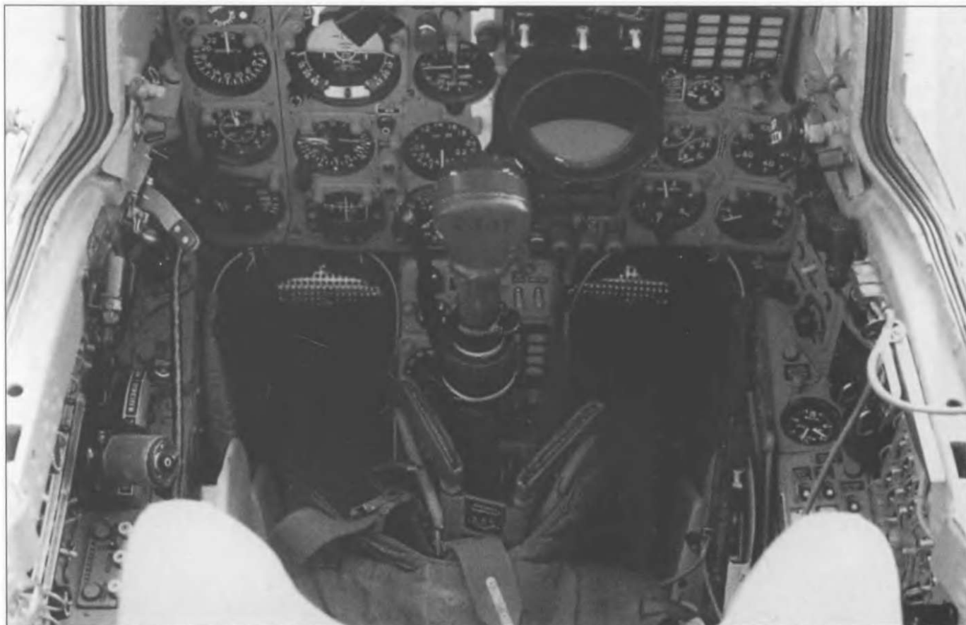
Экран РЛС на МиГ-21МФ располагался справа внизу. При переобучении летчиков на новую модификацию истребителя возникали проблемы, так как на ранних МиГах экран РЛС располагался посредине сверху. Красный набадашник одевался на ручку управления на стоянке, чтобы избежать аварийных ситуаций.
