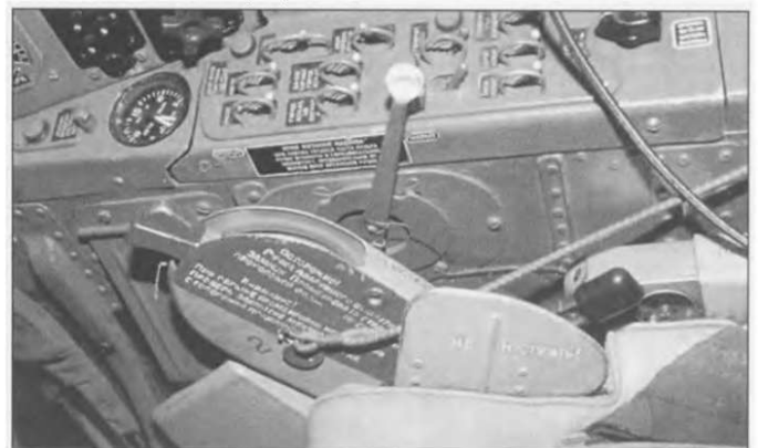
На правой стороне катапультного кресла была красная табличка, которая предупреждала летчика и наземный персонал. Тут же был предохранитель, который не давал автоматически.
