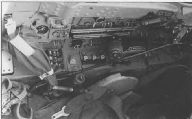
Ручка управления тягой двигателя - на левой консоли. Положение вниз - максимальная тяга. На ручке находилась кнопка управления радиостанции Р-802 (РСИУ-5В). Хорошо видны шланги кислородной системы в наземном положении.
