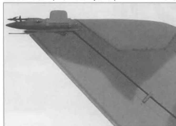
Антенна РСБН-5С на киле МиГ-21бис САУ. Таких антенн не было на ранних МиГ-21бис.
