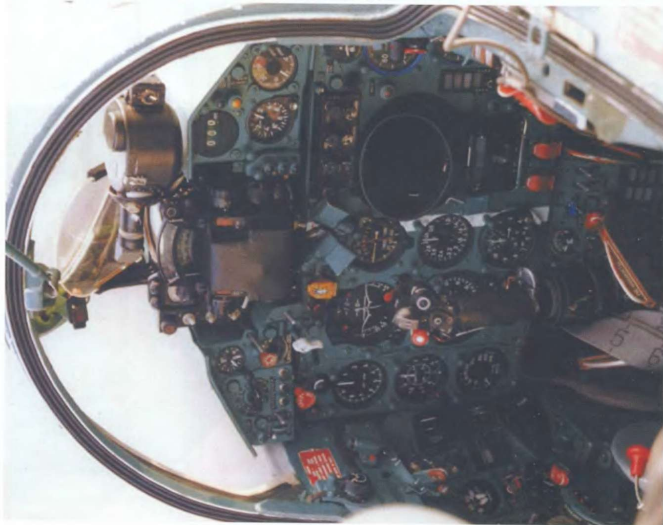
Кабина восточногерманского МиГ-21бис САУ («красный 846» \ серийный 75051402). По сравнению с МиГ-21МФ в кабине заметны некоторые незначительные изменения. Так индикатор угла атаки перенесен с верхнего СПШ-45-1000С вправо вниз. Над экраном РТС появилась новая кнопочная панель. На МиГ-21 бис САУ по сравнению с МиГ-21МФ была изменена и правая консоль. Видна белая полоса на приборной панели, которую использовали для ориентации в пространстве.
