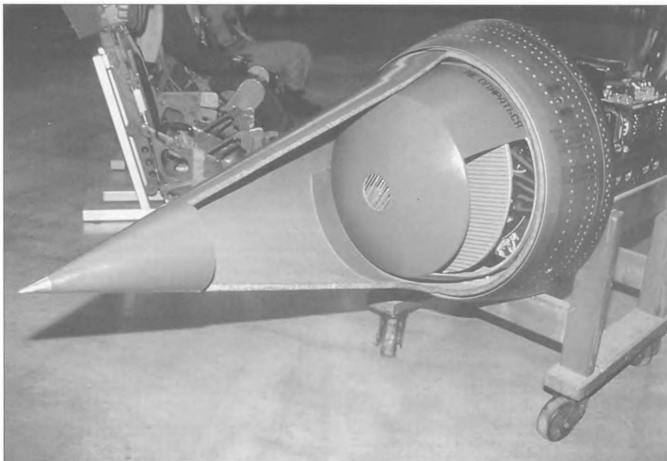
РЛС РП-22С «Сапфир» 21 весила 140 кг. Конструкторское бюро Волкова разработало этот образец специально для МиГ-21. Эффективная дальность применения РЛС - 15 км. МиГ-21МФ стал первым экспортным самолетом, на котором стояла такая РЛС. Ранние МиГ-21М несли более старую модель - РП-21МА, в то время как советские МиГ-21С\СМ - РП-22С. На этом музейном экспонате РЛС показан в разрезе.
