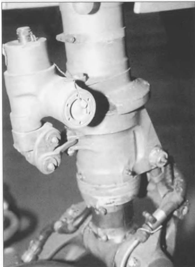
На правой стороне основной стойки шасси находился небольшой посадочный огонь. Хорошо видна система УП-53\М. Видны также шланги пневматической системы.
