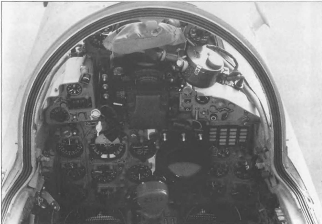
Прицел АСП-ПФД-21А располагался сверху приборной доски этого МиГ-21МФ («красный 513») серийный 8613) ВВС ГДР. Приборы, необходимые для полета, располагались слева, а управление двигателем, гидравлической и топливной систем - справа. Посредине приборной доски белая полоса.
