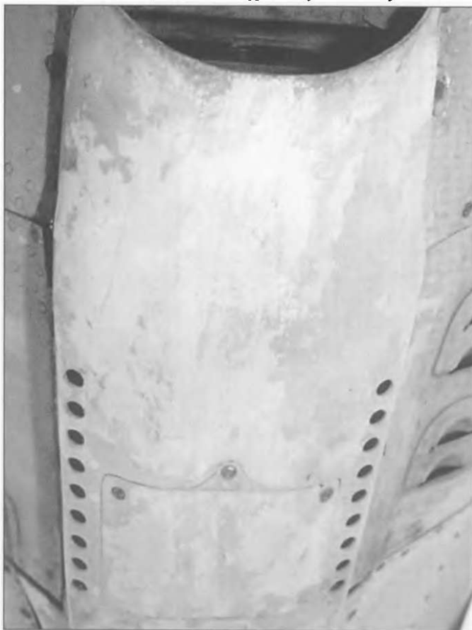
Панель в нижней части ГШ-23Л демонтировалась для обслуживания пушки. Все советское оборудование было спроектировано с возможностью легкого обслуживания. Поэтому обслуживание советской техники всегда было возможно даже неподготовленным персоналом.
