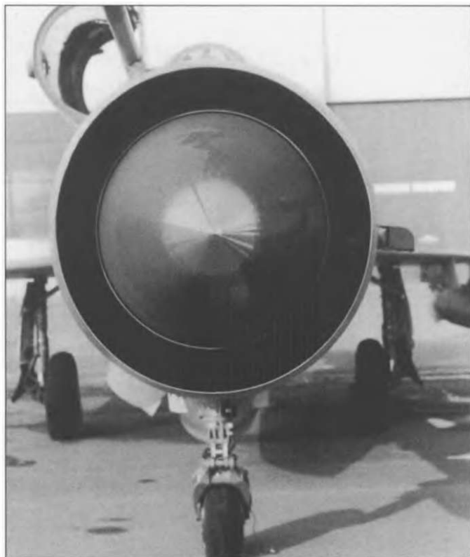
В носовой части МиГ-21МФ стоял конический конус из диэлектрика, в котором располагалась антенна РЛС РП-22С «Сапфир» 21. Антенна ПВД-7 располагается справа по центру.
