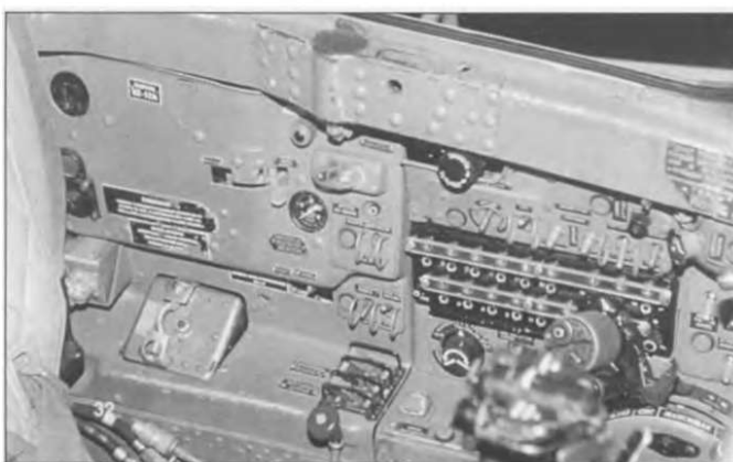
Небольшие кнопки на левой панели МиГ-21МФ предназначены для наземного персонала и отвечают за давление в кабине. В полете летчиком не использовались.
