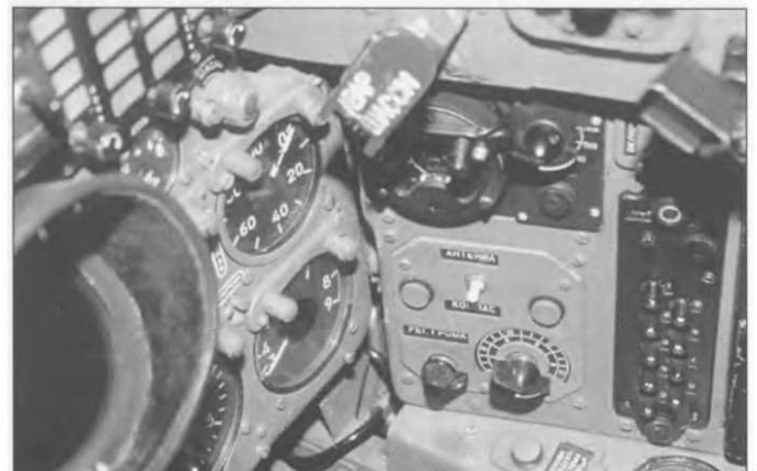
Красная рукоятка аварийного торможения располагалась справа в кабине МиГ-21МФ. Хорошо виден экран РЛС.
