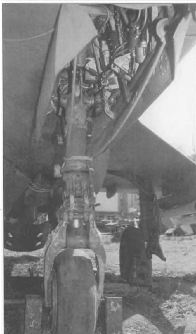
На стойке основного шасси МиГ-21бис справа находился красный навигационный фонарь, который свидетельствовал о полном выпуске шасси. Его расположение отличалось от аналогичного на МиГ-21МФ.
