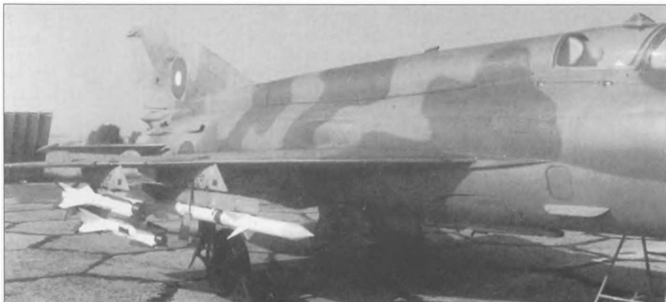
МиГ-21бис болгарских ВВС с ОЗ, введенными в 1992 году. На самолете подвешены четыре УР Р-60М (длина - 1195 мм, масса 48 кг) и две Р-3Р (длина - 3350 мм, масса - 90 кг).
