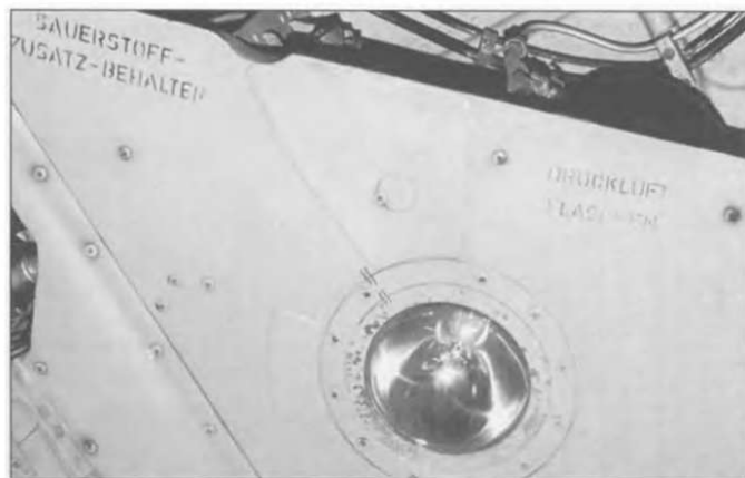
Внизу каждого крыла МиГ-21МФ стояли посадочные огни МПРФ-1А. Они использовались при рулежке самолета. На этом восточногерманском МиГ-21МФ («красный 687») (серийный 6215), находящийся в авиационном музее Шлейсгейма, советские лампы заменены на американские фирмы General Electric (GE).
