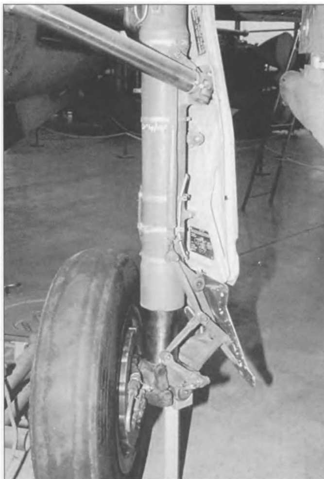
На основной стойке шасси МиГ-21МФ стояло колесо КТ-92Б. Оно разворачивалось на 87° при уборке \ выпуске стойки. Делалось это с помощью гидравлики. Стойка основного шасси прикрывалась двухстворчатой створкой. Само шасси было диаметром 800 мм и шириной в 200 мм. Они были больше чем на ранних модификациях МиГ-21.
