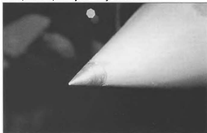
Конус был ламинирован пластиком, а передняя часть - металлическая. Конусы на МиГ-21СММ и МиГ-21МФ были идентичными.
