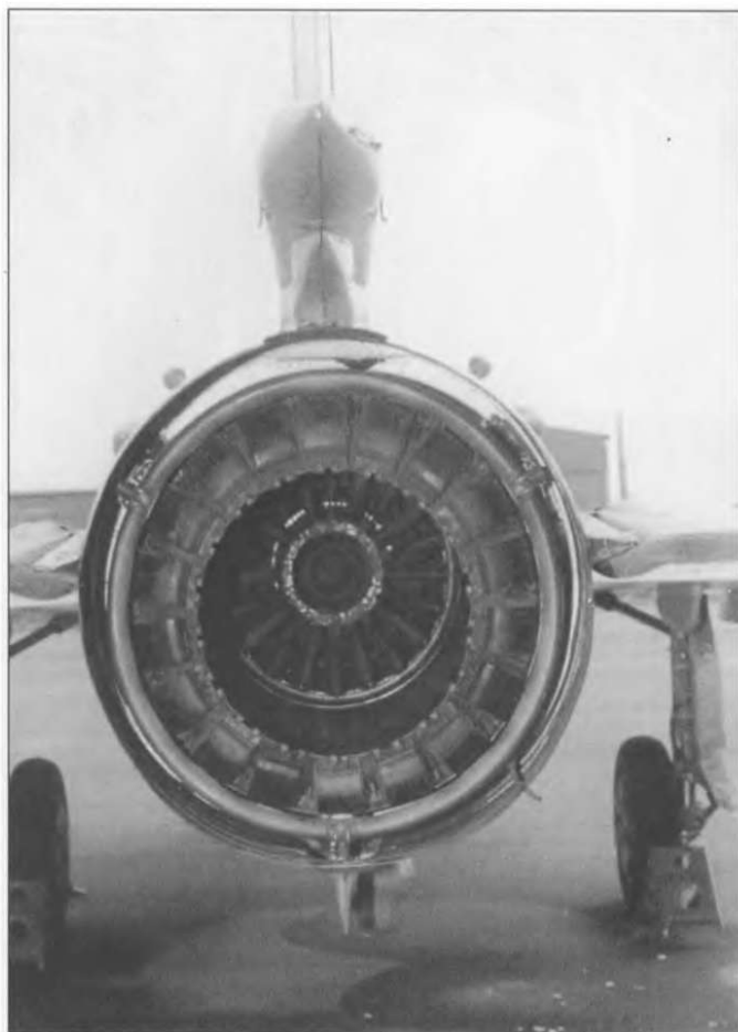
Площадь конвергентной зоны на двигателе регулировалась гидравлическими активаторами, которые располагались на позиции 2,6 и 10 часов. Открытием \ закрытием заслонки регулировалась мощность двигателя на разных режимах полета. Максимальный диаметр на форсаже составлял 906 мм. Температура здесь достигает 740° С.
