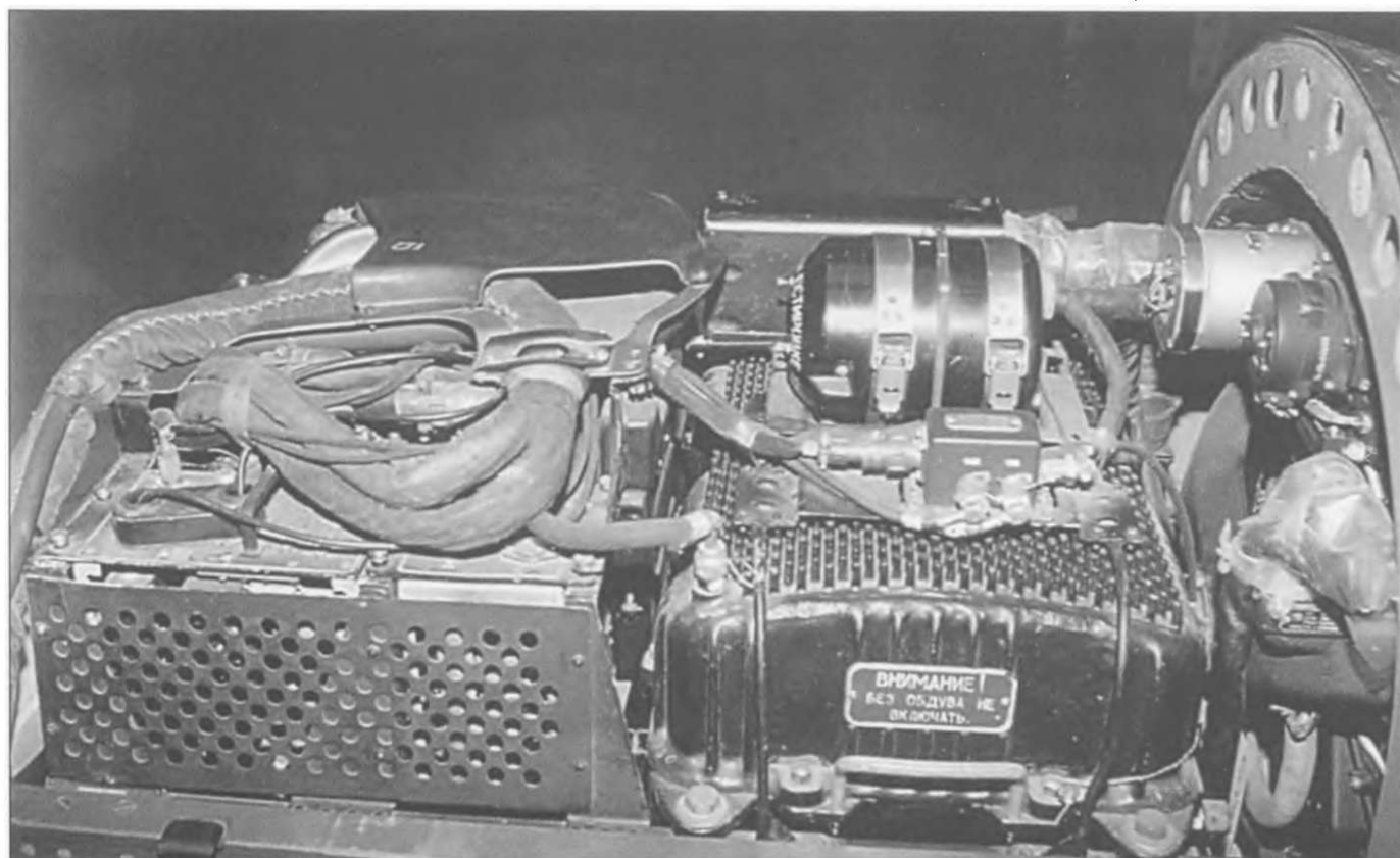
РП-22С даже для технологий 60-х годов был тяжеловат. В нем применялись как минимум 150 ламп, в то время как аналогичных западных образцах - полупроводники. Несмотря на то, что РП-22С имел те же размеры что и РП-21, эффективность его была значительно выше.
