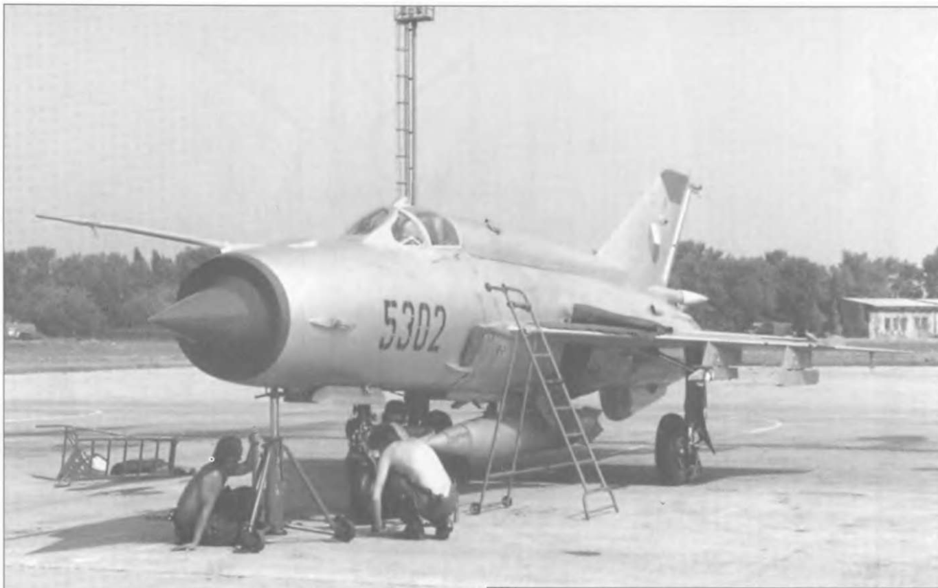
Механики ВВС ЧССР обслуживают основное шасси МиГ-21МФ («черный 5302 \ серийный 965302). Самолет стоит на подпорках. На левом крыле лежит защитное покрытие.
