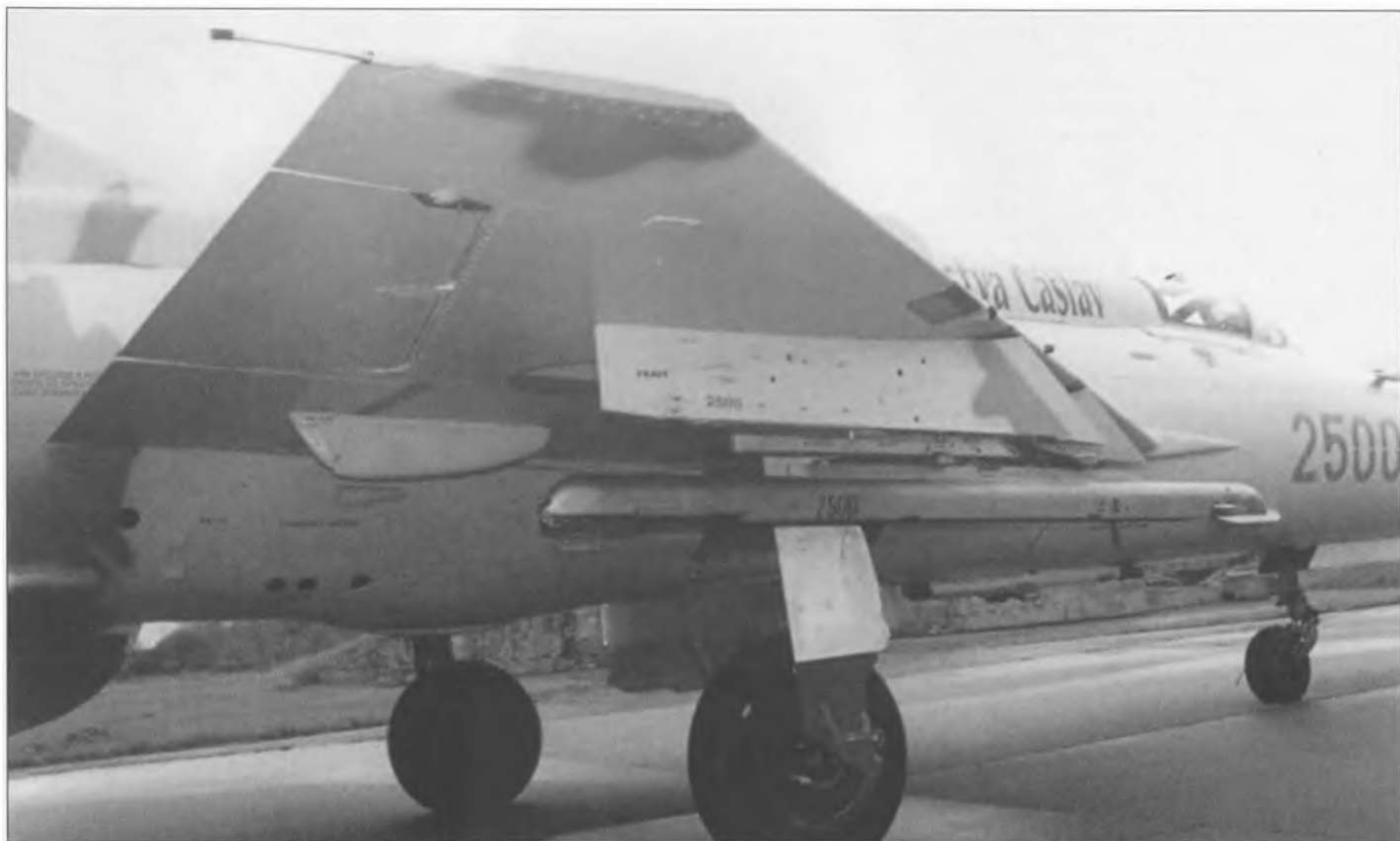
На законцовке крыла каждого модернизированного чешского МиГ-21МФ находится антенна радиоальтиметра РВ-5М, поставленного вместо РВ-УМ.
