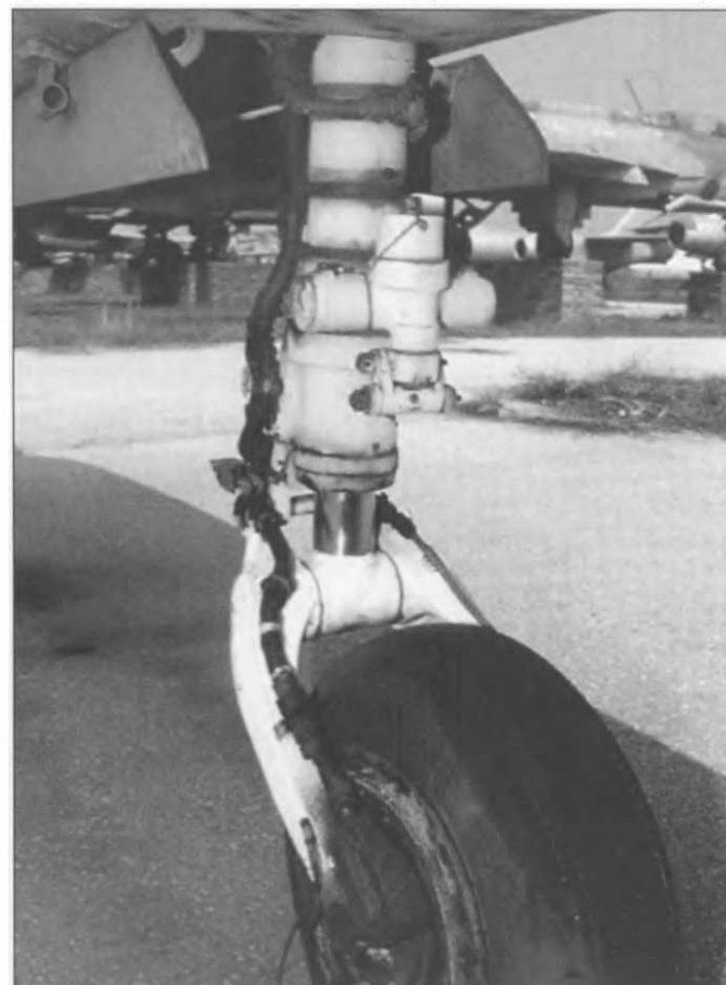
Другой вид на КТ-102. Слева стойки установлен датчик системы анти-опрокидывания УА-24. В случае отказа гидравлики стойку можно было убрать или выпустить с помощью резервной пневматической системы или вручную.
