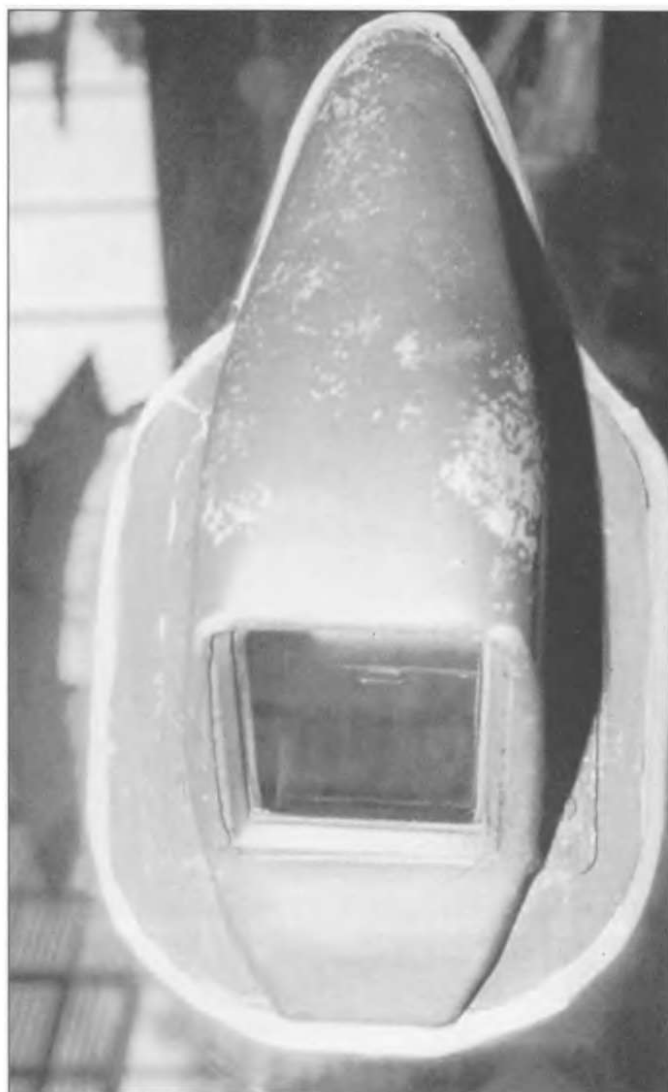
ТС-27АМШ также устанавливался на МиГ-21 третьего и четвертого поколений. Зеркало обеспечивало угол обзора назад в 35°. Однако отметим, что на МиГ-21МФ обзор у летчика был значительно хуже чем у любого западного летчика-истребителя.
