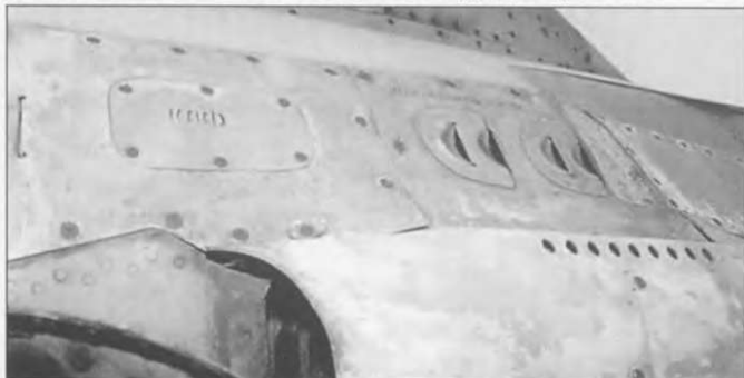
Фотография правой стороны ГШ-23Л. Хорошо видны воздухозаборники, которые охлаждали пушку во время стрельбы, а также панель для зарядки боекомплекта. Хорошо подготовленные оружейники перевооружали пушку за 10 минут.
