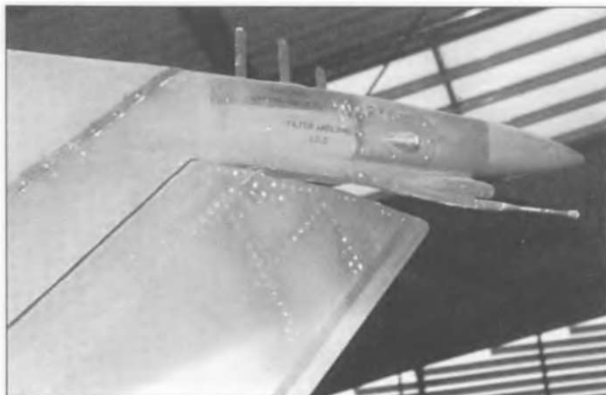
На киле располагалось большое количество антенн различного назначения. Прежде всего это диэлектрическая панель радио Р-802, потом трехсоставная система СРО-2 «Хром», а затем антенна СПО-10 «Сирена».
