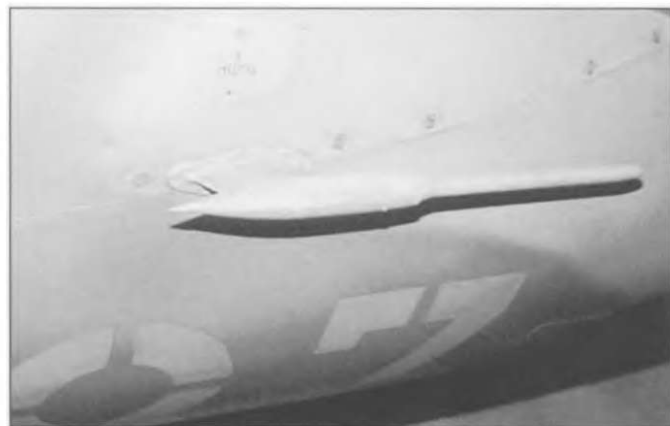
Вспомогательный датчик воздушного давления находился на правой стороне фюзеляжа МиГ-21МФ. Датчик располагался сразу за воздухозаборником, чтобы повысить точность измерений.
