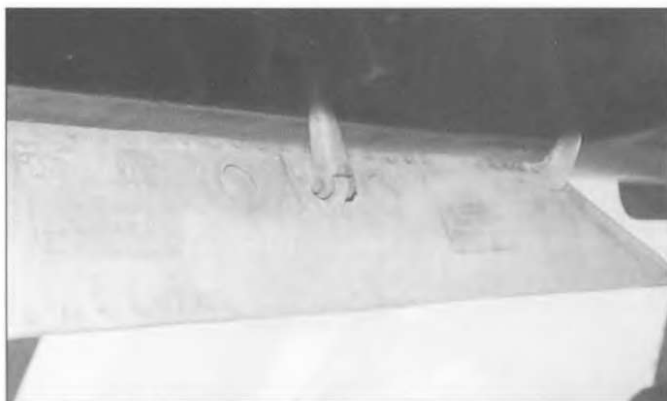
Левая створка основного шасси: на МиГ-21МФ. Обычно створки закрывались механически, однако в экстренных случаях использовалась пневматика. Сама стойка убиралась гидравликой.
