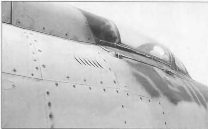
На МиГ-21М отсутствовало зеркало заднего вида ТС-27АМШ, что было типично для модификаций МиГ-21СММ. Небольшие воздухозаборники за кабиной были только справа.
