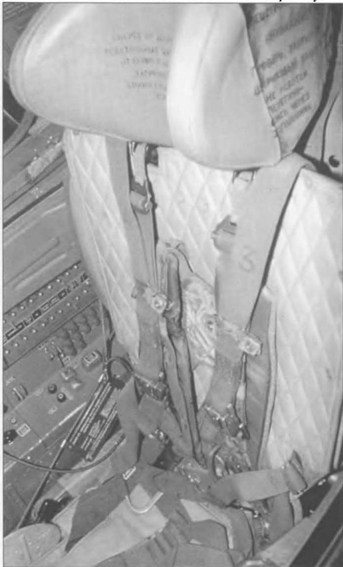
На катапультном кресле КМ-1М сложная система пристяжных ремней, которые обычно были серыми. С их помощью летчик надежно закреплялся во время катапультирования.
