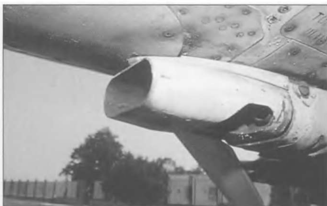
23-мм пушка ГШ-23Л устанавливалась посредине нижней части фюзеляжа. МиГ-21СМ\М стали первыми в ряду МиГ-21, которые были вооружены таким оружием. Только на ранних МиГ-21П\ПФ\М стоял подвесной контейнер ГП-9. За пушкой находился боекомплект. Длина пушки – 153,7 см.
