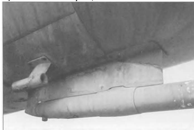
Район крепления ПВД на МиГ-21Ф и Ф-13. Справа от ПВД - датчик температуры, связанный с РЛС СРД-5м «Квант».
