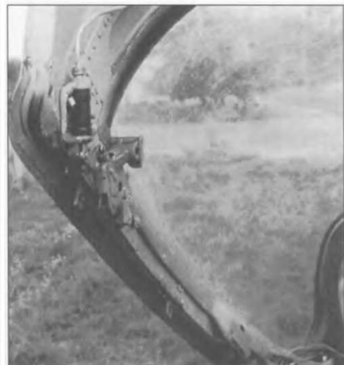
Система фиксации фонаря МиГ-21 первых модификаций. Правый и левый механизм идентичны.
