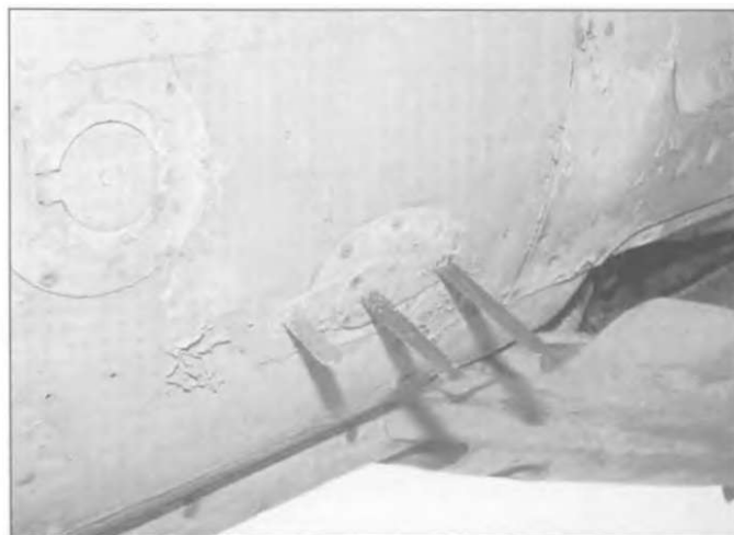
Другой вид на антенну СРО-2, установленную на МиГ-21Ф-13. На последующих модификациях ее перенесли с фюзеляжа.
