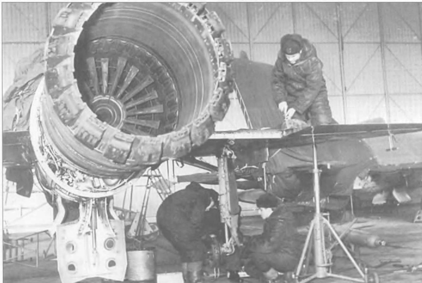
Тот же польский МиГ на ремонте. Киль уже снят. Контейнер тормозного парашюта открыт. Практически все панели открыты.
