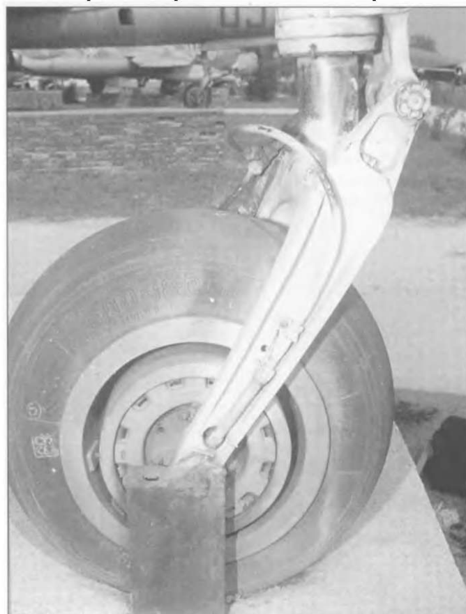
Хорошо видны отличия правого и левого щитков. Посредине смонтированы антенны СРО-2. Причем такая система монтировалась только на самолетах, предназначенных для СССР и стран Варшавского договора - на экспортных машинах ее демонтировали.
