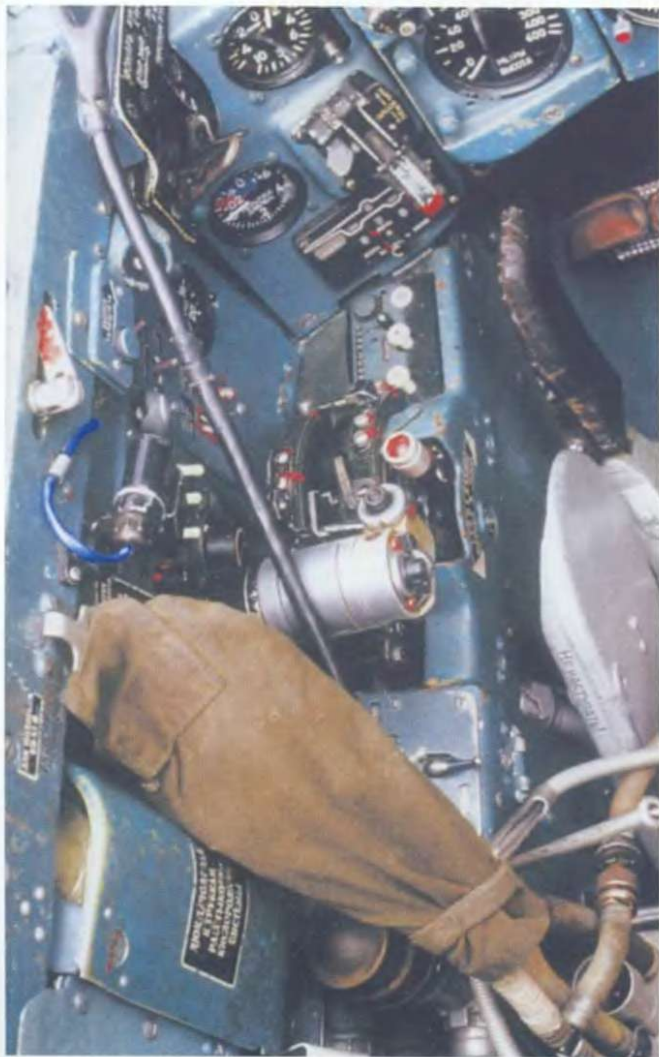
Слева в задней кабине МиГ-21bis стояла рукоятка управления двигателем. Все остальные приборы находились на том же месте что и у истребителей МиГ-21. Упакована система подключения кислородной системы, которая подключалась непосредственно перед полетом.
