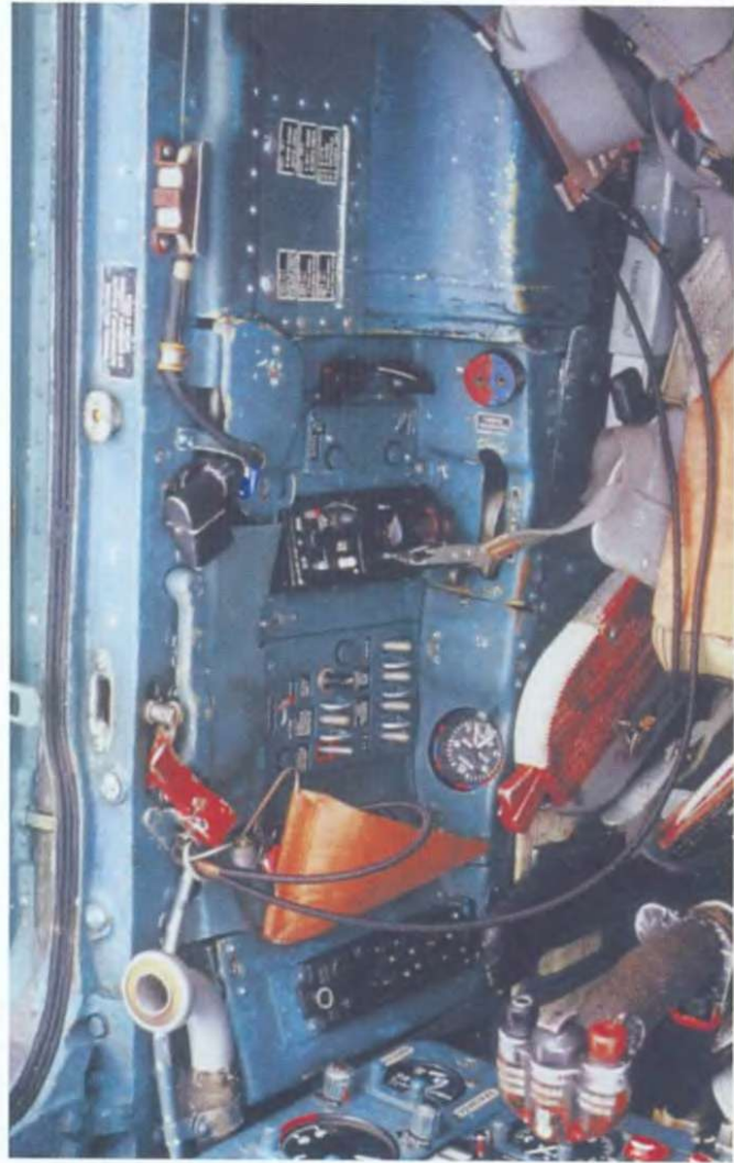
Большинство переключателей радио и навигационного оборудования стояло на правой консоли МиГ-21bis. Хорошо видны кабели подключения внутренней связи, с помощью которой инструктор общался с курсантом. Вентилятор в правой части приборной доски является крайне нестандартным элементом для учебных МиГов. Инструктор контролировал действия подопечного с помощью зеркала переднего обзора.
