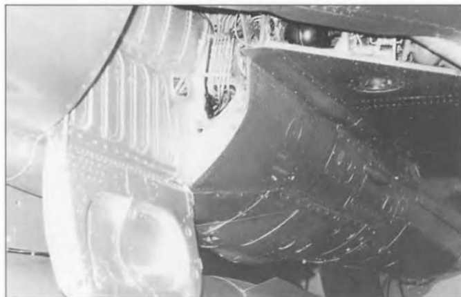
Ниша для уборки левой стойки шасси. Хорошо видны различия с правой, в частности баклажка системы аварийного складывания шасси. На этом МиГ-21Ф-13, покрашенном в цвет натурального металла ниша тоже покрашена также. База МиГ-21Ф-13 составляла 4806 мм.
