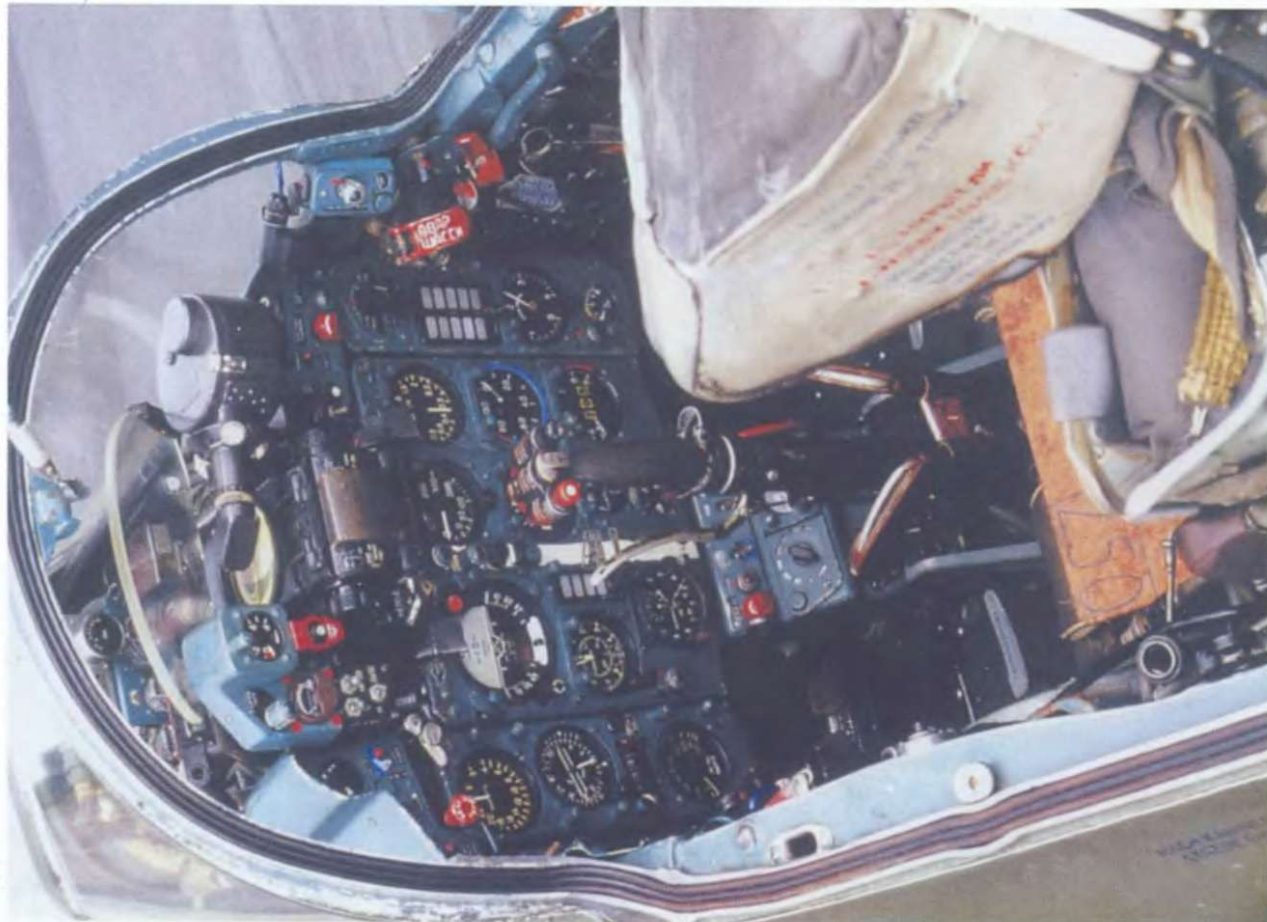
Инструкторское место МиГ-21УС было аналогичным по оснащению переднему. Каждая кабина имела собственный фонарь, который открывался вправо. Как правило внутри кабины МиГ-21УС красилась в голубой Pale Peacock Blue.
