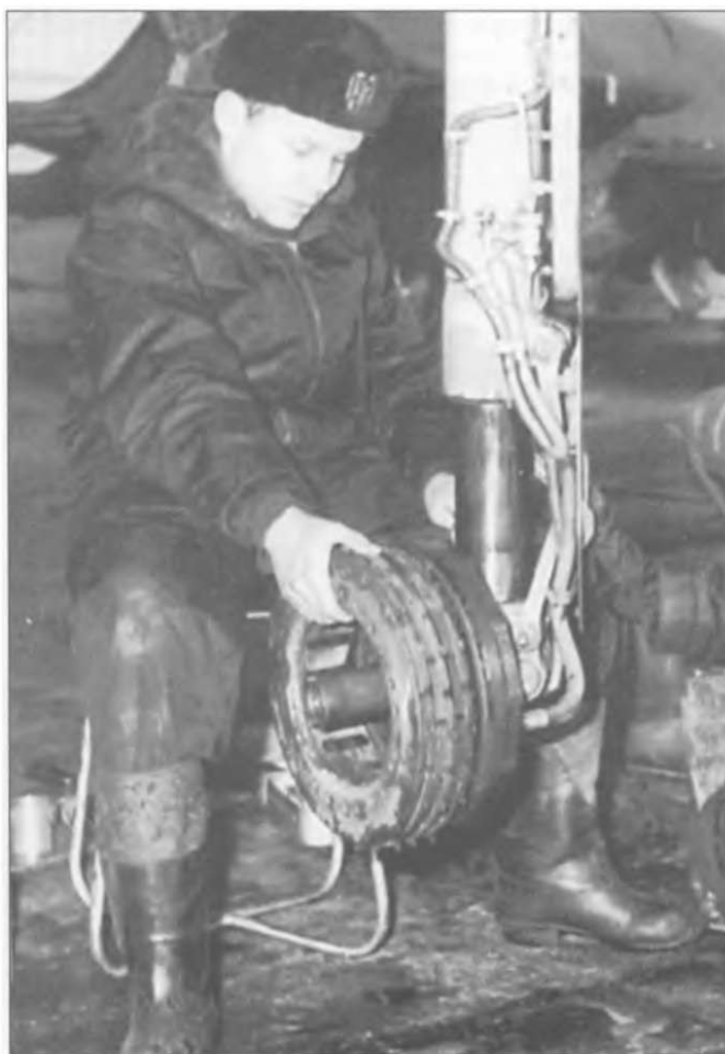
Польские техники меняют покрышку на основной стойке КТ-92. Сама покрышка лежит рядом. Видны кабели пневматической и электрической систем.
