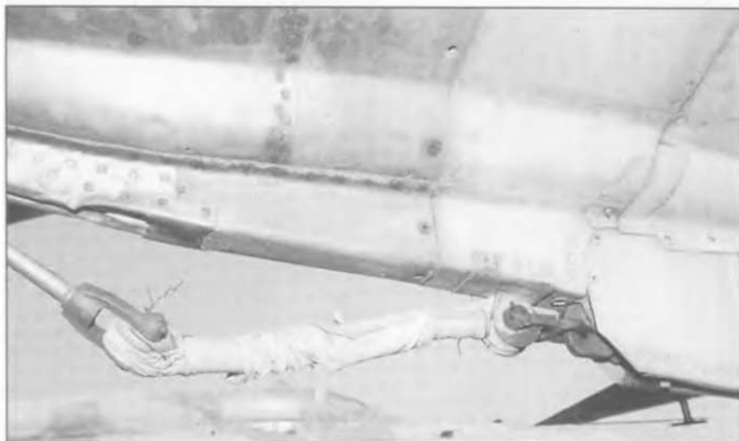
Система крепления тормозного парашюта на МиГ-21Ф-13. Очень часто при посадке пилот терял этот крюк.
