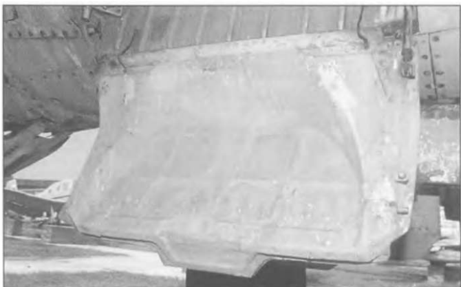
Открытые створки правого шасси. По сравнению с МиГ-21Ф-13 его конструкция была изменена, в частности из-за того что использовались увеличенные шасси.
