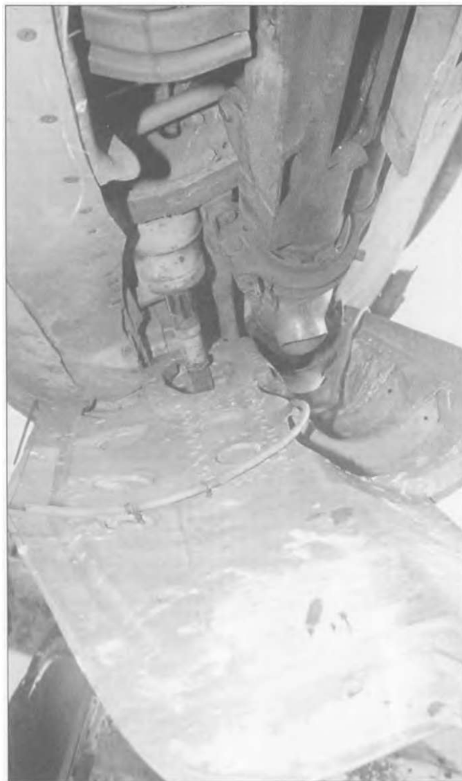
Устройство воздушных тормозов на МиГ-21Ф-13. Они использовались прежде всего при посадке. Обычно они оставались цвета натурального металла или окрашивались в тот же цвет, что и нижние поверхности - в данном случае светло-голубой. Этот МиГ-21Ф-13 («белая 501») из экспозиции Музея Авиации и Космонавтики на авиабазе «Крумово» около Пловдива (Болгария).
