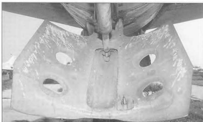
Система крепления тормозного парашюта на МиГ-21Ф-13. Очень часто при посадке пилот терял этот крюк.
