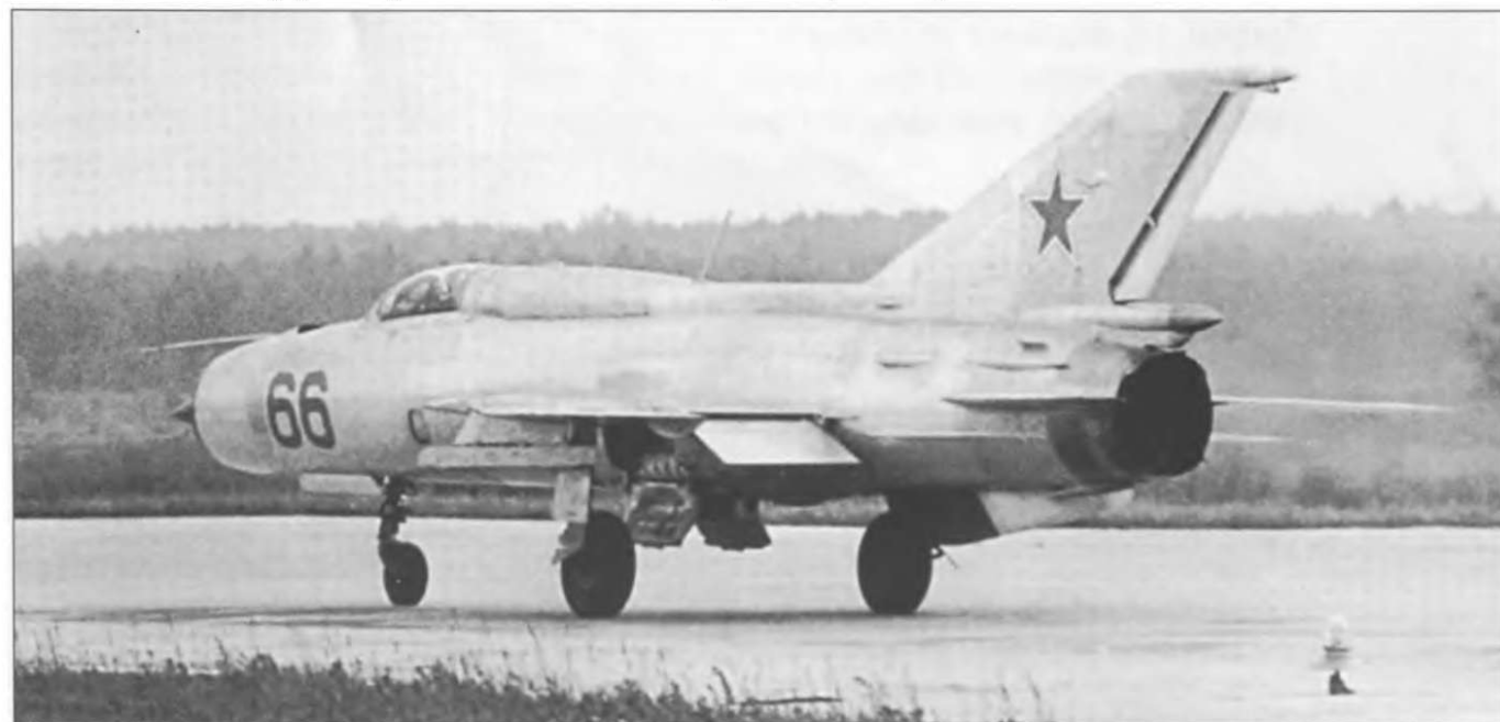
МиГ-21ПФ («голубая 66») поздних серий ВВС СССР готовится к вылету. На этом суб-варианте стоит контейнер тормозного парашюта ПТ-21УК. На стандартных машинах такого не было.
