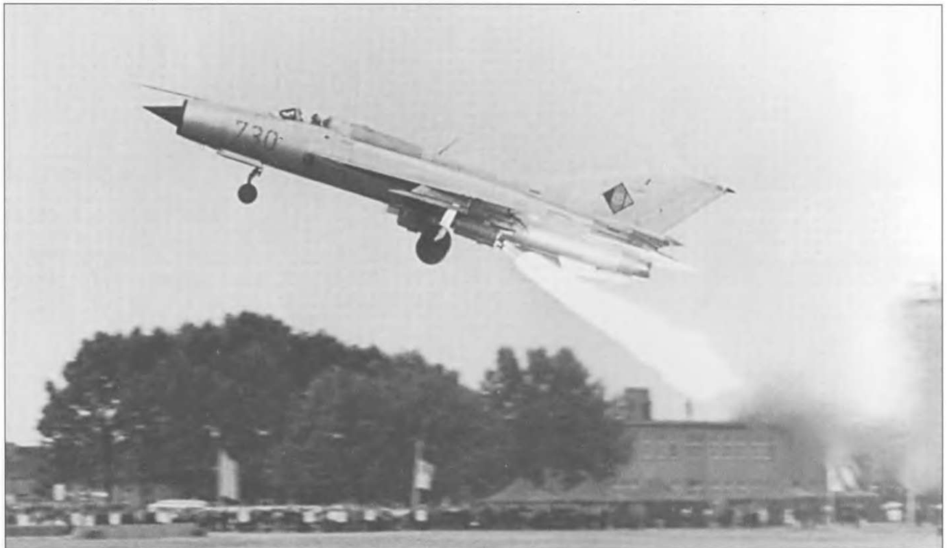
Восточногерманский МиГ-21ПФМ («красный 730») серийный 4214) взлетает с полевого аэродрома с помощью двух ракетных ускорителей РАТО. Использование таких ускорителей уменьшало длину необходимой взлетной полосы на 200 метров. Самолет из состава Jagdfliegergeschwader 8 "Hermann Matern". Сама фотография сделана на авиационном празднике в Магдебурге 18 августа 1968 года. Самолет разбился 30 мая 1980 года, летчик Геральд Лиебке погиб.
