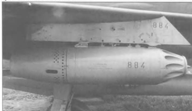
Блок НАР УБ-16-57 подвешенный под правую плоскость восточно-германского МиГ-21Ф-13. В этом блоке находилось 16 57-мм НАР С-5. Каждая ракета была длиной от 830 мм до 1079 мм и массой от 3,6 кг до 5 кг в зависимости от варианта. Скорость вылета С-5 варьировалась от 450 м/с до 725 м/с.
