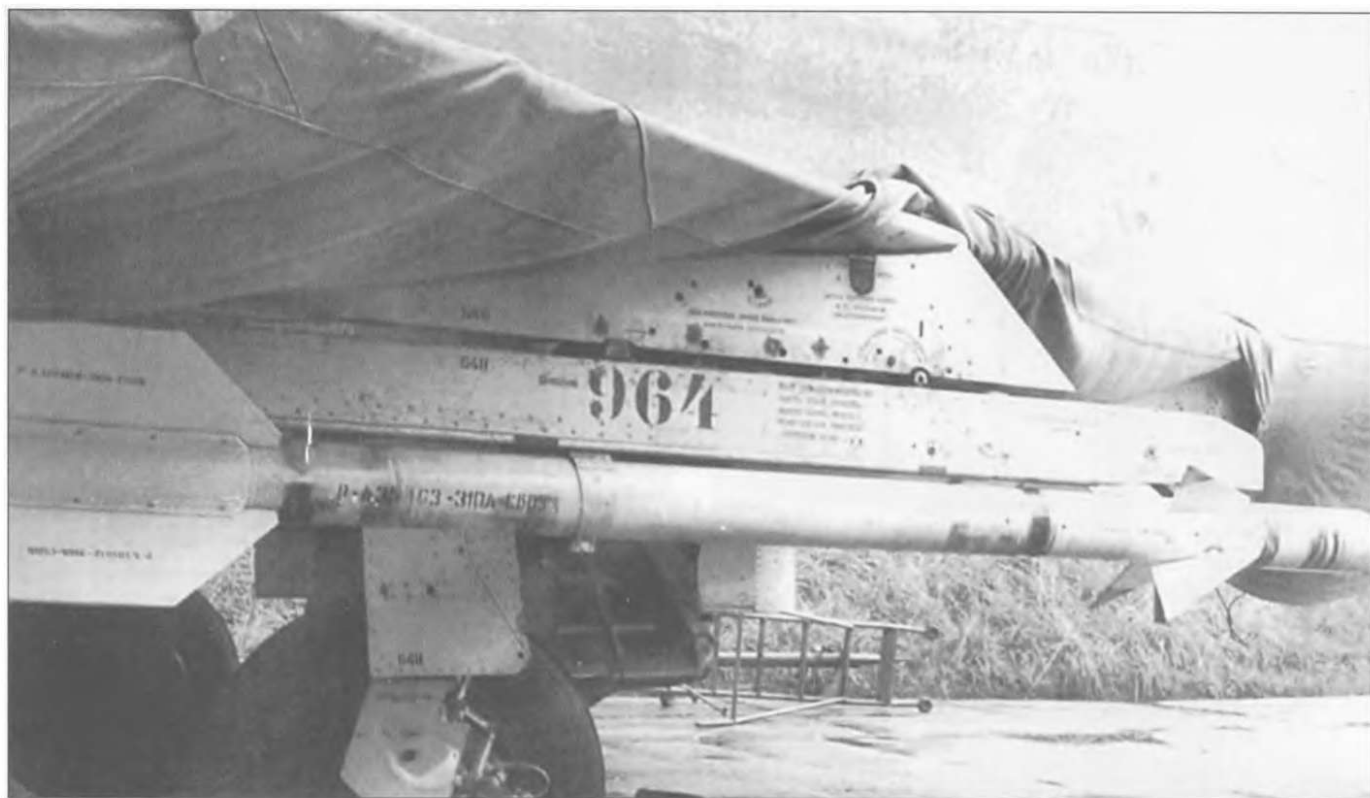
УР ближнего боя Р-3С (по НАТОвской терминологии АА-2 Atoll) на АПУ-13. На левой стороне ракеты черным написан ее серийный номер - Р-А30103-310А-СВ05. Р-3С представлял собой нелегальную копию американской AIM-9 Sidewinder. Ее длина составляла 2838 мм, диаметр 127 мм, масса - 73,5 кг (из них БЧ - 9,5 кг).
