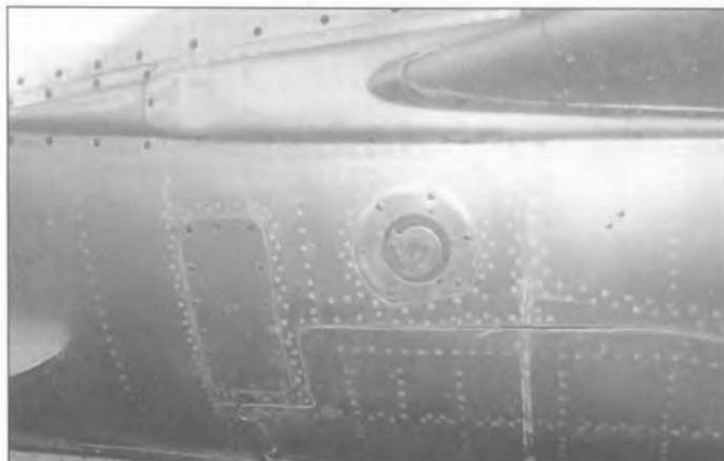
На МиГ-21 второго поколения внешнее электричество подключалось с помощью специального штекера на левой стороне фюзеляжа. Чаще всего с помощью электричества запускали двигатель на земле, таким образом экономя заряд аккумуляторов. На ранних МиГ-21Ф-13 разъем располагался не на этом месте, а вот на последующих модификациях тут же.
