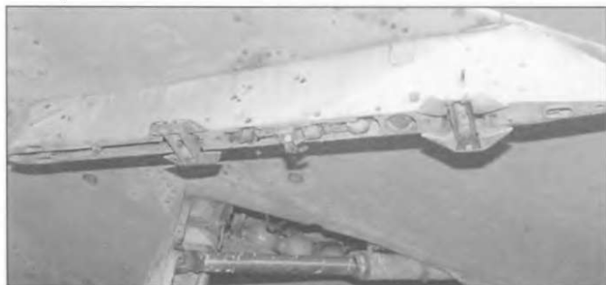
Подкрыльевые пилоны монтировались в районе основного шасси. Этот пилон не был предназначен для подвески топливных баков. Прежде всего это ракеты Р-3С и блоки НАР УБ-16-57.
