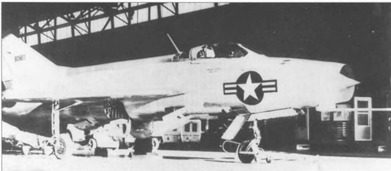
Американцы испытывали бывший иракский МиГ-21Ф-12 (68-0965; ex- «черная 534») на авиабазе «Грум Лейк» в Неваде. Черный номер 80965 написан на вертикальном стабилизаторе. В носу смонтирована антенна навигационной системы ТАКАН. Израильтяне передали самолет США в конце 1967 года.
