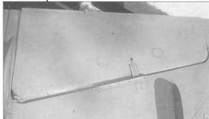
Гидравлическая система БУ-45А обеспечивала на МиГ-21ПФМ отклонение закрылков на \pm 20 градусов.
