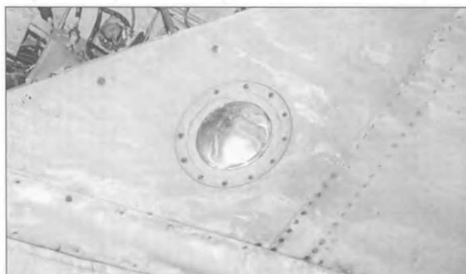
Под каждым крылом монтировался посадочный фонарь. Благодаря этому пилот ориентировался при посадке и рулежке.
