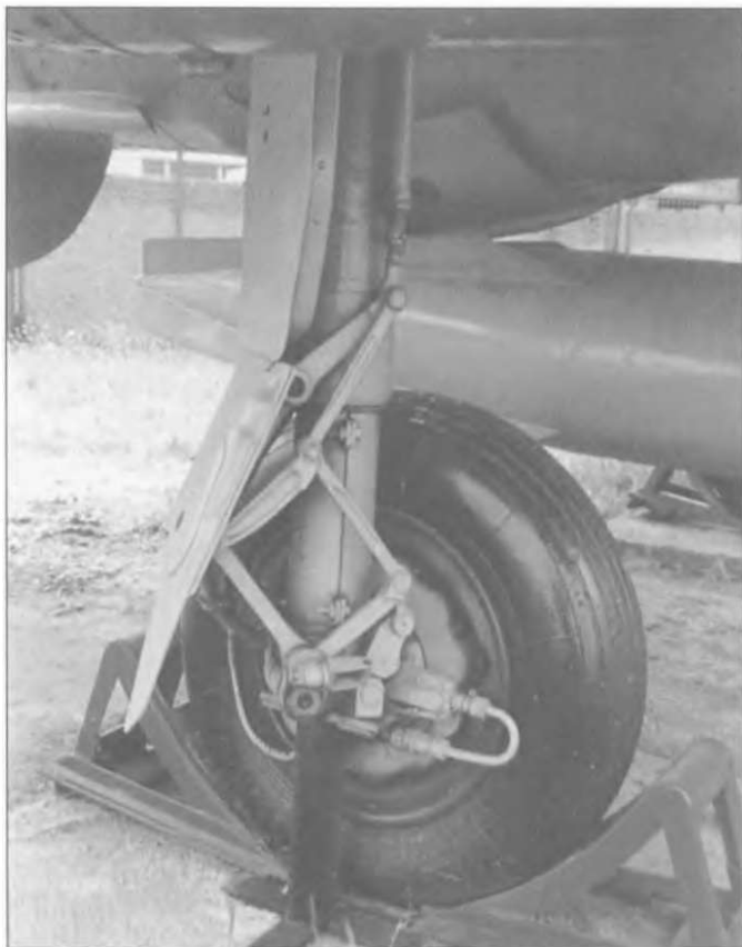
При уборке и выпуске основного шасси стойка поворачивалась на 87°. За это отвечала специальная механическая система, получившая название «параллелограмм». Кроме того, на каждой стойке монтировалась анти-опрокидывающаяся система УА-24.
