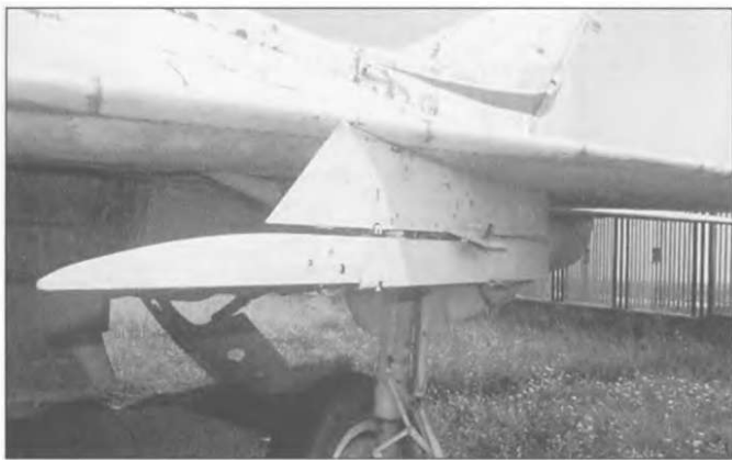
Пилон для пуска ракет АПУ-7 хорошо виден на этом болгарском МиГ-21ПФ. Он использовался для запуска УР РС-2УС или Р-3С.
