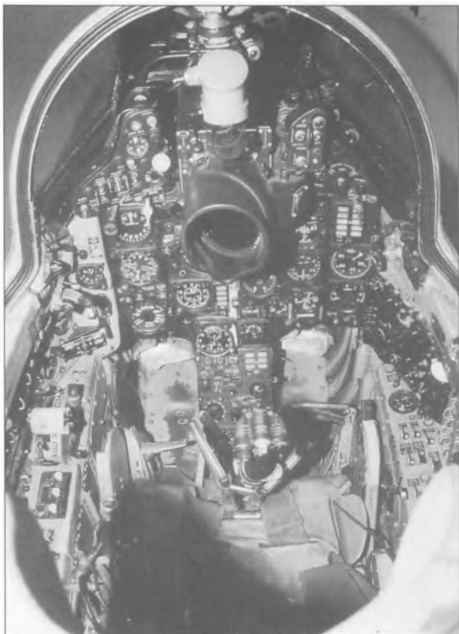
Кабина МиГ-21ПФМ была идентична МиГ-21ПФ. В центре располагался экран РП-21МА «Сапфир». Все кожаные элементы кабины имели цвет приблизительно Sapory Seal Brown (FS20257).
