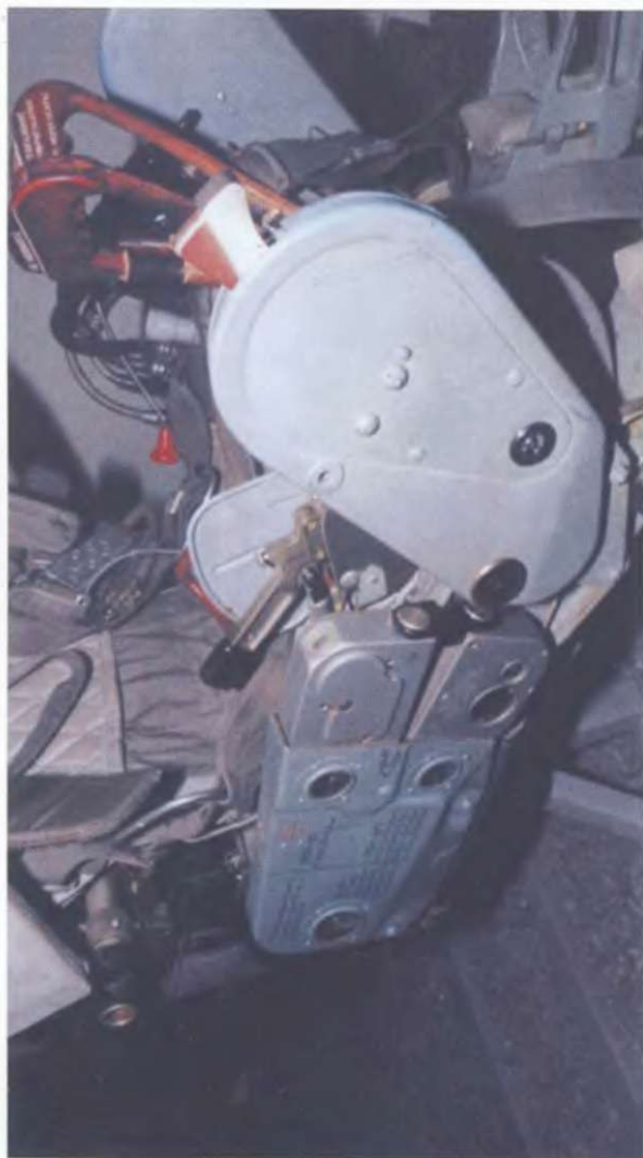
На катапультном кресле КМ-1 справа была смонтирована автоматическая система принудительного отделения. Она обеспечивала отделение пилота на безопасном от падающего самолета расстоянии. Обратите внимание на серебристую ручку ручной системы, которая была резервной на случай не срабатывания автоматической.
