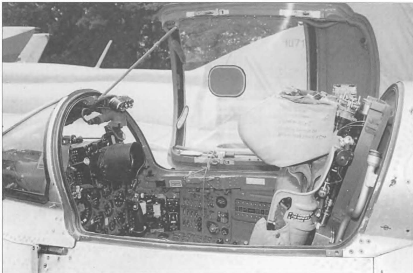
Два задних зеркала на фонаре МиГ-21ПФМ. Этих зеркал не было на ранних МиГах. На данном самолете также смонтировано зеркало заднего вида ТС-27АМШ. Кроме того, это ранний вариант МиГ-21ПФМ, так как на самолете стоит катапультное кресло КМ-1.
