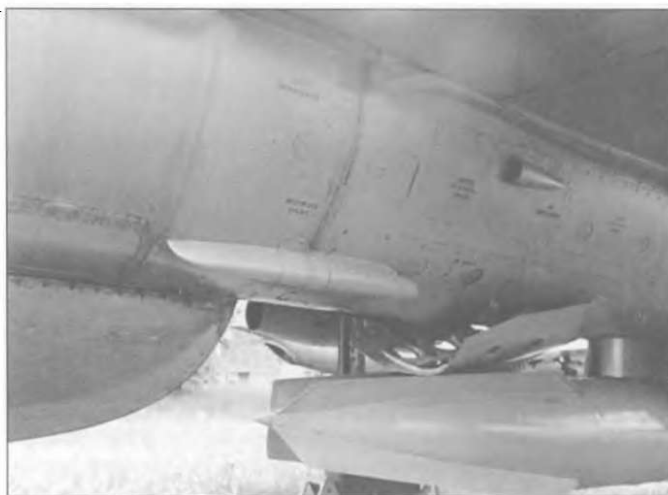
Подвеска топливного бака на 490 литров на восточногерманском МиГ-21Ф-13. Ввиду невозможности использовать центральный щиток, использовали два фюзеляжных.
