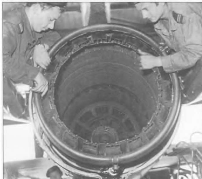
Разборка двигателя Р-11Ф2С-300. По всей видимости это плановая проверка.
