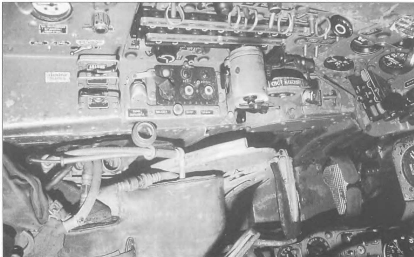
Рукоятка управления двигателем Р-11Ф2С-300 находилась на левой консоли. Тут же располагались ручки управления радиостанции Р-802В. Тут же также находилось управление ЛАС-1 и системой управления давлением МК-16.
