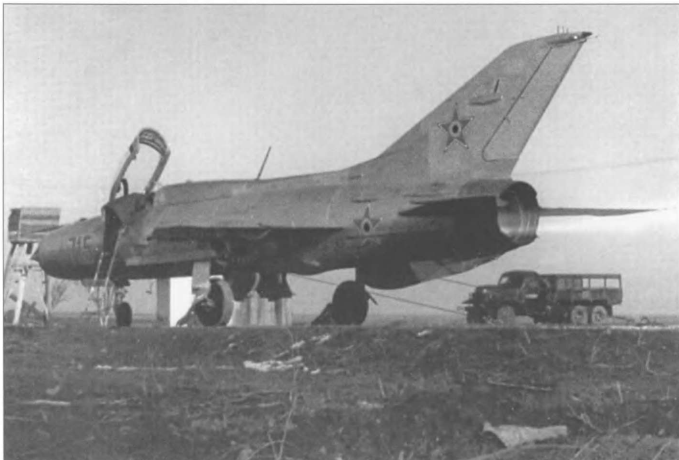
МиГ-21ПФ («красный 715») серийный 760715) проходит проверку двигателя перед взлетом. Для экономии аккумуляторов запуск осуществлялся с спецмашины.
