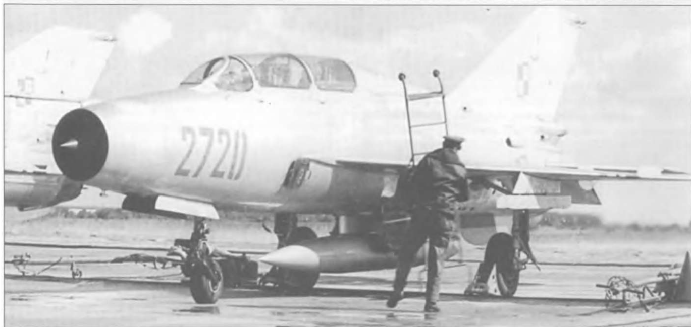
Вылет польского МиГ-21У-600 («красный 2720»)серийный 662720). На этом самолете контейнер тормозного парашюта установлен на нестандартном месте, нет и зеркала заднего вида. В руках техника лестница, по которой летчики забирались в самолет.
