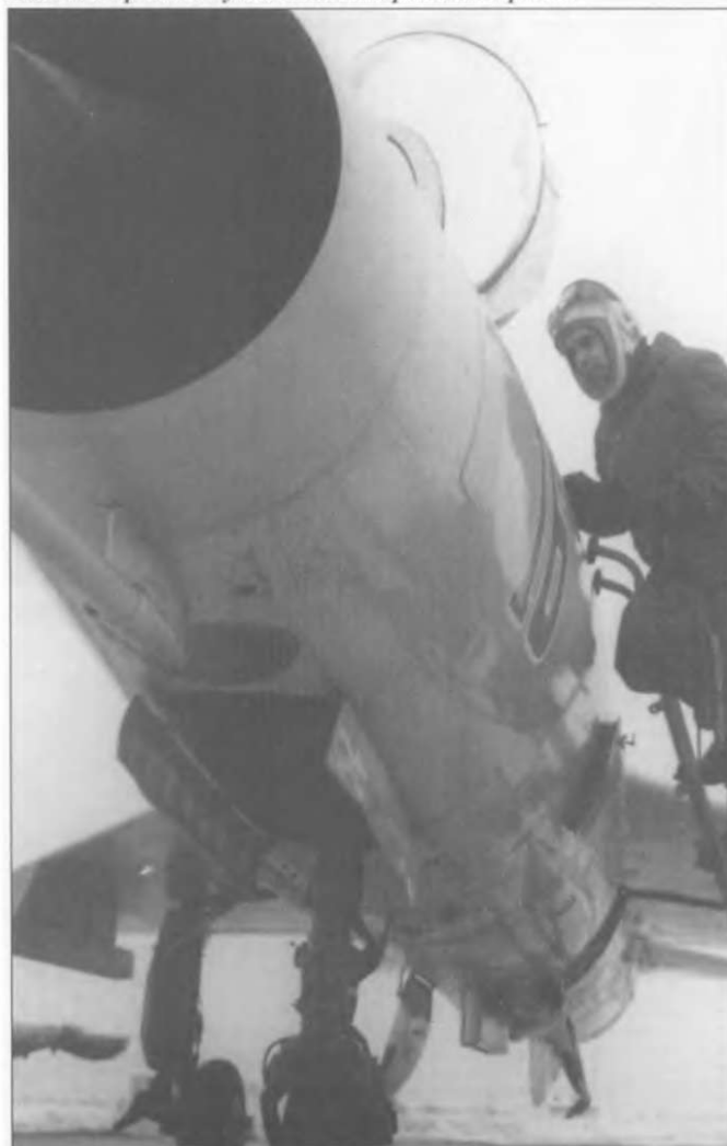
Румынский летчик занимает свое место в МиГ-21Ф-13. На нем белый шлем ГШ-4МС для полетов на больших высотах. Номер красный с белой обводкой. Хорошо виден АРК-10, который окрашен в зеленый Radome Green (FS24108).
