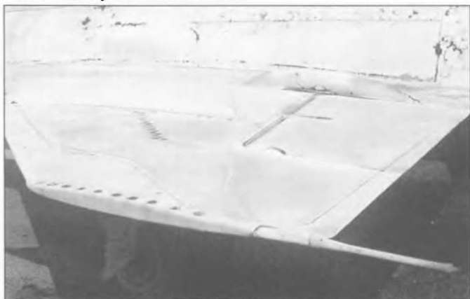
Законцовка крыла МиГ-21ПФ. Такая конструкция позволяла более эффективно контролировать самолет на малых высотах.
