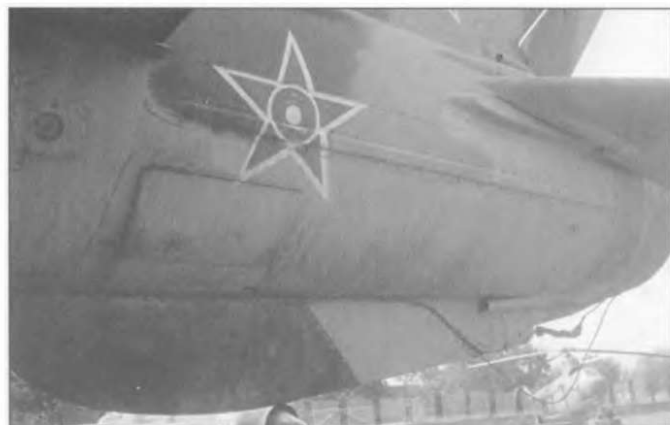
На этом болгарском МиГ-21Ф-13 контейнер укладки парашюта расположен слева.
