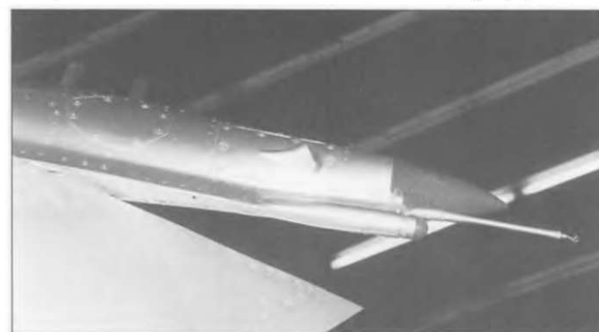
Законцовка кия МиГ-21Ф-13 была темно-зеленой. Тут располагалась антенна СОД-57М. Блистер перед системой СОД-57М монтировался только на экспортных МиГах, на которых не была система «Сирена» 2.
