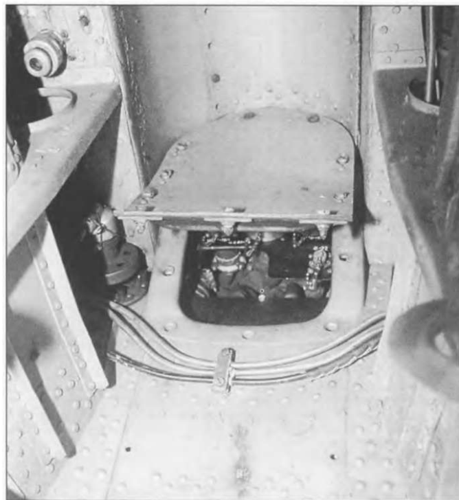
Отсек установки РЛС РП-21 «Сапфир». Для этого конструкторам пришлось переделать носовую часть МиГ-21Ф-13. Это хорошо видно на этом болгарском МиГ-21ПФ.
