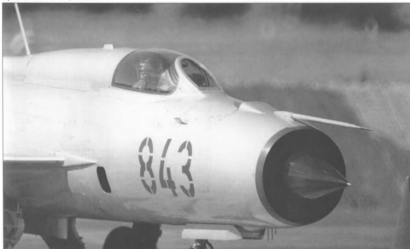
МиГ-21ПФ («красный 843»/761005) рулит по аэродрому. Хорошо видна установка РЛС РП-21 «Сапфир». Антенна ПВД перенесена на верх фюзеляжа. Антенны системы опознания «свой-чужой» находятся перед носовой стойкой. МиГ-21ПФ не нес никакого внутреннего вооружения, хотя некоторые самолеты были приспособлены для использования подвешного пушечного контейнера ГП-9 со спаренной 23-мм пушкой ГШ-23 и 200 снарядами. На пилоте шлем ЗШ-3 и кислородная маска КМ-32. Самолет из состава Jagdfliegergeschwader 8 "Hermann Matern", авиабаза Марксвальде, 1 мая 1965 года. После снятия с вооружения МиГов этой модификации правительство ГДР планировало продать их Ирану. Помешало этому объединение Германии 3 октября 1990 года. Иранцы хотели вооружить мигами авиационные части КСИР («стражей исламской революции»).
