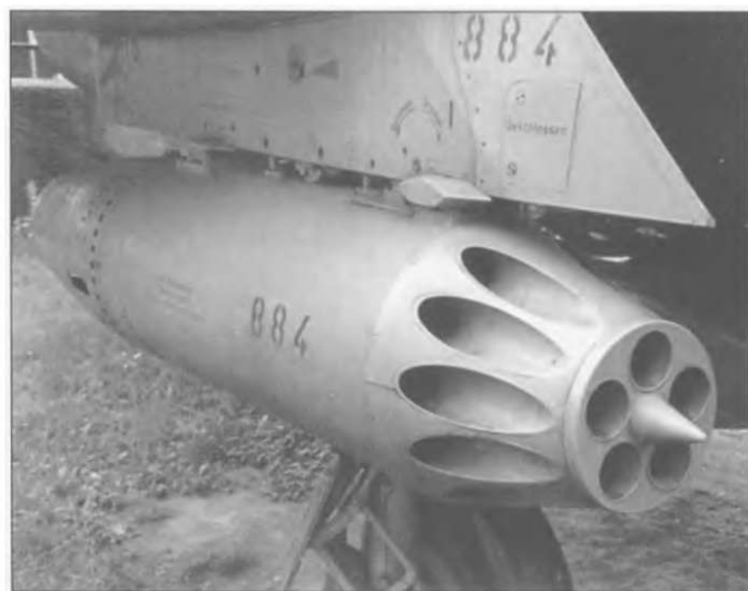
Каждый блок УБ-16-57 подвешивался к пилону в шести точках. Тактический номер (884) продублирован как на пилоне, так и на самом блоке. Задняя часть блока снималась для перезарядки.
