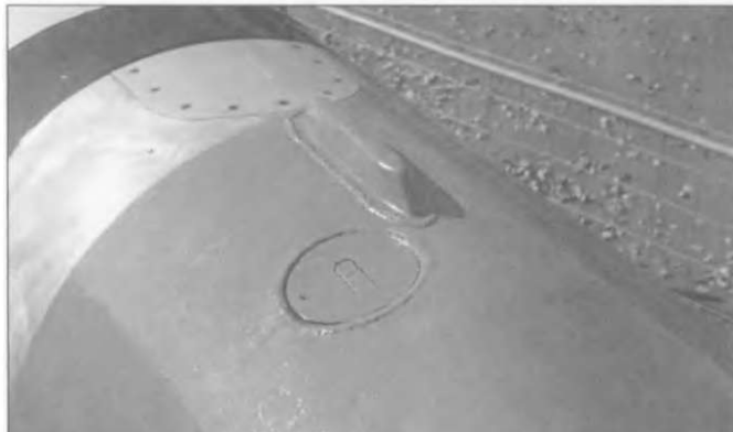
Центральная горловина для заливки топлива на МиГ-21ПФМ. Она находилась сразу возле кабины. На самолетах третьего поколения она была перенесена. Назначение центрального блистера неизвестно.
