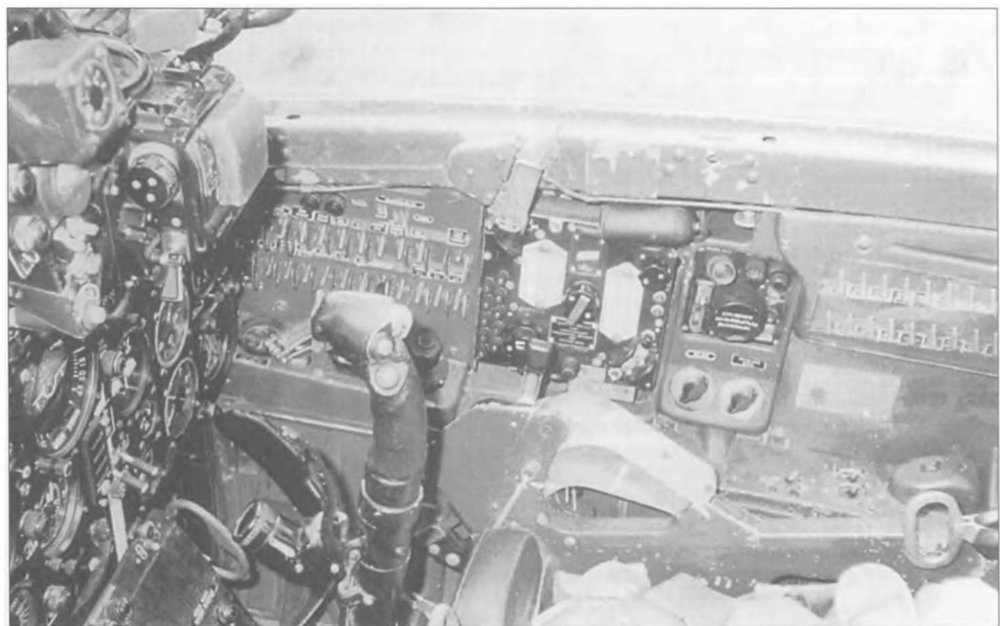
Хорошие фото кабины МиГ-21Ф-13. В передней части находится прицел АСП-5НО, рядом фотокинопулемет АКС-5. Вся приборная панель покрашена черным. Обратите внимание на отсутствие дисплея РТС, характерного для поздних МиГов. Большинство систем управления электричеством самолета находились на правой консоли. В центре контроль АРК-10. Контрольная панель была сделана из черного пластика. Ручка управления двигателем находилась на МиГ-21Ф-13 слева. На ручке находилась белая кнопка для включения радио Р-802В. Внутренняя часть большинства ранних МиГ-21 красилась в серый Console Gray (FS26176).
