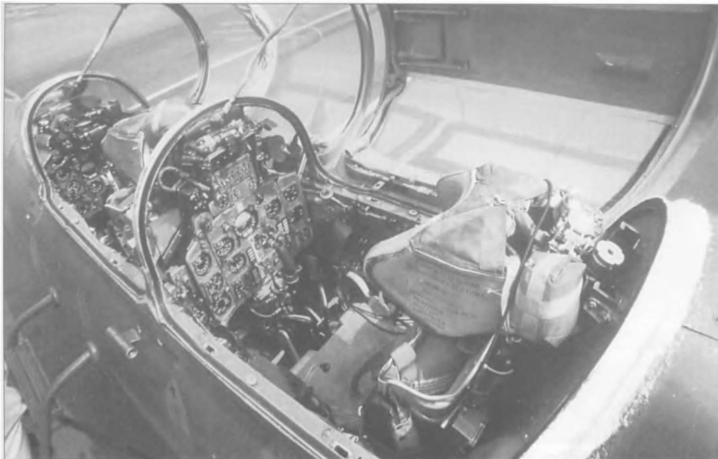
На МиГ-21УС перископ монтировался посредине фонаря. Под фонарем стоит трубка Вентури.
