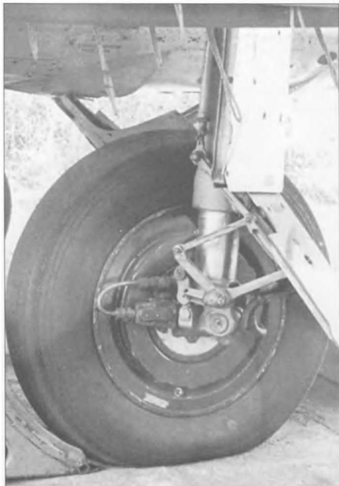
Фотография крупным планом КТ-92 на восточногерманском МиГ-21ПФМ («красный 841»\серийный 5113). Обычно покрышки менялись после 30 посадок.
