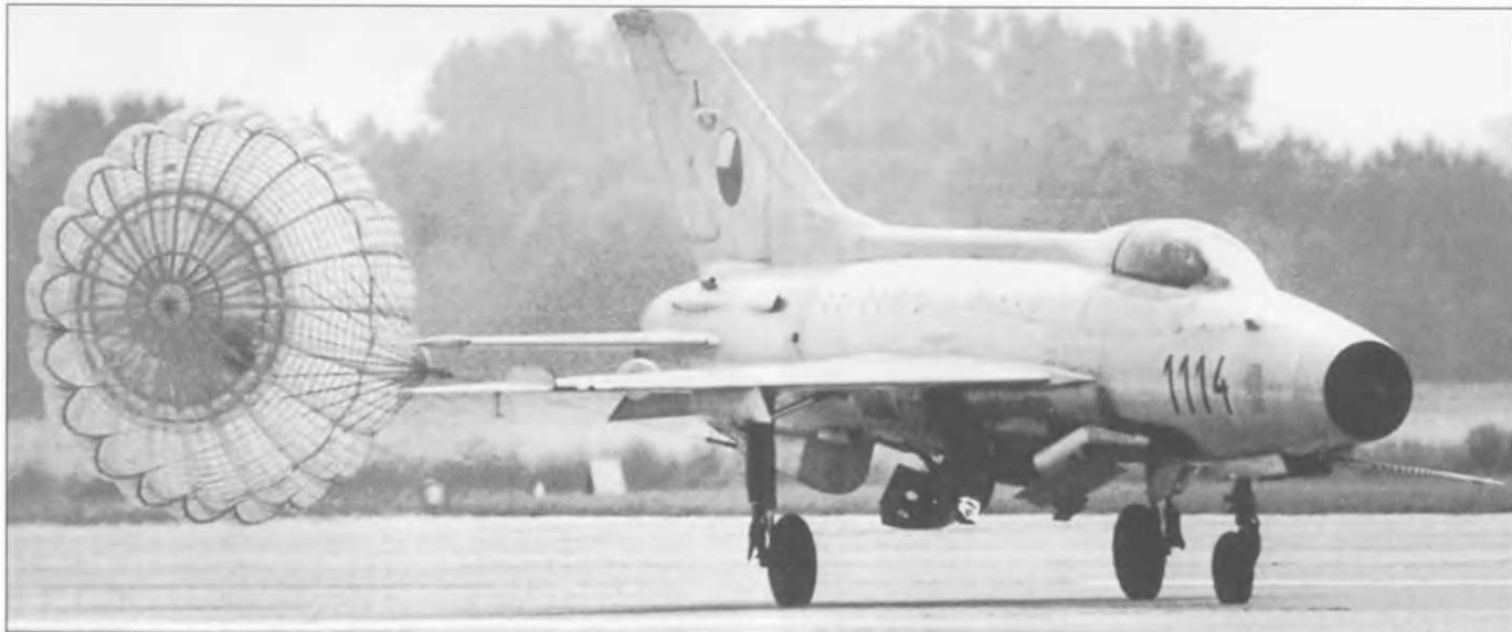
Посадка МиГ-21Ф-13 («черный 114») ВВС Чехословакии. Тормозной парашют площадью в 16 м 2 крепился в трех точках и складывался в контейнер ПТ-21 в хвостовой части. Интересно, что этот номер после списания этого самолета использовался на МиГ-21 следующих модификаций.
