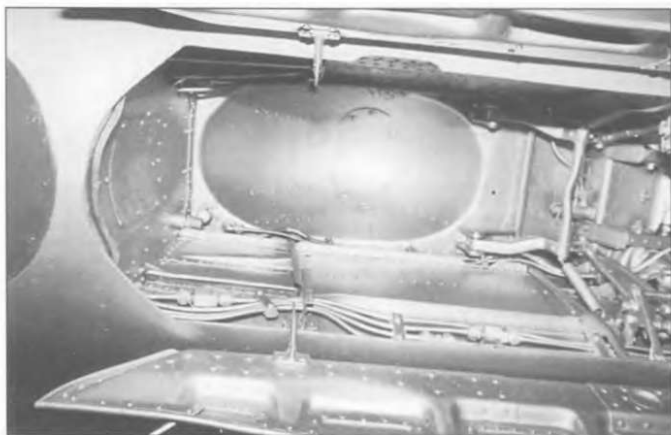
Еще один вид на внутреннюю нишу носового шасси. Углубление предназначено для КТ-38.
