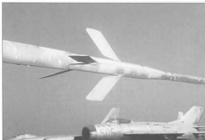
Устройство ПВД на МиГ-21Ф-13. На МиГ-21ПФ и ПФМ их не было, зато были на МиГ-21 РСММ/МФ. На заднем плане виден МиГ-19П («506»), выведенный из состава ВВС Болгарии.
