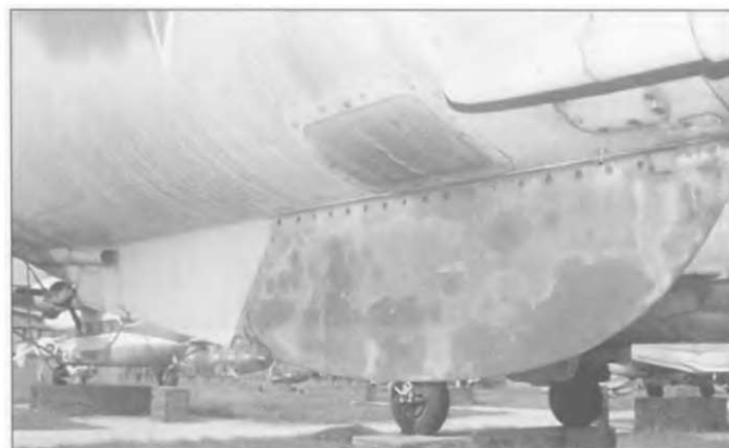
Правая сторона МиГ-21Ф-13 представляла собой зеркальное отражение левой. Небольшая фибростеклянная панель закрывала расположение приемника радио МРП-56П. Приемник располагался только на правой стороне фюзеляжа.
