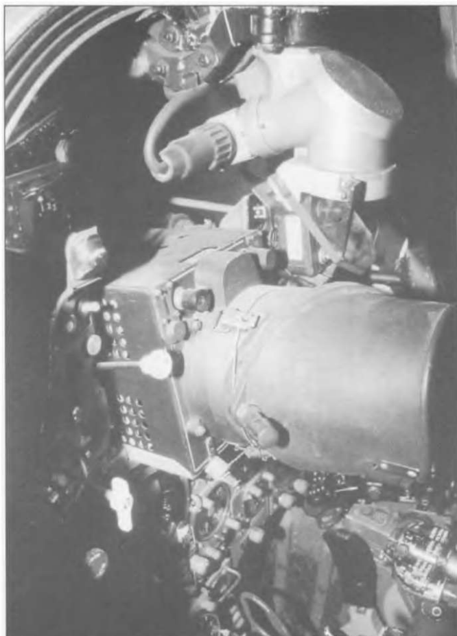
Экран РЛС РП-21МА «Сапфир», который располагался в центре приборной доски МиГ-21ПФМ. Во время дневных вылетов летчик пользовался тубой для того чтобы лучше рассмотреть метки на экране РЛС. Рядом смонтирован прицел АСП-ПФ-21.
