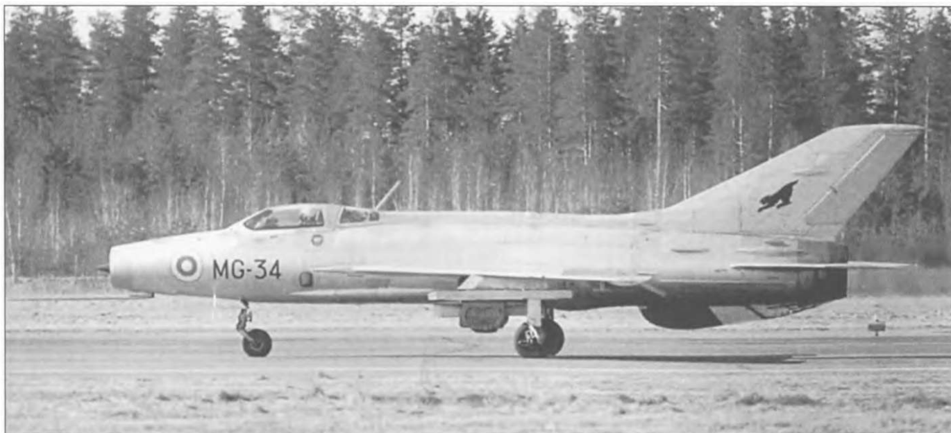
МиГ-21Ф-12 (MG-34/740404) из состава Havittajalentolaivue 31 ВВС Финляндии. Это был вариант МиГ-21Ф-13, лишенный системы опознавания СРО-2 «Хром» и СОД-57М. Последний финский МиГ-21Ф-12 был списан 17 января 1986 года.
