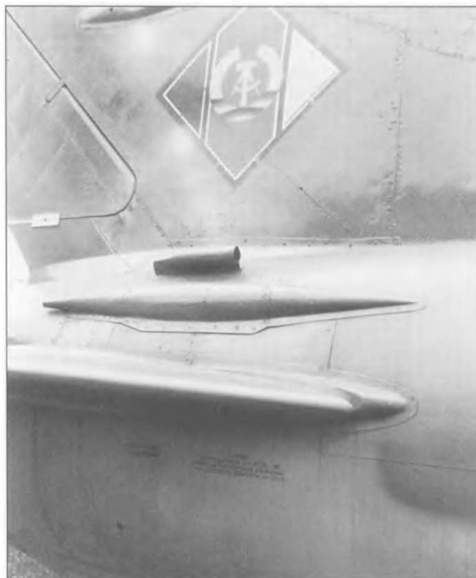
На этой фотографии восточногерманского МиГа хорошо видно расположение индикатора положения относительно земли ГИК-1. Основой прибора была гониометр, который вырабатывал электричество, которое во взаимодействии с магнитным полем земли и показывало положение самолета относительно земли. Самолеты МиГ-12Ф-12 поставлялись без этого прибора.
