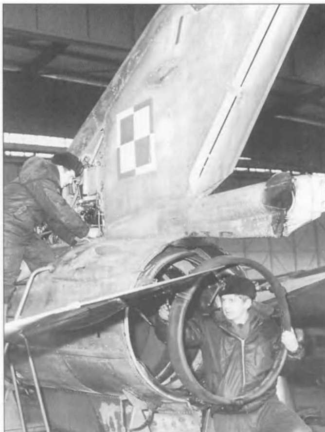
Капитальный ремонт польского МиГ-21ПФМ. Самолет стоит на козлах, так как видимо КТ-92 уже сняты.
