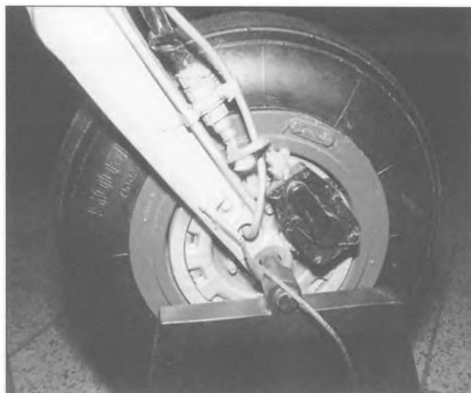
КТ-38 обычно комплектовались антипрокидывающимися сенсорами УА-24/2М-5. При рулежке такое колесо поворачивалось на 360 градусов. На этом восточногерманском МиГ-21Ф-13 внутренняя часть колеса окрашена синне-зеленым Blue Green (примерно FS25193), что было характерно для советских самолетов.
