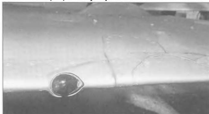
На МиГах первого и второго поколений в крыльях находились проблесковые огни. Вот такой красный на киле. Обычно приемник СОД-57М был темно-зеленый, а на этом музейном экземпляре почему то серебристый.
