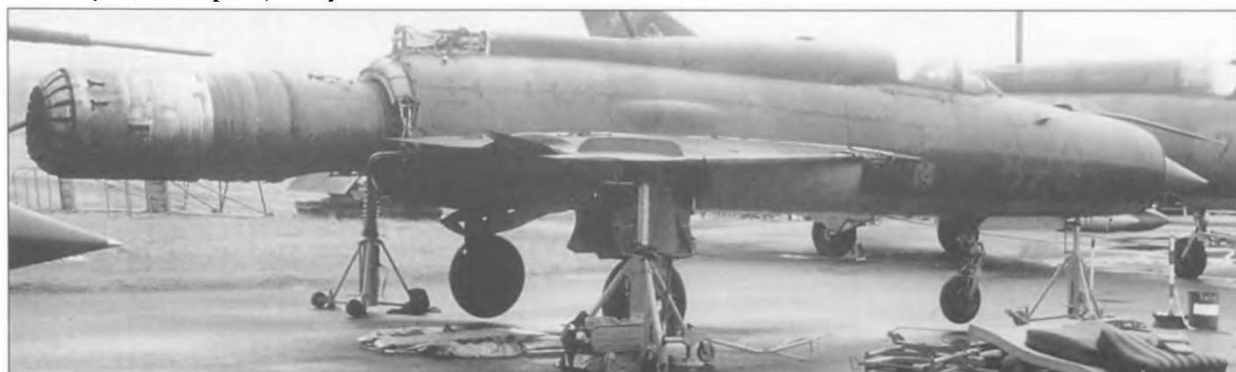
Схема снятия двигателя на всех МиГ-21 была одинаковой. Это хорошо видно на фотографии этого МиГ-21ПФМ («красный 829»), который находится на техническом обслуживании. На заднем плане виден Су-22М-4.
