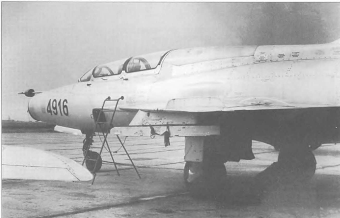
МиГ-21У («черный 4916»/серийный 664916) ВВС Чехословакии. Как на этом варианте, так и на МиГ-21УС отсутствовал сенсор перехода в критические углы атаки ДВА-3А, который монтировался в носу слева МиГ-21УМ. Сразу за фонарем располагался топливный бак (всего запас топлива на МиГ-21У составлял 2350 литров).
