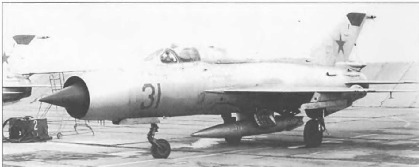
МиГ-21ПФМ («красный 31») ВВС СССР на одном из аэродромов. Это самолет поздней серии с зеркалом заднего вида ТС-27АМШ и зеленой панелью на киле радиостанции Р-802В.
