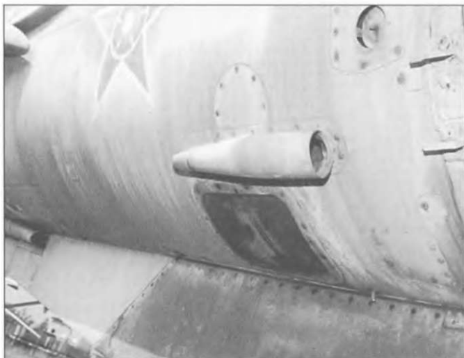
Антенна телеметрии РПЧ в задней части фюзеляжа этого болгарского МиГ-21ПФ. Зеленая фибростеклянная секция прикрывает передатчик МРП-56П.
