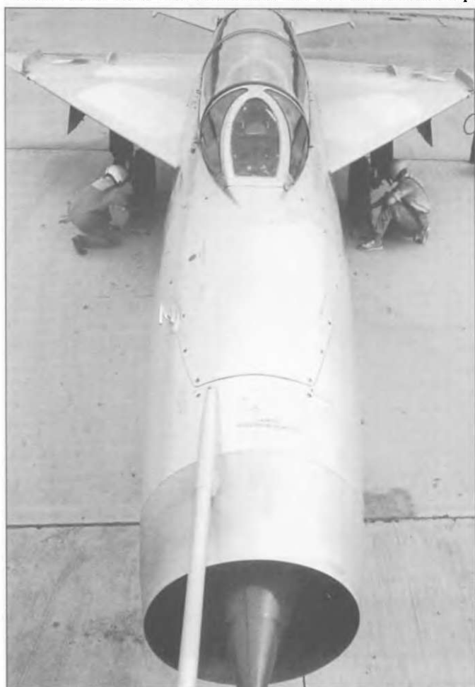
На всех учебных МиГ-21 трубка ПВД была смещена вправо. На этой фотографии хорошо виден большой отсек для доступа к авионике.
