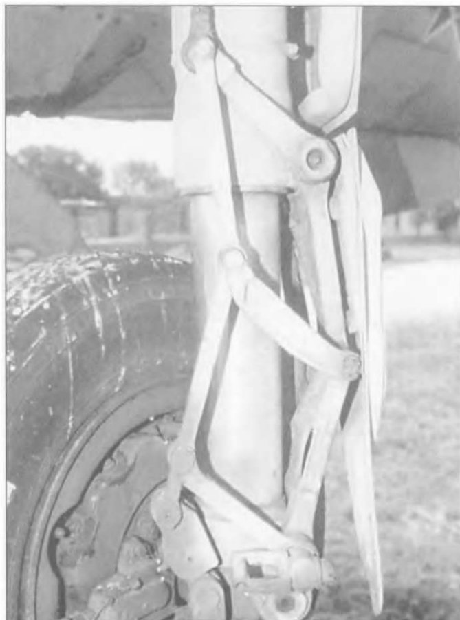
Установка механизма «параллелограмм» на КТ-27. Главной задачей была синхронизация уборки и выпуска стойки.
