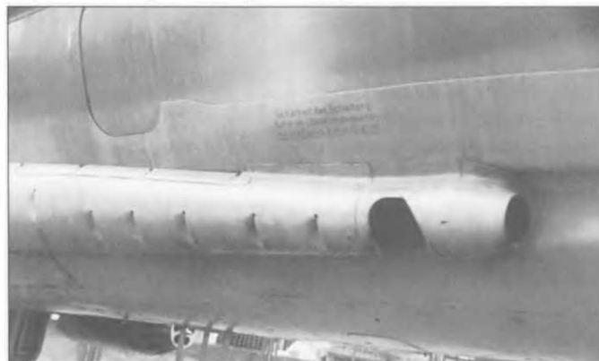
На МиГ-21Ф-13 справа стояла 30-мм пушка НР-30. На МиГ-21Ф стояли две такие пушки. На следующей модификации от второй пушки отказались в пользу авионики для запуска УР.
