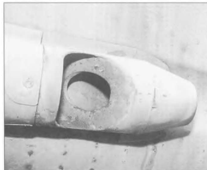
Устройство отвода газов на пушке НР-30. Сама пушка весила 66,5 кг и имела длину в 2158 мм. Она выпускала 410-граммовый снаряд со скоростью в 780 м/с. Скорострельность пушки составляла 900 снарядов в минуту. На вооружении ВВС она поступила в 1954 году.
