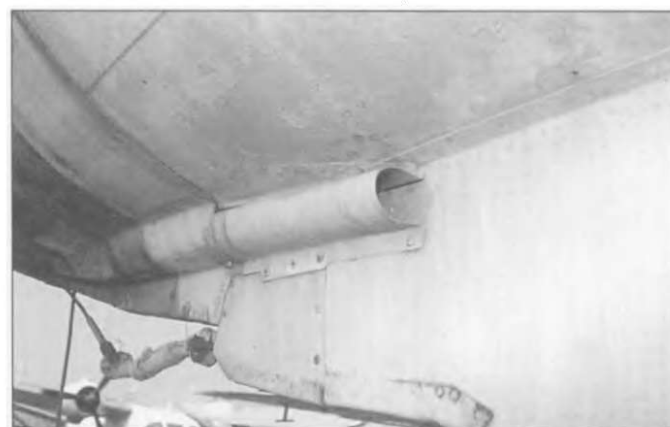
Система воздушного охлаждения двигателя Р-11Ф-300. Кроме того, сюда же отводились использованные газы при форсаже.
