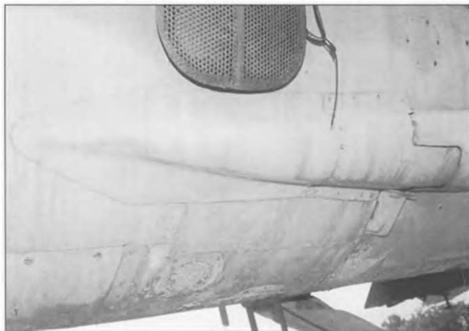
Левый тормозной щиток отличался по своей конструкции от правого. Вместо пушки по левому борту стояла авионика, необходимая для запуска и управления УР. На этом музейном аппарате правый и левый щиток поменяны местами, что было нехарактерно для строевых МиГов.
