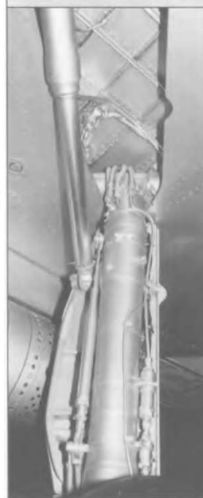
Ниша для уборки правой стойки шасси на МиГ-21Ф-13. Видны элементы гидравлической системы.
