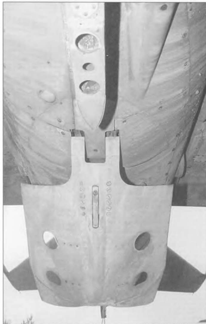
На этом снимке хорошо видно что при подвешенном топливном баке центральный воздушный тормоз не использовался. Потому как находился сразу за пилоном.
