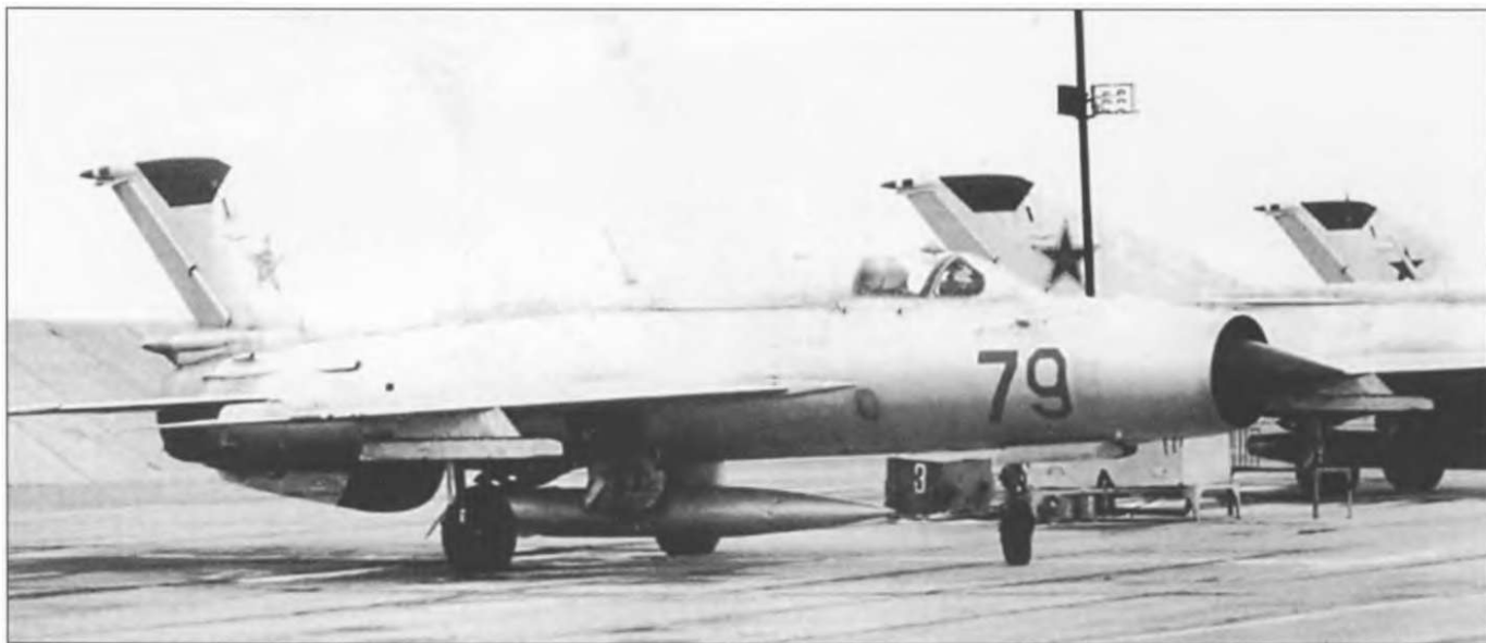
Еще один советский МиГ-21ПФМ («голубой 79») на стоянке. Опознавательные знаки сильно изношены, хотя на соседнем самолете такого не наблюдается. Подвешен топливный бак на 490 литров.
