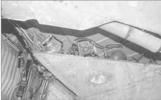
Кроме того на нижнем крыле монтировались проблесковые огни МПРФ-1А. Они монтировались на створках основного шасси и контролировались летчиком. На этом музейном экземпляре советские огни заменены на американские фирмы General Electric. На фото также видны элементы пневматической системы (три синие контейнера), которая использовалась в случае отказа основной системы выпуска шасси.
