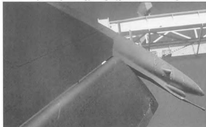
Антенна СРО-2М «Хром-Никель», смонтированная на киле этого МиГ-21ПФМ. Кроме того, виден приемник СОД-57М, который обычно был зеленым, а на этом музейном экземпляре - серебристый.
