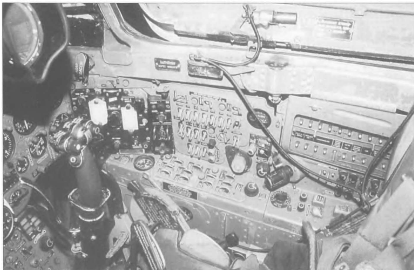
Система управления РП-21МА располагалась на правой консоли МиГ-21ПФМ. Черная панель впереди - это система управления АРК-10.
