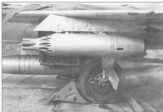
Подвеска УБ-16-57У на восточногерманском МиГ-21ПФМ, выставленном в Музее Техники в Шнейере. Этот блок отличался от УБ-16, который применялся на МиГ-21Ф-13. В блок УБ-16-57У использовались НАР С-5. На блоке красным написана инструкция на русском.
