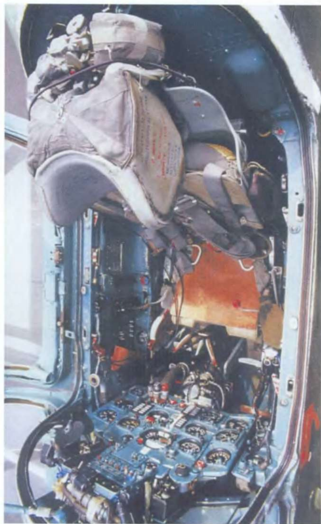
Инструкторское место МиГ-21УС было аналогичным по оснащению переднему. Каждая кабина имела собственный фонарь, который открывался вправо. Как правило внутри кабины МиГ-21УС красилась в голубой Pale Peacock Blue.
