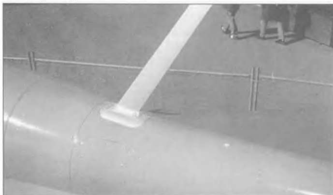
Как на МиГ-21ПФ, так и на МиГ-21ПФМ сверху фюзеляжа располагалась антенна радиостанции В-802В. На последующих модификациях антенна была заменена на фибростеклянную панель на киле.
