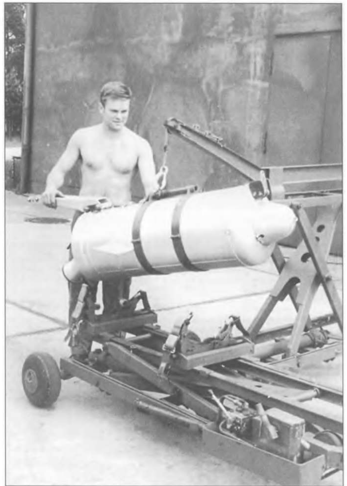
Восточногерманский техник транспортирует ракетный ускоритель СПРД-99 РАТО. МиГ-21ПФМ стал первым вариантом МиГ-21, который комплектовался такой системой. РАТО использовались только один раз и после этого возвращались в СССР для перезарядки.
