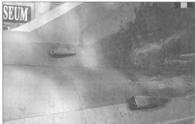
Слева на МиГ-21Ф-13 и МиГ-21ПФ монтировалась небольшой воздухозаборник для охлаждения аппаратуры. На самолетах третьего поколения его не было.
