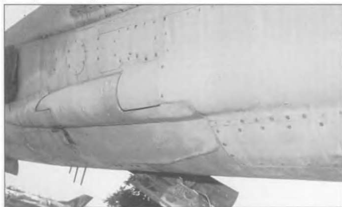
Хорошо видны отличия правого и левого щитков. Посредине смонтированы антенны СРО-2. Причем такая система монтировалась только на самолетах, предназначенных для СССР и стран Варшавского договора - на экспортных машинах ее демонтировали.
