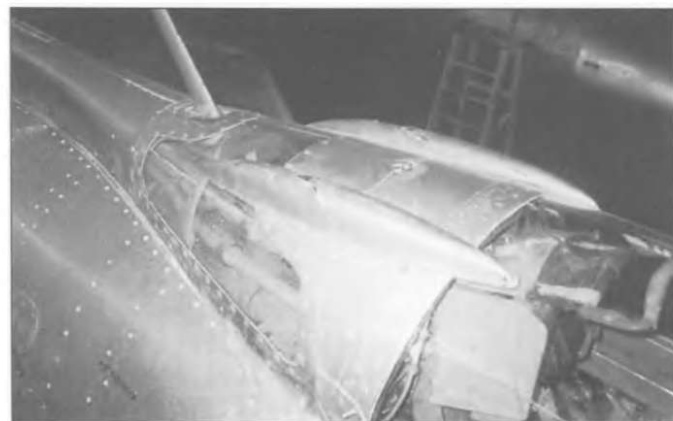
Вид на заднюю часть фонаря МиГ-21Ф. На чехословацких МиГ-21Ф-13 эти панели были защищены.
