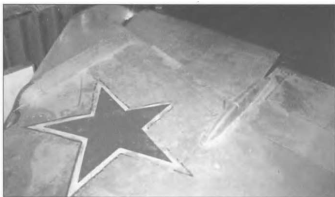
Правый элерон поднят вверх на этом МиГ-21Ф. Он идентичен МиГ-21Ф-13. Эти закрылки помогли контролировать самолет на скоростях от 0.8 до 1.2 Маха.
