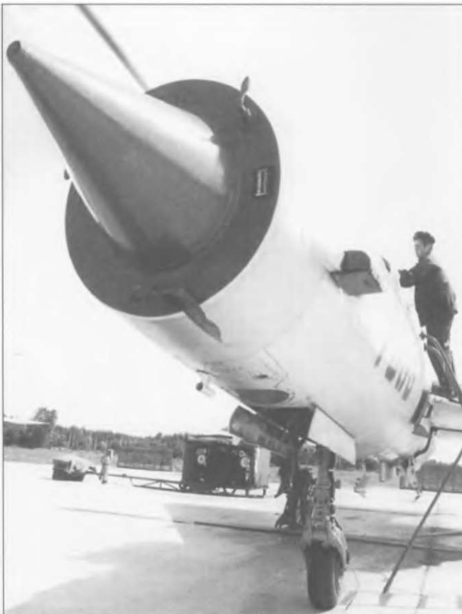
Обслуживание МиГ-21УМ («красный 7503») серийный 03695175) ВВС Польши. На самолете стоят все необходимые заглушки красного цвета. Кроме того, в носу стоит сенсор ДВА-3А, а также автопилот АП-155. Интересно, что на этой машине стоит температурный датчик СРД-5, что крайне нетипично для учебных машин. Все учебные машины располагали носовой стойкой с КТ-102 и основными - КТ-92.
