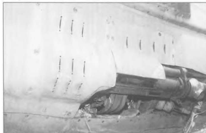
Сразу за механизмами НР-30 находилось устройство воздушных тормозов. Посреди пушечного механизма находился боекомплект. На НР-30, установленную на МиГ-21Ф-13 полагалось всего 30 снарядов.
