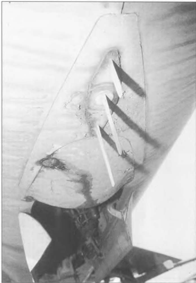
Как на МиГ-21ПФ, так и на МиГ-21ПФМ использовалась система СРО-2М «Хром-Никель». Антенна этой системы монтировалась сразу за передней стойкой шасси. Ранние модификации МиГ-21Ф\Ф-13 оснащались более ранней системой СРО-2 «Хром».
