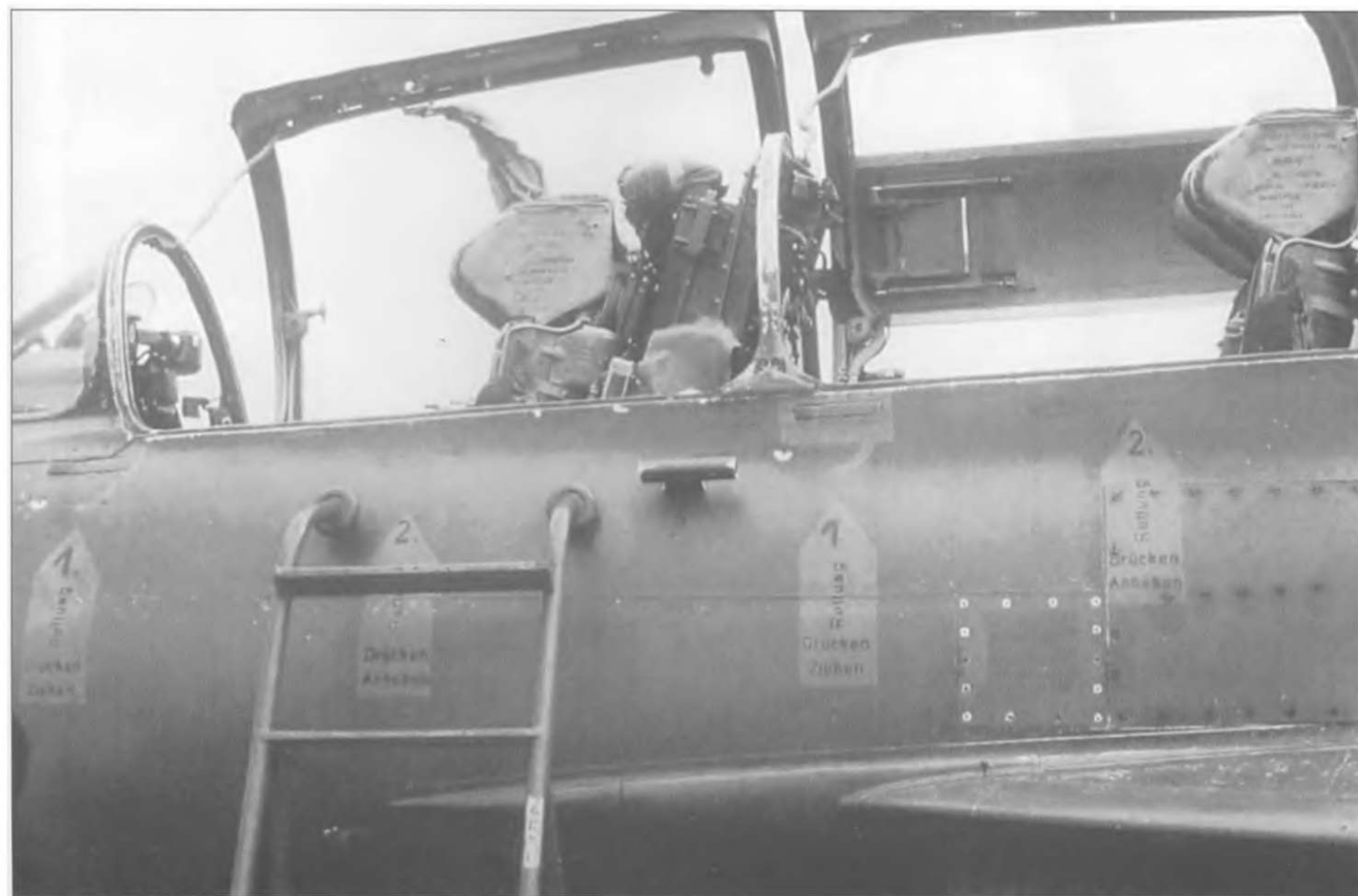
Трубка Вентури была важным элементом системы поддержания давления в кабине АД-6Е. Сама трубка была другой конструкции, чем на истребителе МиГ-21ПФМ. Оранжево-черные обозначения под кабиной предупреждали наземный персонал о наличии катапультных кресел.
