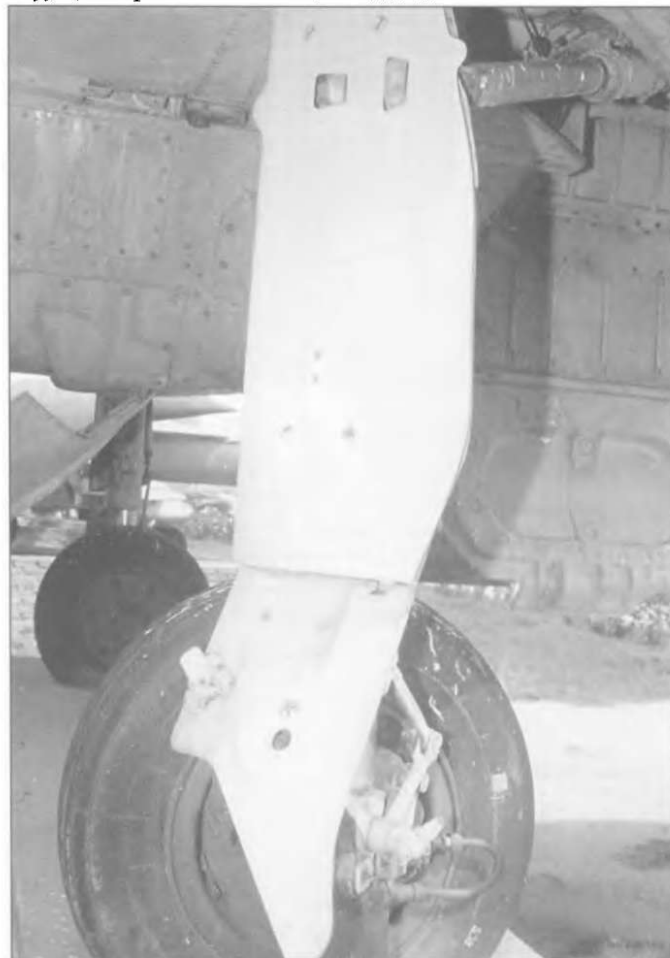
На основном шасси на МиГ-1Ф-13 стояло КТ-27 (колесо тормозное). Размер шины был 660 мм в диаметре и 200 мм в ширину. Тормоза стояли пневматические. Такой тип использовался только на МиГ-21Ф и МиГ-21Ф-13.
