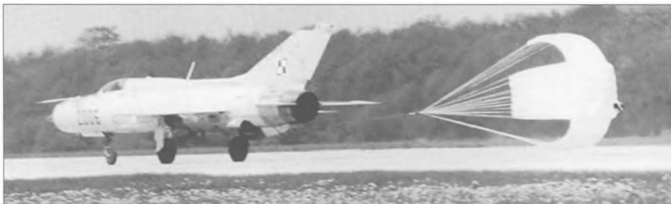
Посадка польского МиГ-21ПФ («красный 2006»/серийный 762006). С помощью тормозного парашюта посадочный путь сокращался до 400 метров.
