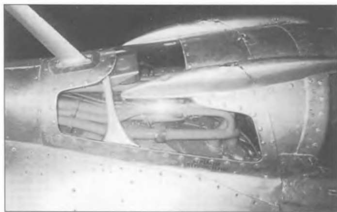
Желтые (предположительно FS33538) топливопроводы, хорошо видны за фонарем МиГ-21Ф. Хорошо видна антенна радио Р-802В. Такая конструкция характерна для ранних МиГ-21Ф-13, на поздних от нее отказались.
