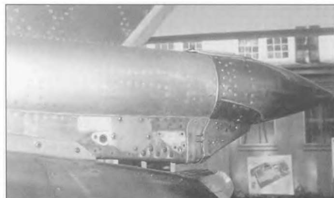
Контейнер тормозного парашюта ПТ-21УК, в котором располагался парашют площадью 19 М2. Парашют выпускался на максимальной скорости в 320 км\ч и когда самолет был на высоте 1 м над полосой. Полностью выпускался за 1.5 секунд. Такой контейнер также монтировался на МиГ-21ПФМ поздних серий.
