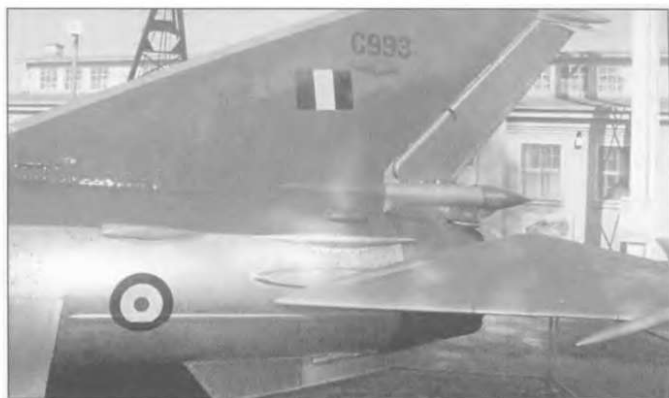
Киль МиГ-21ПФМ был больше чем на стандартном МиГ-21ПФ. Кроме того, контейнер тормозного парашюта ПТ-21УК был перенесен с задней левой части фюзеляжа в корневую часть кила.
