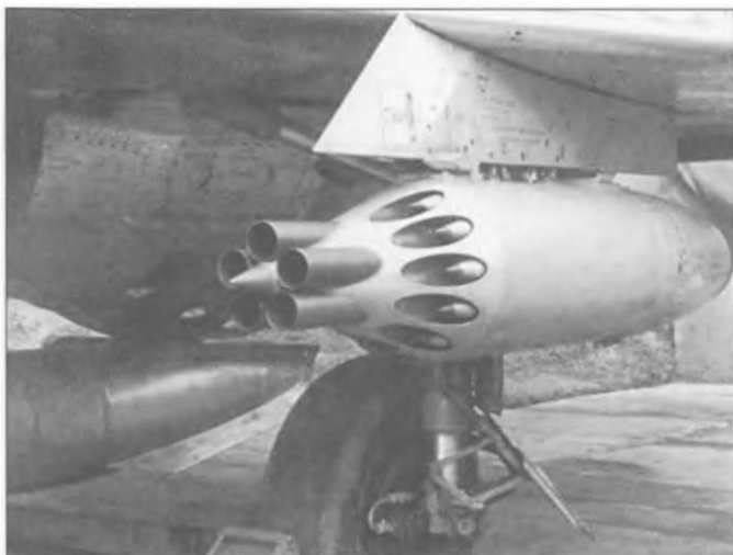
Блок НАР УБ-16-57У, подвешенный на пилон БДЗ-60-21Д. Под каждым крылом МиГ-21ПФМ было под два таких пилон, под которые можно было подвесить до 500 кг. Причем на них нельзя было подвесить дополнительные топливные баки.
