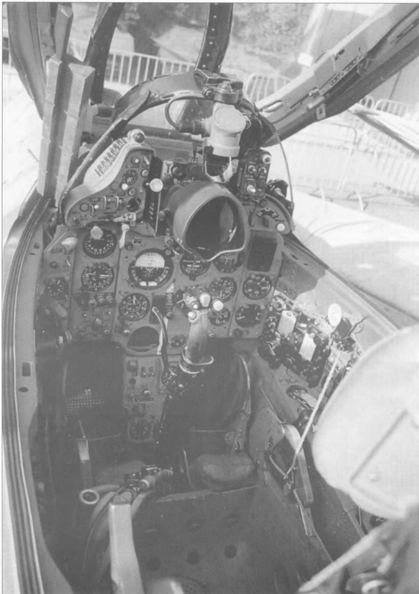
Прицел РЛС РП-21 в кабине МиГ-21ПФ. Сверху смонтирован прицел ПКИ-1. Остальная часть приборной доски аналогична МиГ-21Ф-13. Интерьер этого чехословацкого МиГ-21ПФ покрашен светло-голубым (Pale Peacock Blue (FS 25299)).
