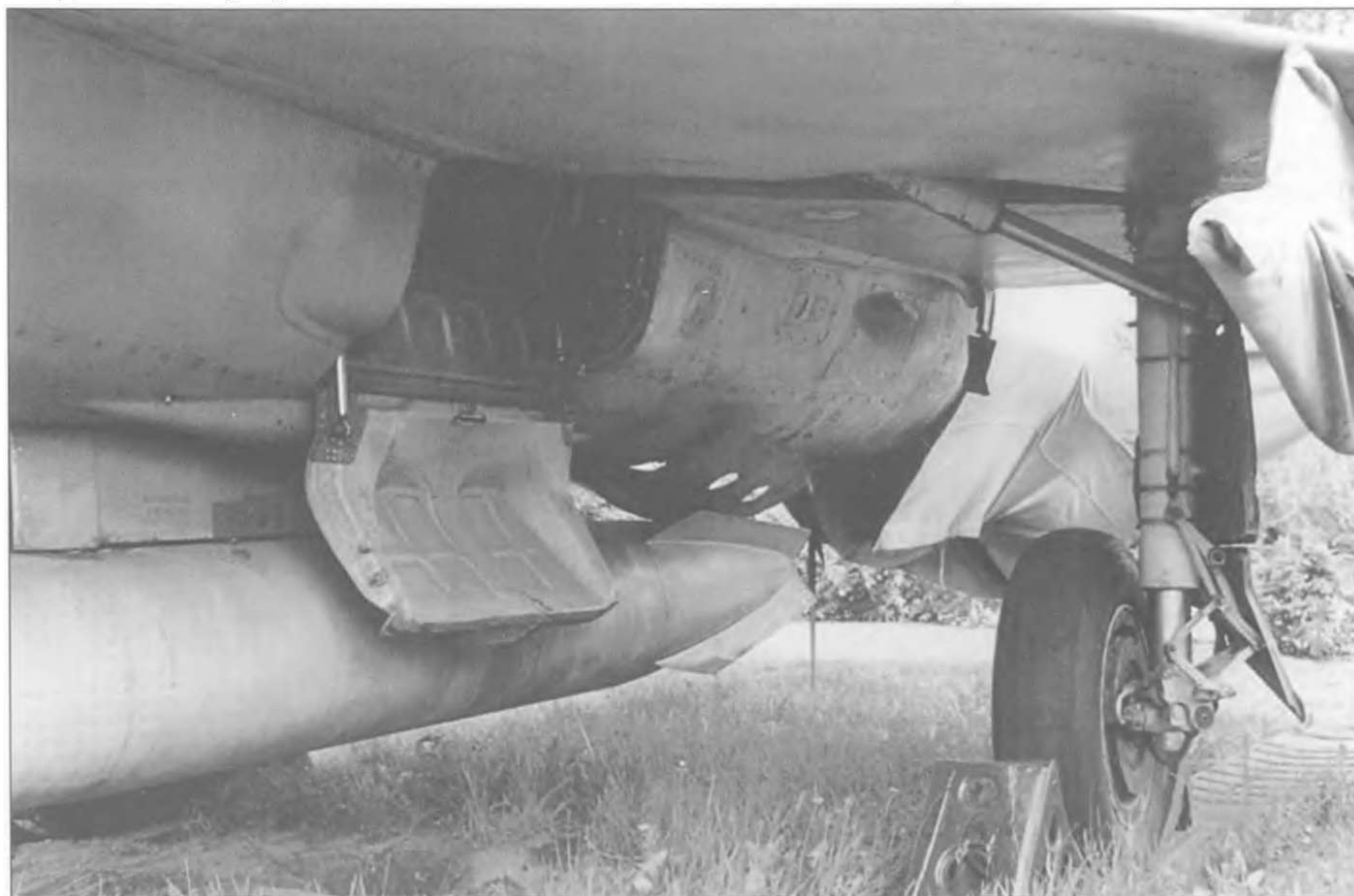
МиГ-21ПФ стал первым вариантом МиГ-21, на котором на основной стойки шасси стояло колесо КТ-92. Сама шина была большей - диаметром 800 мм и шириной в 200 мм. Увеличенное колесо потребовало увеличить глубину ниши. КТ-27, которое стояло на МиГ-21Ф-13 имело диаметр только 660 мм и ширину в 200 мм. Установка новой шины была обусловлена увеличением массы самолета - так, МиГ-21Ф-13 имел взлетную массу в 8625 кг, а МиГ-21ПФ - 8770 кг.
