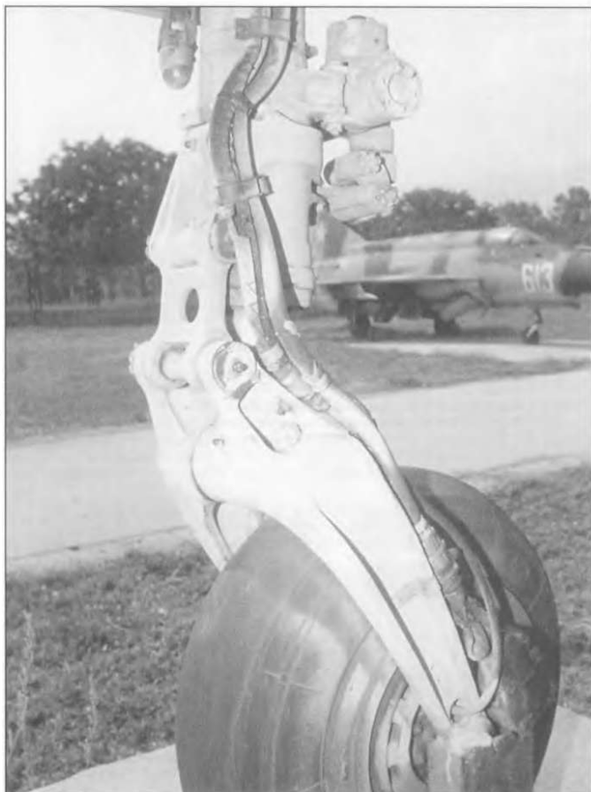
На КТ-38 монтировалось колесо диаметром 500 мм и шириной в 180 мм. Такие колеса стояли на МиГ-21Ф, МиГ-21Ф-13 и МиГ-21ПФ.
