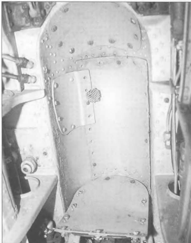
Носовая ниша на МиГ-21ПФ была значительно глубже чем на МиГ-21Ф-13. На фотографии хорошо видны кабели электрической системы как справа так и слева.
