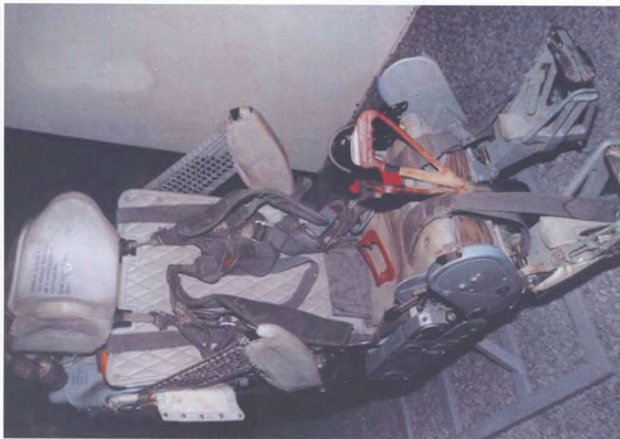
На катапультном кресле КМ-1 справа была смонтирована автоматическая система принудительного отделения. Она обеспечивала отделение пилота на безопасном от падающего самолета расстоянии. Обратите внимание на серебристую ручку ручной системы, которая была резервной на случай не срабатывания автоматической.
