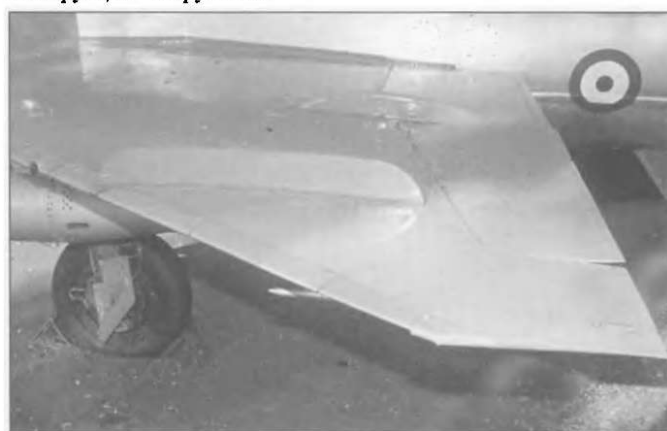
Треугольное крыло МиГ-21ПФМ имело только один аэродинамический гребень. В законцовке левого крыла стоял красный проблесковый огонь, в то время как в правом - зеленый. Хорошо виден закрылок.
