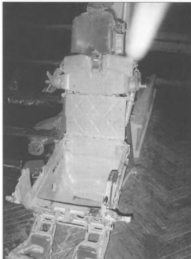
Как на МиГ-21Ф-13, так и на МиГ-21ПФ использовалось катапультное кресло СК. Однако применение этого кресла было возможно только с высоты 110 метров. Летчик приводил кресло в действие, дернув за красную ручку. Это активировало пиротехническую систему ПК-2М-1, которая запускала ракетный двигатель ТСМ-2500-38. Кресло СК было оснащено также временным прибором АД-3У и устройством отделения КАП-3, которое отделяло пилота через 1.5 секунды после катапультирования. Максимальная скорость, при которой летчик мог безопасно покинуть самолет - 1100 км/ч.
