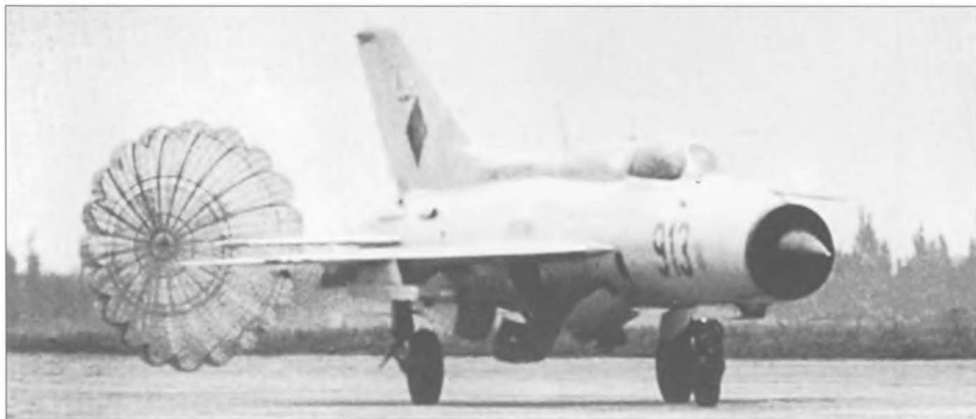
Посадка с помощью тормозного парашюта восточногерманского МиГ-21ПФ («красный 913» \ серийный 761114).
