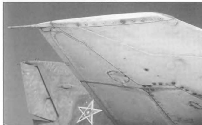
На законцовке кия МиГ-21Ф-13 монтировался антистатик. Он использовался для сбрасывания статического электричества во время полета.
