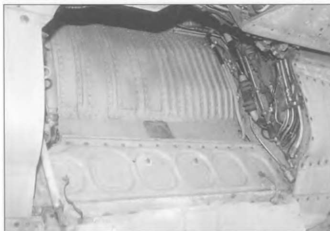
Различные провода и кабели прямо таки охватывают правую нишу уборок шасси. Кислородные шланги - голубые, черные - сжатый воздух, желтые - топливопроводы. Цветная маркировка сильно облегчала обслуживание самолета на земле.
