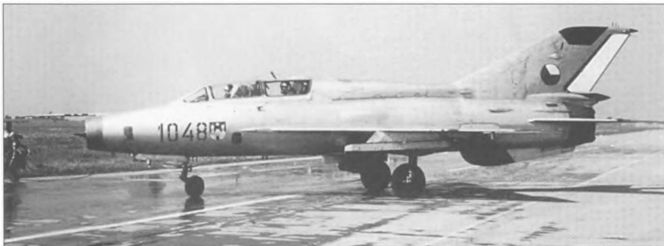
МиГ-21УС («черный 1048») 10685148) серийный ВВС Чехии. Инструкторское зеркало в поднятом состоянии. Сразу за номером эмблема 9-го авиаполка. Позднее самолет был списан.
